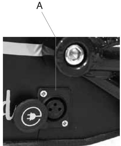
B. Conecte o cabo de alimentação a uma tomada de corrente elétrica. O indicador de bateria se iluminará a vermelho durante a carga e mudará a verde quando estiver completamente carregada.
