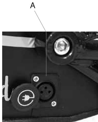
B. Conecte el otro extremo del cable de alimentación a una toma de corriente. El indicador luminoso se encenderá en color rojo durante la carga y cambiará a verde cuando esté completamente cargado.
