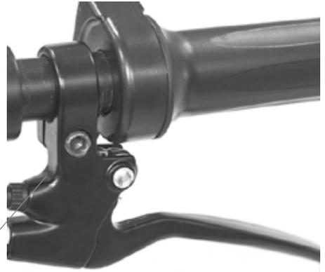
Zum Bremskabel anpassen, schrauben Sie die Schraube (B) von der hinteren Reife. Dies wird ein leichtes Drehen der Reifen ermöglichen, wenn Sie die Bremse nicht verwenden und eine ordnungsgemäße Bremsen bei der Aktivierung.
