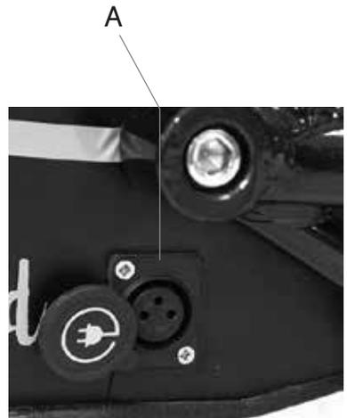
B. Stecken Sie das andere Kabelende zu einer Steckdose. Der Akkuanzeiger leuchtet beim Laden rot und grün, wenn der Akku vollständig aufgeladen ist.
