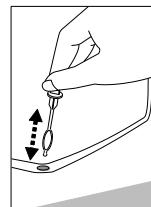
dispositivo e dal compressore. Per pulire usare una spazzola morbida, un panno elettrostatico o aspiratore.
