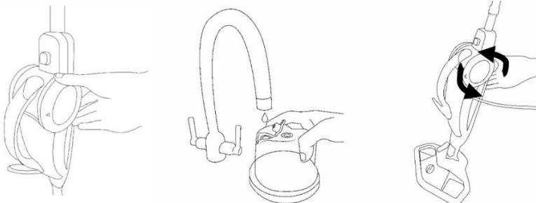
Izvucite spremnik za vodu iz glavnog tijela okretanjem bočnog panela i ulijte u njega vodu. Zatim pažljivo zatvorite spremnik i pričvrstite ga za tijelo parnog čistača okretanjem.
