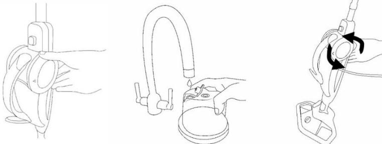
Forgassa el víztartály oldalsó részét és vegye ki a tartályt. Töltsé fel vízzel, zárja le és csavarja vissza a helyére. A víztartályba ne tegyen tisztítószereket, vegyi anyagokat vagy illatosítókat. A vízkörlerakódások megelőzéséért és a készülék élettartamának növeléséhez, javasoljuk, hogy használjon desztillált vizet. Ne töltse túl a tartályt.
