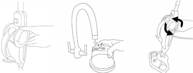
Odstranite posodo za vodo z glavnega ohišja tako, da zavrtite stransko ploščo in vanjo vlijete vodo. Nato previdno zaprite posodo za vodo in jo privijte nazaj v ohišje glave brisala.
