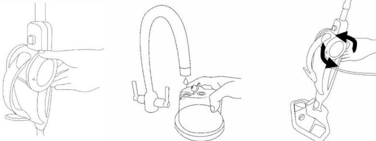
Vyjměte „Zásobník na vodu“ z hlavního těla otočením bočního dílu a nalejte do něj vodu. Poté „Zásobník na vodu“ pečlivě uzavřete a našroubujte jej zpět do těla parního mopu.
