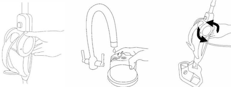
Vyberte „Zásobník na vodu“ z hlavného tela otočením bočného dielu a nalejte do neho vodu. Potom „Zásobník na vodu“ starostlivo uzavrite a naskrutkujte ho späť do tela parného mopu.
