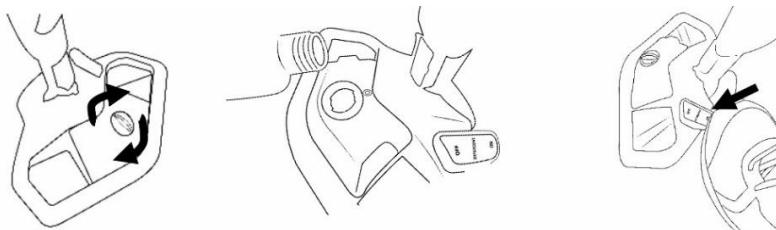
Podczas czyszczenia powierzchni zabrudzonej smarem, olejem itp. Można również dodać do gorącej pary efekt środka czyszczącego. Odkręć „Korek zbiornika roztworu czyszczącego”, wlać do niego roztwór czyszczący i ponownie zamknąć zbiornik. Naciśnij przycisk, aby spuścić roztwór czyszczący do pozycji ON.
