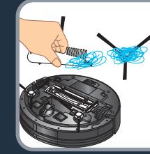
**RU** Чтобы очистить боковую щетку, разблокируйте ее, а затем снимите и очистите ее с помощью кисточки для очистки. Также прочистите труднодоступные места в отверстии боковой щетки. Очищайте боковые щетки один раз в месяц.
