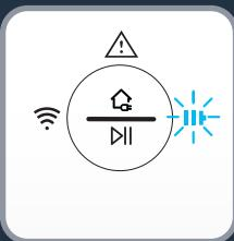
**RU** Поместите робот-пылесос на зарядную станцию: его контактные пластины должны касаться контактных пластин зарядной станции. После этого индикаторы аккумулятора начнут мигать.
