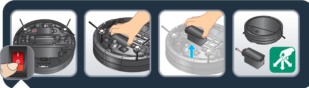
**RU** Внимание! Перед извлечением аккумулятора переверните робот-пылесос, чтобы выключить его и получить доступ к отсеку аккумулятора. Снимите крышку аккумулятора и отсоедините провод аккумулятора. Утилизируйте робот-пылесос и аккумулятор.
