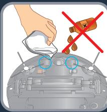
**RU** Чтобы очистить контактные пластины, выключите робот-пылесос и переверните его. Затем протрите пластины сухой тканью. Не протирайте маслом. Очищайте контактные пластины один раз в неделю.
