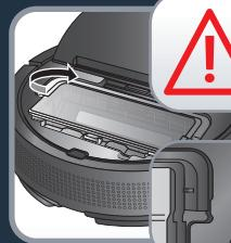
**RU** Чтобы опустошить пылесборник, откройте откидывающуюся крышку и вытащите пылесборник за ручку. Откройте крышку пылесборника сверху. Вытяните раму фильтра, чтобы снять гофрированный и поролоновый фильтры. Аккуратно постучите гофрированным фильтром по мусорному ведру, чтобы стряхнуть пыль. Не промывайте его водой.
