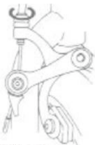
rys. 12b regulacja napięcia linki hamulca
