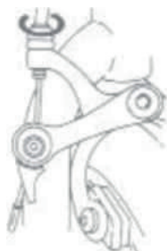
rys. 12b regulacja napięcia linki hamulca
