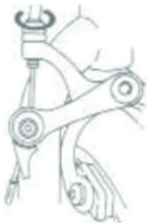
rys. 12b regulacja napięcia linki hamulca
