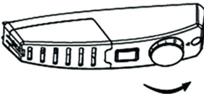
Csatlakoztassa a készüléket az elektromos hálózathoz! A belső hőmérséklet termosztáttal vezérelt – 8 beállítás lehetséges:
