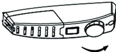
Podłącz urządzenie do gniazdka. Wewnętrzna temperatura jest kontrolowana termostatem. Istnieje 8 poziomów regulacji:
