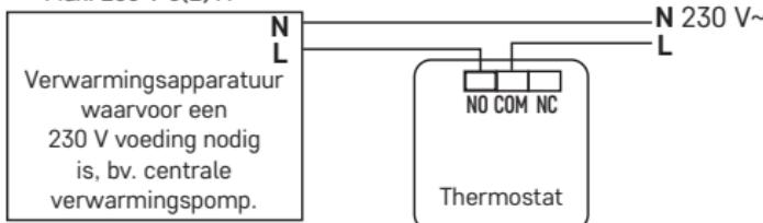
\* Als u een koelapparaat op de thermostaat aansluit, sluit u de fasedraad „L“ aan op de klem “NC”.
