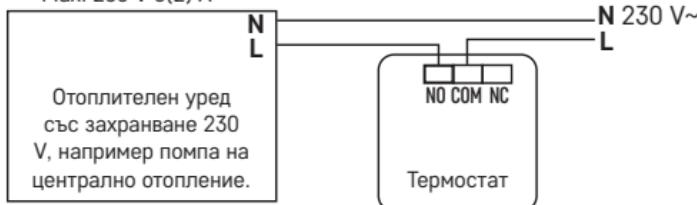
\* Когато свързвате охлаждащ уред към термостата, свържете фазовия проводник „L“ към клемата „NC“.
