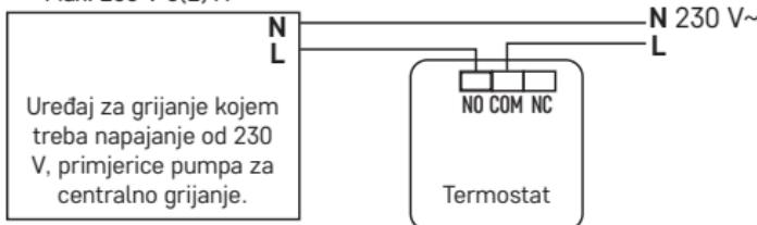
\* Prilikom priključivanja klima-uređaja na termostat, povežite fazu vodiča „L“ na priključak „NC“.
