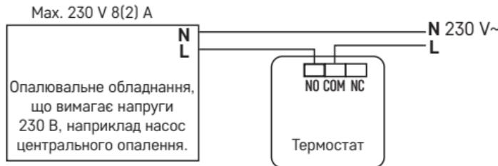
\* Якщо до термостата підключений блок охолодження, підключіть фазний провідник „L“ до клеми „NC“.
