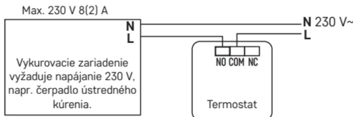
\* V prípade pripojenia chladiaceho zariadenia k termostatu pripojte fázový vodič „L“ do svorky „NC“.
