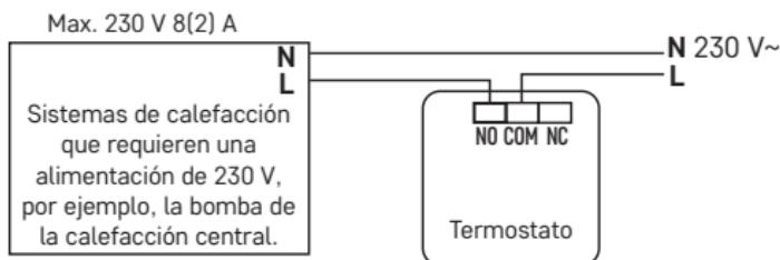
\* En caso de conexión del sistema de aire acondicionado al termostato conecte el cable de fase „L“ en el borne „NC“.
