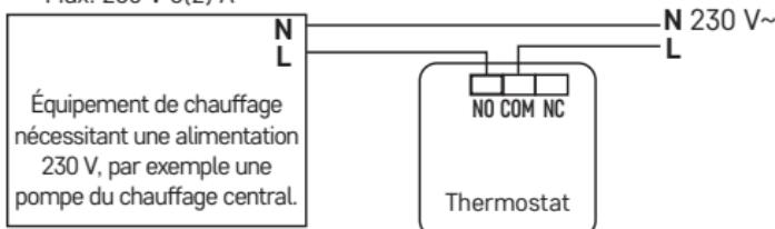
\* En cas de raccordement d'une installation de climatisation au thermostat, il conviendra de brancher le câble de phase „L“ sur la borne „NC“.
