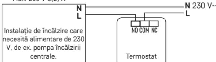
\* În cazul conectării dispozitivului de răcire la termostat, conectați conducerul de fază „L“ la borna „NC“.
