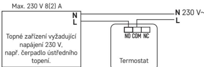
\* V případě připojení chladicího zařízení k termostatu připojte fázový vodič „L“ do svorky „NC“.
