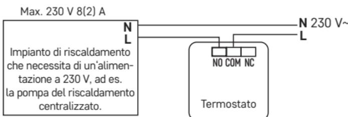
\* Quando si collega un'unità di raffreddamento al termostato, collegare il conduttore di fase „L“ al morsetto „NC“.
