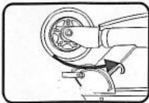
1. Odbezpiecz mechanizm blokujący.
