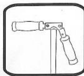
2. Выньте обе ручки из поперечной трубки руля.
