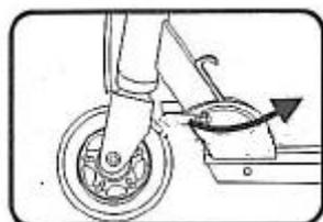
4. Зафиксируйте блокирующий механизм.
