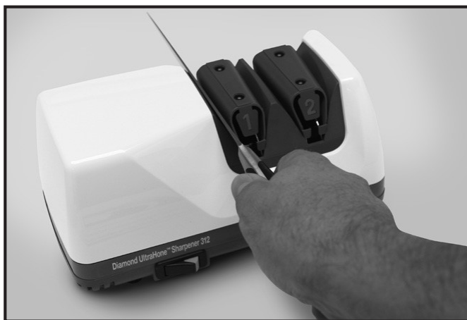
Rysunek 3. Etap 1 Wkładanie noża w szczelinę pomiędzy prowadnicę a sprężynę Naprzemienne przeciągnięcia w lewej i prawej szczelinie
