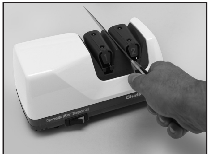
Rysunek 6. Wsuwanie noża w lewą szczelinę etapu 2. Naprzemiennie pojedyncze przeciągnięcia w lewej i prawej szczelinie.
