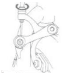
rys. 12b regulacja napięcia linki hamulca
