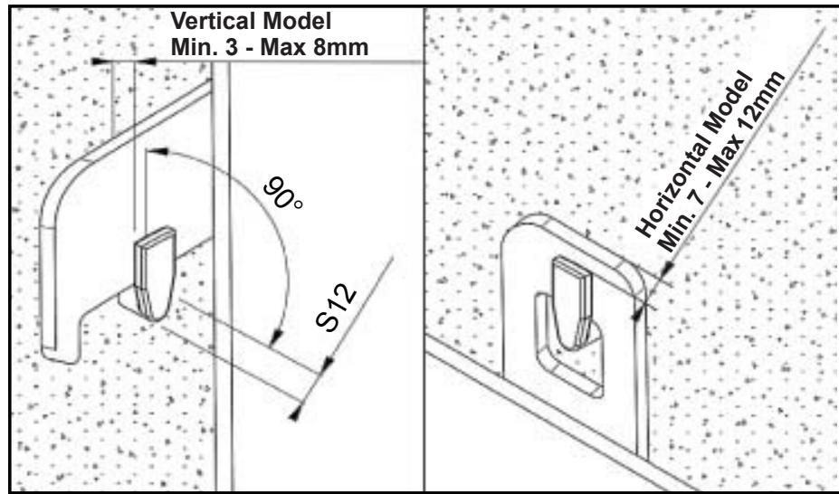
**Schema installazione-Installation scheme-Schéma d'installation-Esquema de instalacion-Esquema da instalacao
