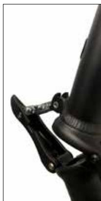
Obrócić wspornik kierownicy w kierunku dolnym.
