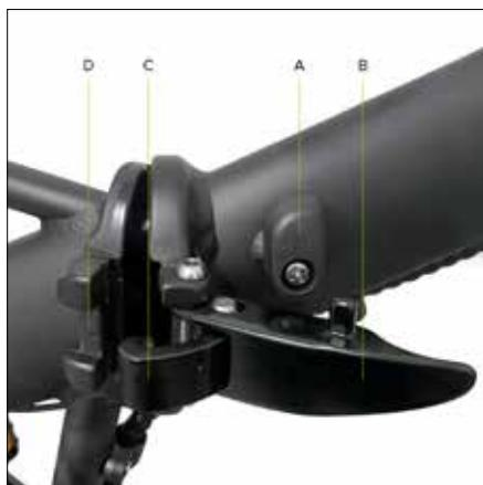
Otočte blokovacie zariadenie páky (A) v mechanizme otvárania/zatvárania rámu proti smeru hodinových ručičiek. Potiahnite páku (B) smerom von, až kým sa zaistovací hák (C) neodstráni zo svojho miesta (D).
