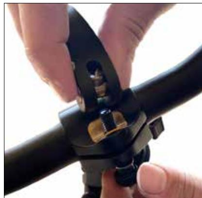
Proveďte zpětnou montáž předtím odstraněné upevňovací destičky v opačném sledu.
