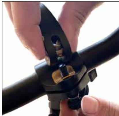
Proceder montar de nuevo la placa conexión manillar retirada antes en la secuencia inversa.
