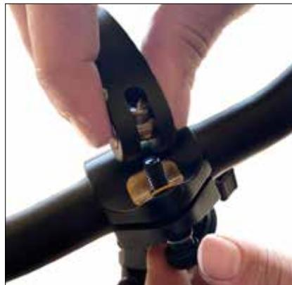
Ponownie zamontować wcześniej wyjątą płytke mostka kierownicy, wykonując czynności w odwrotnej kolejności.
