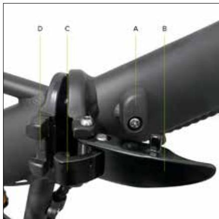
Draai de hendelvergrendeling (A) in het openings-/sluitmechanisme van het chassis linksom. Trek de hendel (B) naar buiten totdat de vergrendelingshaak (C) uit zijn zitting (D) kan worden verwijderd.
