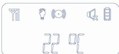
HØJ TEMP = Underenhed temperaturadvarsel
