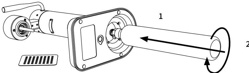
ガスボンベの先端からプラスチック製のシールを回して外し、底部の挿入口からAarkeカーボネーターへ丁寧に挿入します。ボンベを挿入口へ落とすようなことは避けてください。奥まで届いたら、ボンベがしっかりと締まるまで、時計回りに回します。きつめすぎないでください。シリンダーを固定するねじ山がつぶれる可能性があります。
