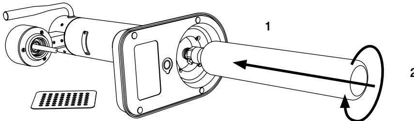
Odkręć plastikowe zamknięcie z górnej części naboju z gazem i ostrożnie wsuń nabój do saturatora Aarke przez otwór znajdujący się na spodzie. Nie upuszczaj naboju do otworu. Gdy poczujesz, że nabój dotyka końca komory, zacznij go wkręcać w kierunku zgodnym z ruchem wskazówek zegara do momentu przykręcenia. Uważaj, aby nie przykręcić naboju za mocno, ponieważ może to uszkodzić gwint otworu utrzymującego go na miejscu.
