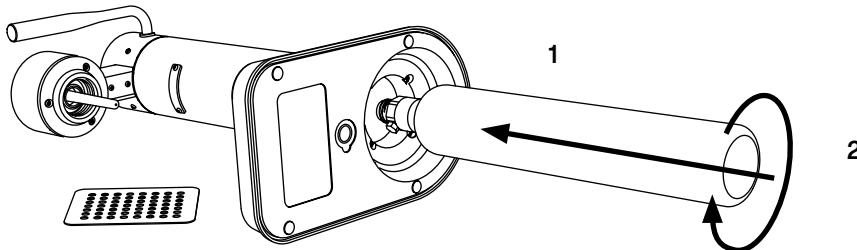
Draai de kunststof afdichting van de bovenkant van de gascilinder en plaats de cilinder voorzichtig via de opening in de onderzijde in de Aarke koolzuurmachine. Laat de cilinder niet in de opening vallen. Draai als u voelt dat de cilinder de bovenkant raakt de cilinder rechtsom vast. Schroef de cilinder niet al te stevig vast om beschadiging van de schroefdraad die de cilinder op zijn plaats houdt te voorkomen.
