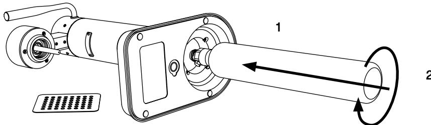
Отвинтите пластиковую крышку сверху газового баллона и осторожно вставьте его в Карбонатор Aarke через отверстие внизу. Не давайте цилинду упасть в отверстие, а медленно вводите внутрь, придерживая его. Когда вы почувствуете, что он упирается в верхнюю часть прибора начните ввинчивать цилиндр движением по часовой стрелке до тех пор, пока он не будет закреплен. Будьте осторожны и не закручивайте цилиндр слишком сильно, так как это может повредить резьбу, удерживающую цилиндр на месте.
