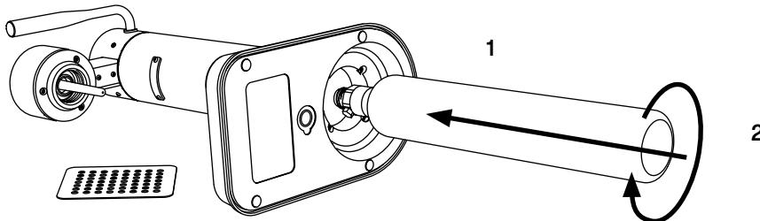
Dévissez le joint en plastique du haut du cylindre de gaz et insérez-le prudemment dans la Machine à gazéifier l'eau Aarke via le compartiment du dessous. Ne laissez pas tomber le cylindre dans le compartiment. Lorsque vous sentez qu'il atteint le haut, commencez à visser le cylindre dans le sens horaire jusqu'à ce qu'il soit fixé. Faites attention à ne pas serrer excessivement au risque de rompre le filetage de maintien du cylindre.
