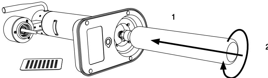
Afloje el plástico de cierre de la parte superior del cilindro. Introduzca minuciosamente el cilindro de gas en el gasificador Aarke a través del orificio en la parte inferior. No deje caer el cilindro en el orificio. Cuando sienta que toque la parte superior, comience a enroscar el cilindro hacia la derecha hasta que esté bien sujetado. No enrosque demasiado fuerte ya que esto podría romper los hilos de rosca que sostienen el cilindro de gas en su lugar.
