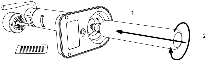
Schrauben Sie die Kunststoffdichtung von der Spitze des Gaszylinders ab und führen Sie den Zylinder vorsichtig durch das Loch im Boden in den Aarke Wassersprudler ein. Lassen Sie den Zylinder nicht in das Loch fallen. Wenn der Zylinder gegen die Oberseite stößt, schrauben Sie ihn im Uhrzeigersinn ein, bis er fest sitzt. Achten Sie darauf, ihn nicht zu fest einzuschrauben, um das Gewinde, das den Zylinder festhält, nicht zu beschädigen.
