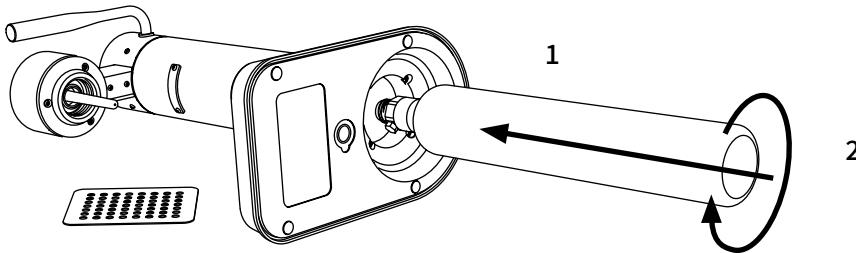
가스 실린더 상단의 플라스틱 씰을 해제한 후 하단의 구멍을 통해 아르케 카보네이터를 삽입하십시오. 실린더를 구멍으로 떨어뜨리면 안 됩니다. 상단에 닿았다면 실린더를 시계 방향으로 돌려 조여줍니다. 너무 꽉 조이면 실린더를 제자리에 고정하는 나사산이 파열될 수 있습니다.
