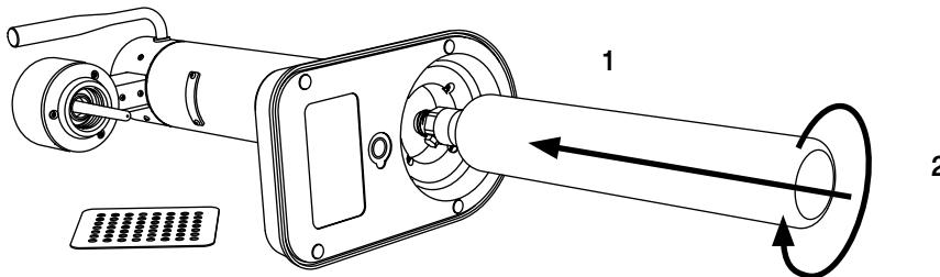
Svitare il sigillo di plastica dalla parte superiore della bombola del gas e inserirla con attenzione nel gasatore Aarke attraverso il foro posto sul fondo. Non far cadere la bombola nel foro. Quando si avverte che ha raggiunto la sommità, iniziare ad avvitare la bombola agendo in senso orario fino a fissarla. Prestare attenzione a non avvitare eccessivamente, in quanto ciò potrebbe danneggiare le filettature che tengono la bombola in posizione.
