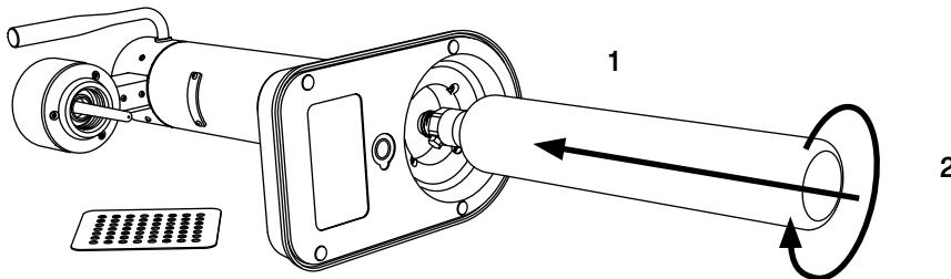
Skruta loss plasttätningen längst upp på kolsyrepatronen och för försiktigt in den i Aarke kolsyremaskin genom hålet i botten. Släpp inte patronen i hålet. När du känner att den når toppen, börja skruva patronen medsols tills den sitter fast. Se till att du inte skruvar in den för hårt eftersom det kan förstöra gängorna som håller patronen på plats.
