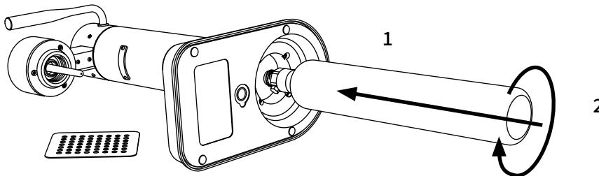
将塑料密封圈从气瓶顶部拧下，将气瓶从底部的孔小心插入 Aarke 气泡水机。请勿使气瓶坠入孔中。感觉气瓶到达顶部时，开始顺时针拧入气瓶直至紧固。小心不要过于拧紧，以免损坏固定气瓶的螺纹。
