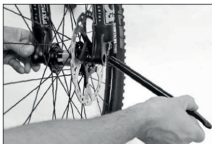
Wyciąganie sworznia przelotowego
