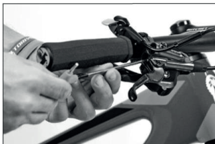
Regulacja odległości dźwigni hamulca
