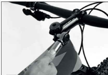
Ponownie dociągnąć dźwignie boczne wspornika kluczem dynamometrycznym.
