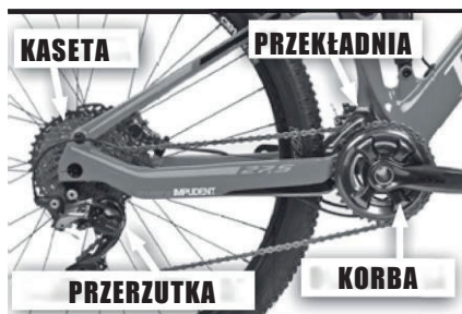
Układ napędowy z korbą, kaseta, przerezutką przednią i tylną.
