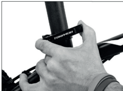
Aby ustawić wysokość siedziska, należy odkręcić śrubę zamknięcia sztycy podsiodłowej lub otworzyć szybkozamykacz.
