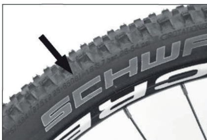
Wskazanie maksymalnego ciśnienia napompowania na boku opony.
