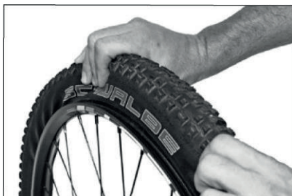
Wepchnij oponę w kierunku środka obręczy.
