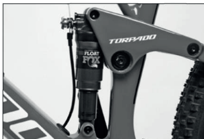
0-ring umieszczony w górnej części amortyzatora
