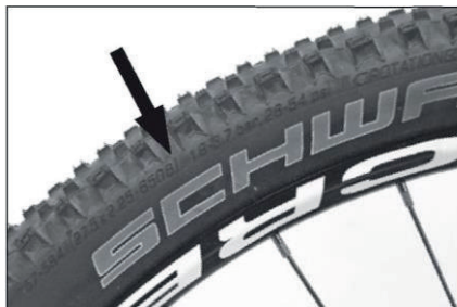
Wskazanie maksymalnego ciśnienia napompowania na boku opony.
