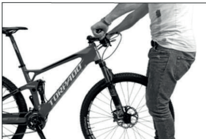
Spróbuj przesunąć kierownicę względem przedniego koła.
