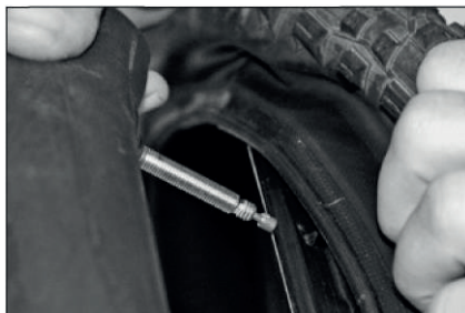
Włożyć wentyl do otworu obręczy.
