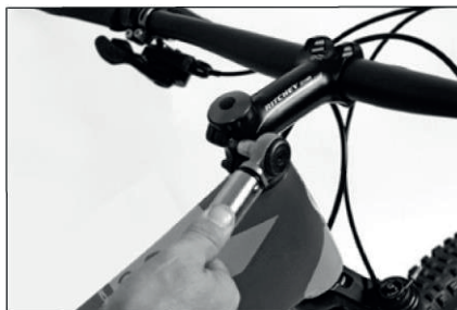
Po upadku należy sprawdzić i wymienić elementy ze stopów lekkich.
