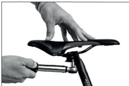
Dokręcać obie śruby stopniowo i naprzemiennie, nigdy nie przekraczając maksymalnego dopuszczalnego momentu obrotowego.
