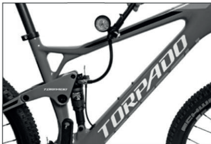
W przypadku amortyzatorów pneumatycznych należy dostosować ciśnienie powietrza.
