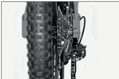
Przesuń łańcuch na najmniejszą zębatkę.
