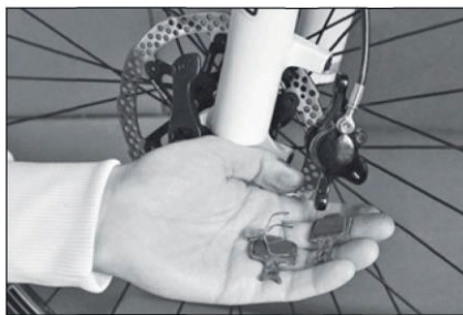
Wymienić zużyte klocki hamulcowe
