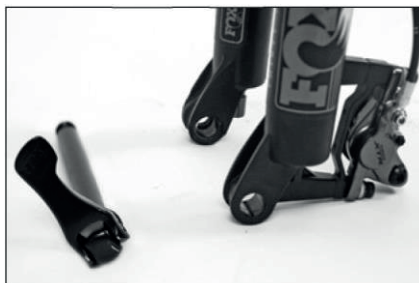
System z osią piasty przelotowej 15 mm
