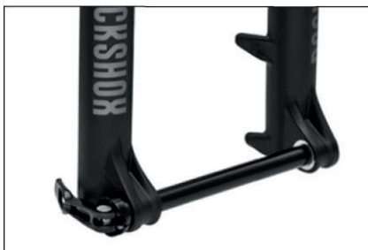
Oś piasty przelotowych Maxle (widelec Rockshox)
