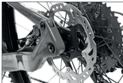
System z osią piasty przelotowej 12 mm
