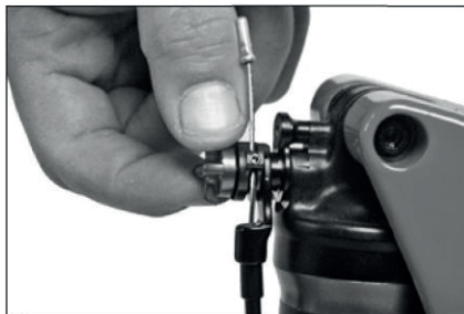
Amortyzacja jest regulowana za pomocą pokrętki regulacyjnego.
