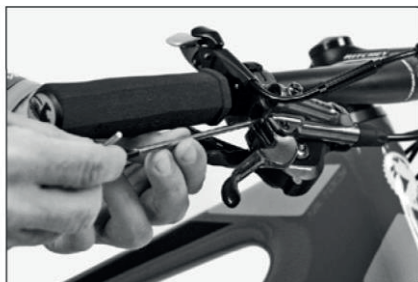
Ustawianie odległości dźwigni hamulca kierownicy
