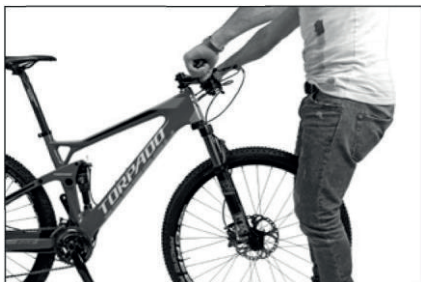
Spróbuj przesunąć kierownicę względem przedniego koła.
