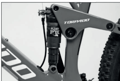
Przesunięcie 0-ringa na amortyzatorze wskazuje zastosowany skok.
