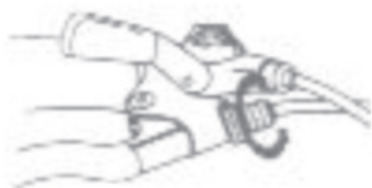
rys. 12a regulacja napięcia linki hamulca
