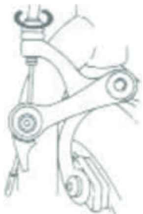
rys. 12b regulacja napięcia linki hamulca
