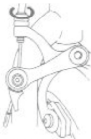
rys. 12b regulacja napięcia linki hamulca
