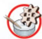
ENG Wax the part with a regular candle (rub with a candle). UKR Змастіть деталь звичайною свічкою (потрій об свічку). FRA Lubrifiez la pièce avec une bougie ordinaire (frottez contre la bougie). DEU Reiben Sie das Teil mit einer einfachen Kerze etwas ein. ITA Incerare il componente (Sfregare con la cera). JAP 表示された部分に潤滑剤としてロウソクを塗ってください。CHI 用普通蜡烛涂抹润滑部件。SPA Engrase la pieza con una vela común (frote con una vela). RUS Смажьте деталь обычной свечкой (потрите о свечку).
