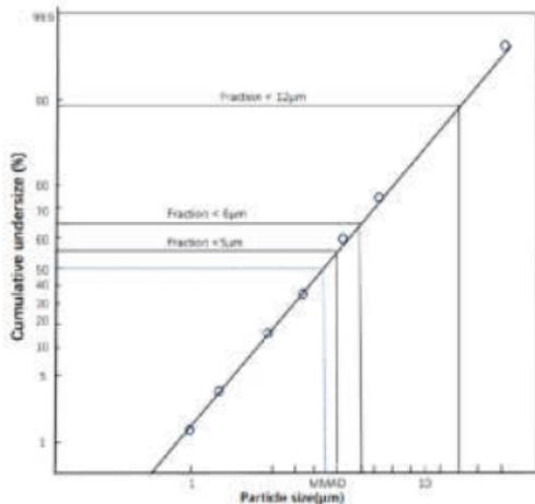
Die Messungen wurden mit einer Salbutamol-Lösung mit einem „Next Generation Impactor“ (NGI) durchgeführt.
