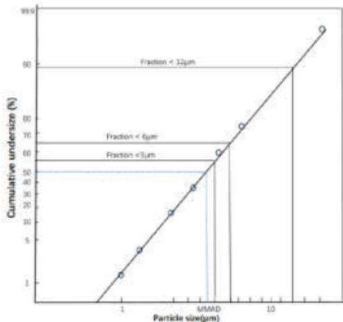
Les mesures ont été effectuées avec une solution de fluorure de salbutamol avec un NGI (Next Generation Impactor).
