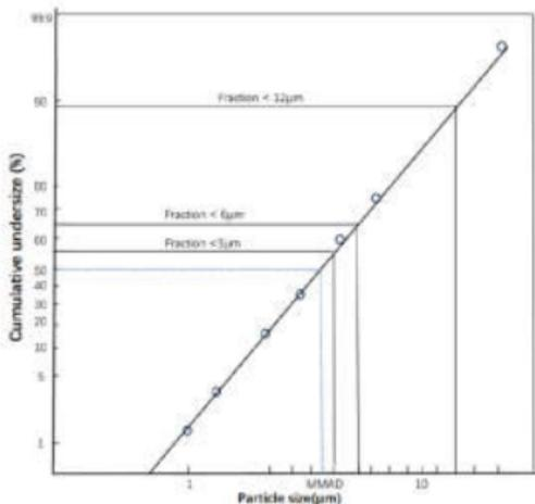
De metingen zijn verricht met een salbutamoloplossing met een 'Next Generation Impactor' (NGI). Het diagram is mogelijk niet van toepassing op suspensies of zeer viskeuze medicijnen. Meer informatie hierover kunt u opvragen bij de fabrikant van het betreffende medicijn. Aerosolwaarden zijn gebaseerd op ademhalingspatronen van volwassenen en variëren waarschijnlijk voor kinderen.
