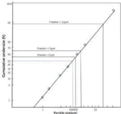
Pomiary zostały przeprowadzone przy użyciu roztworu salbutamolu oraz urządzenia „Next Generation Impactor” (NGI).
