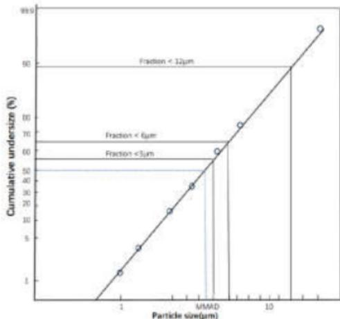
Målingene er gjennomført med en natriumklorid-løsning med en "Next Generation Impactor" (NGI). Diagrammet kan derfor muligens ikke anvendes på suspensjoner eller svært seigtflytende medikamenter. Du får nærmere informasjon om dette hos produsenten av medikamentet. Aerosolverdier er basert på pustemønstre hos voksne og kan avvike for barn og småbarn.
