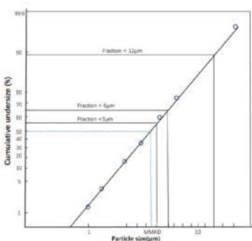
Le misurazioni sono state eseguite con una soluzione di cloruro di sodio e un "Next Generation Impactor" (NGI).
