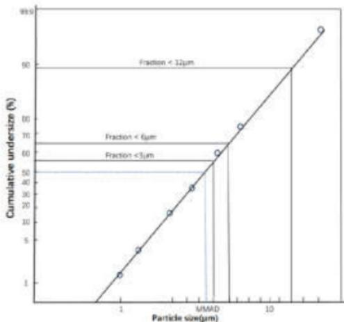
Измерения производились с использованием раствора сальбутамола при помощи импактора нового поколения Next Generation Impactor (NGI).
