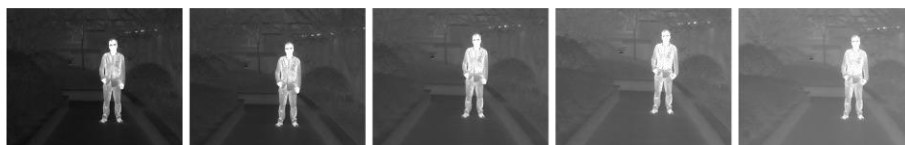
Rysunek 3-1 Dostosowanie jasności w trybie wyróżniania wyższych temperatur białym kolorem
