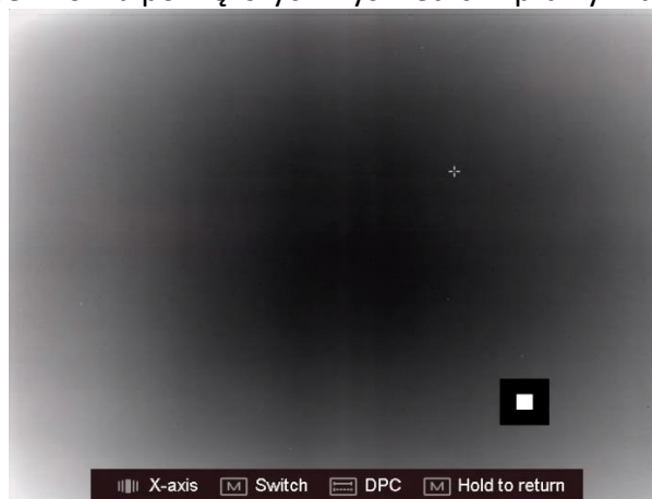
Rysunek 3-2 Korekcja wadliwych pikseli
