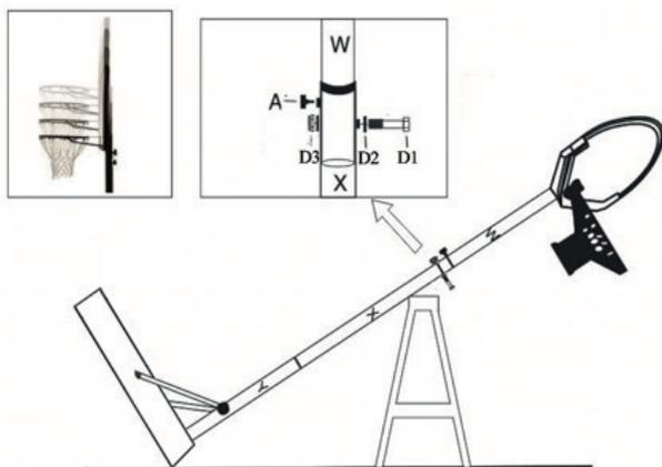
Włóż górną rurę (W) do środkowej części rury (X), wyreguluj wysokość i załóż śruby z plastikowym pokrętkiem A. Następnie użyj śrub D1, D2 i D3. Wysokość można regulować poprzez zmianę montażu śrub w odpowiednich otworach
