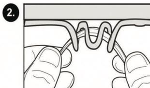
Montage des Netzes (J) an dem Korbring (I) nach dem unten stehenden Abbildung.
