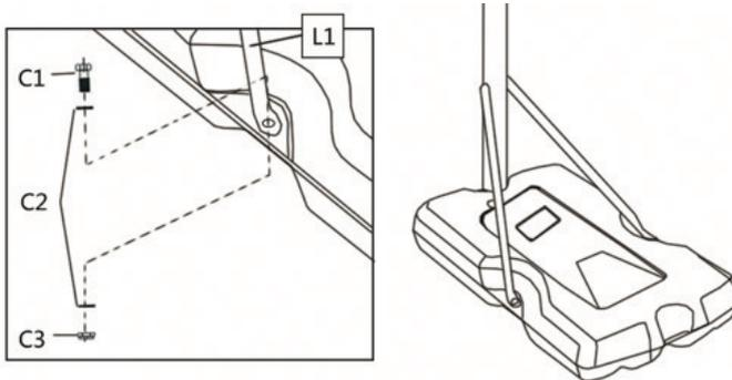
Verbinden Sie die Diagonalstreben (L1 und L2) mit dem Standfuß mittels Schrauben C1, C2 und C3, wie es auf der Abbildung dargestellt ist.
