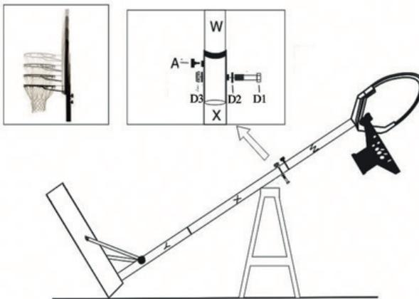
Schieben Sie das obere Rohr (W) in das mittlere Rohr (X). Stellen Sie die Höhe ein und sichern Sie die Konstruktion mit dem Drehknopf (A). Benutzen Sie dann die Schrauben D1, D2 und D3. Die Höhe kann man durch Änderung der Position des Drehknopfs in die entsprechenden Löcher einstellen.
