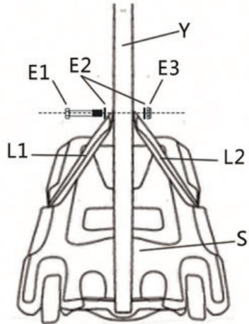
Verbinden Sie die Diagonalstreben (L1 und L2) mit dem unteren Teil des Rohrs (Y) mittels Schrauben E1, E2 und E3, wie es auf der Abbildung dargestellt ist.
