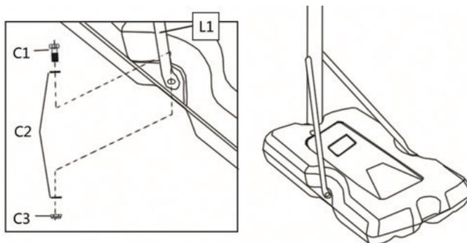
Połącz dolną część prętów L1 i L2 z podstawą używając zestawu śrub C1, C2 i C3.
