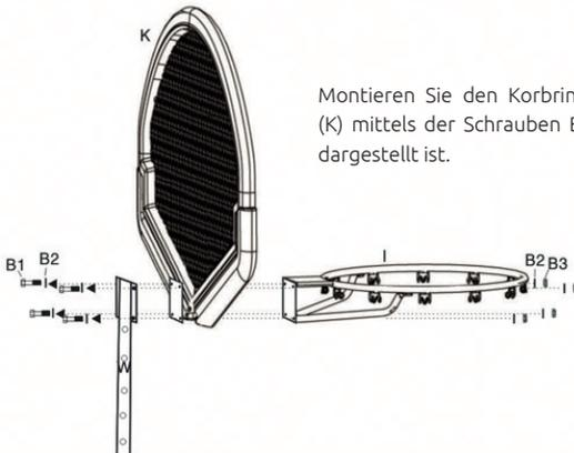
Montieren Sie den Korbring (I) und das obere Rohr (W) am Brett (K) mittels der Schrauben B1, B2 und B3, wie es auf der Abbildung dargestellt ist.
