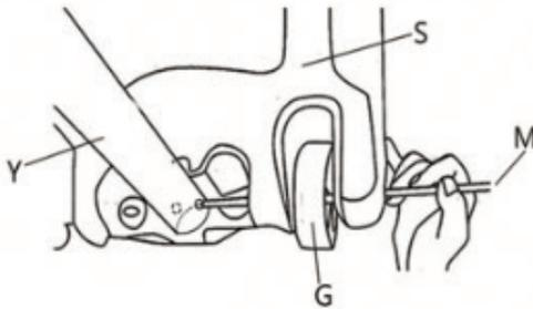
Schieben Sie die Achse (M) durch die Räder (G) und den Standfuß (S), wie es auf der Abbildung dargestellt ist.
