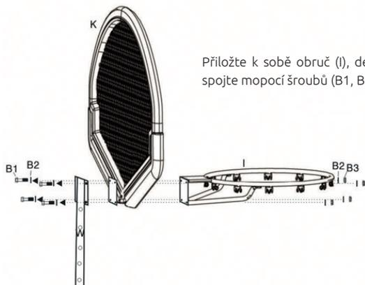
Přiložte k sobě obruč (I), desku (K) a horní trubku (W) a díly k sobě spojte pomocí šroubů (B1, B2, B3).
