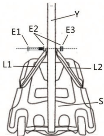
Połącz pręty L1 i L2 z dolną częścią rury Y używając śrub E1, E2 i E3 jak na rysunku.
