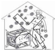
Nigdy nie używaj agregatu w pomieszczeniach zamkniętych.
