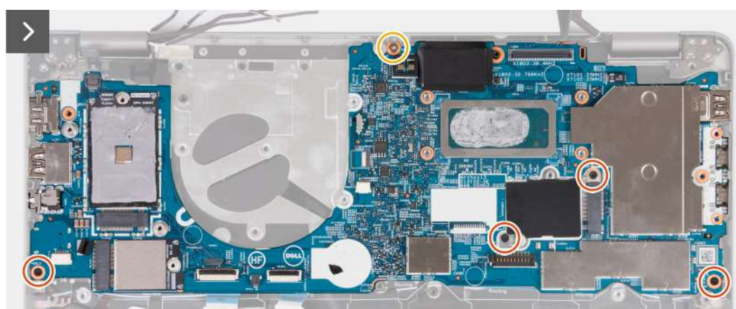
Rysunek 6. Wymontowywanie płyty głównej
