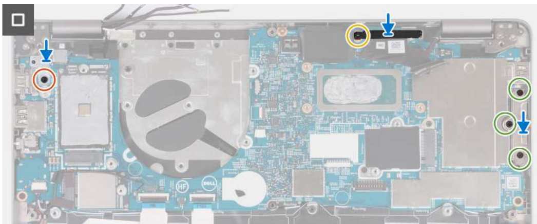
Rysunek 11. Instalowanie płyty głównej
