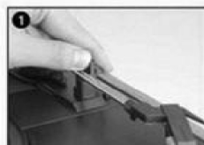
1 Naciśnij blokadę ramienia, by zwolnić ramię gramofonu.
