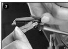
3 Delikatnie wyjmij wkładkę gramofonową z gniazda.
