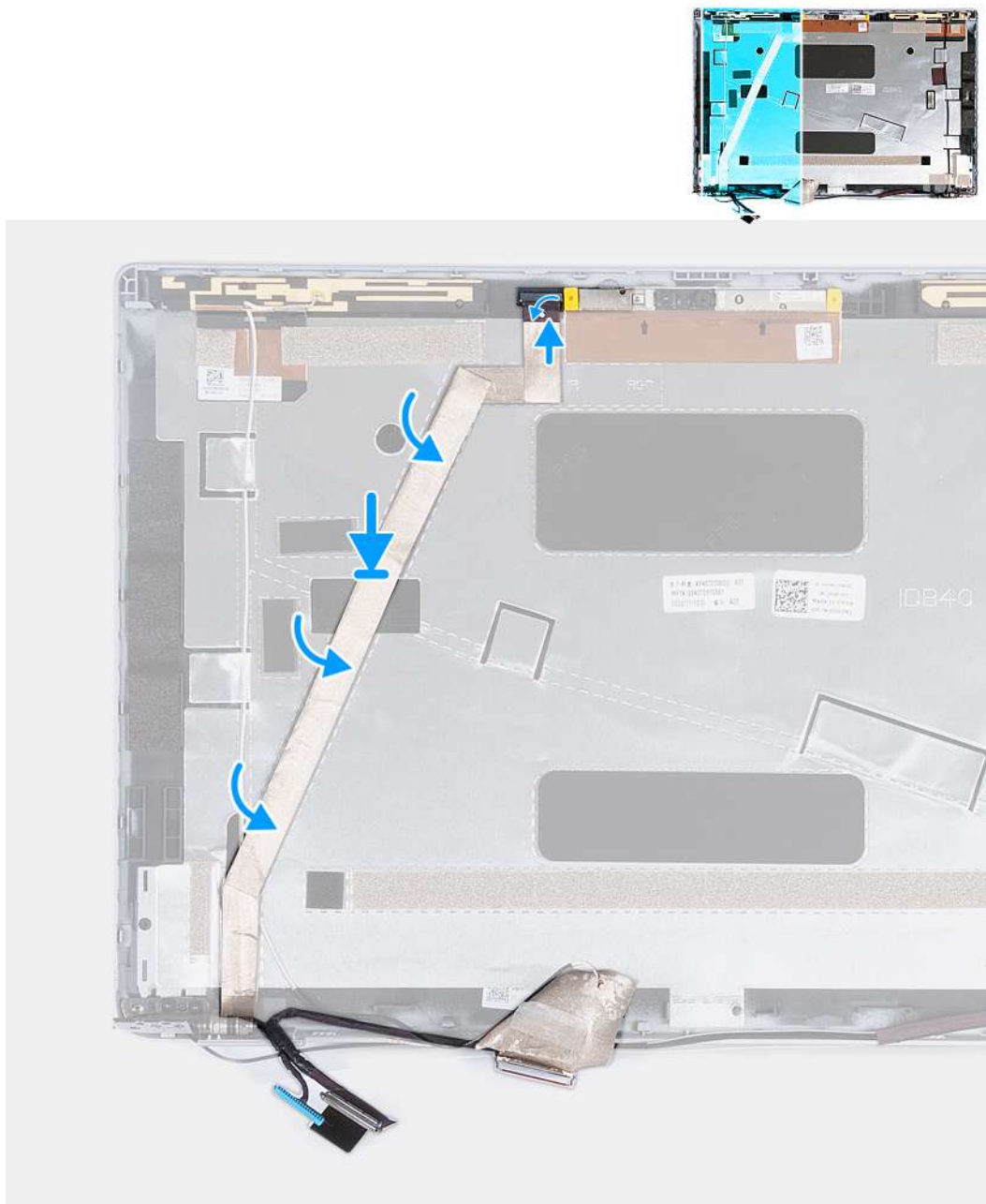
Rysunek 52. Instalowanie kabla wyświetlacza
