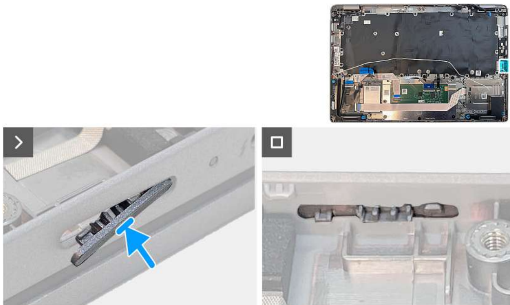
Rysunek 70. Instalowanie zaślepki gniazda karty SIM
