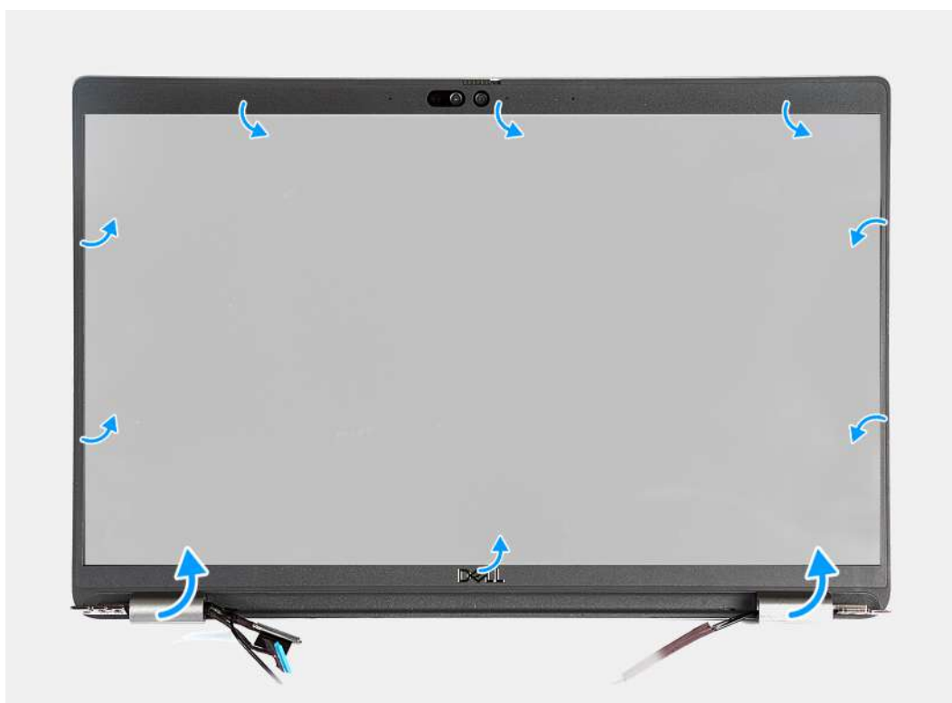
Rysunek 43. Wymontowywanie ramki wyświetlacza
