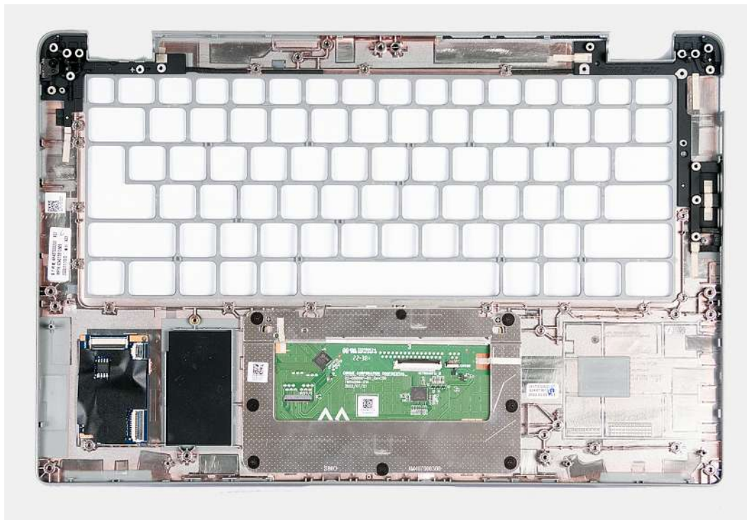
Rysunek 67. Wymontowywanie zestawu podpórki na nadgarstek
