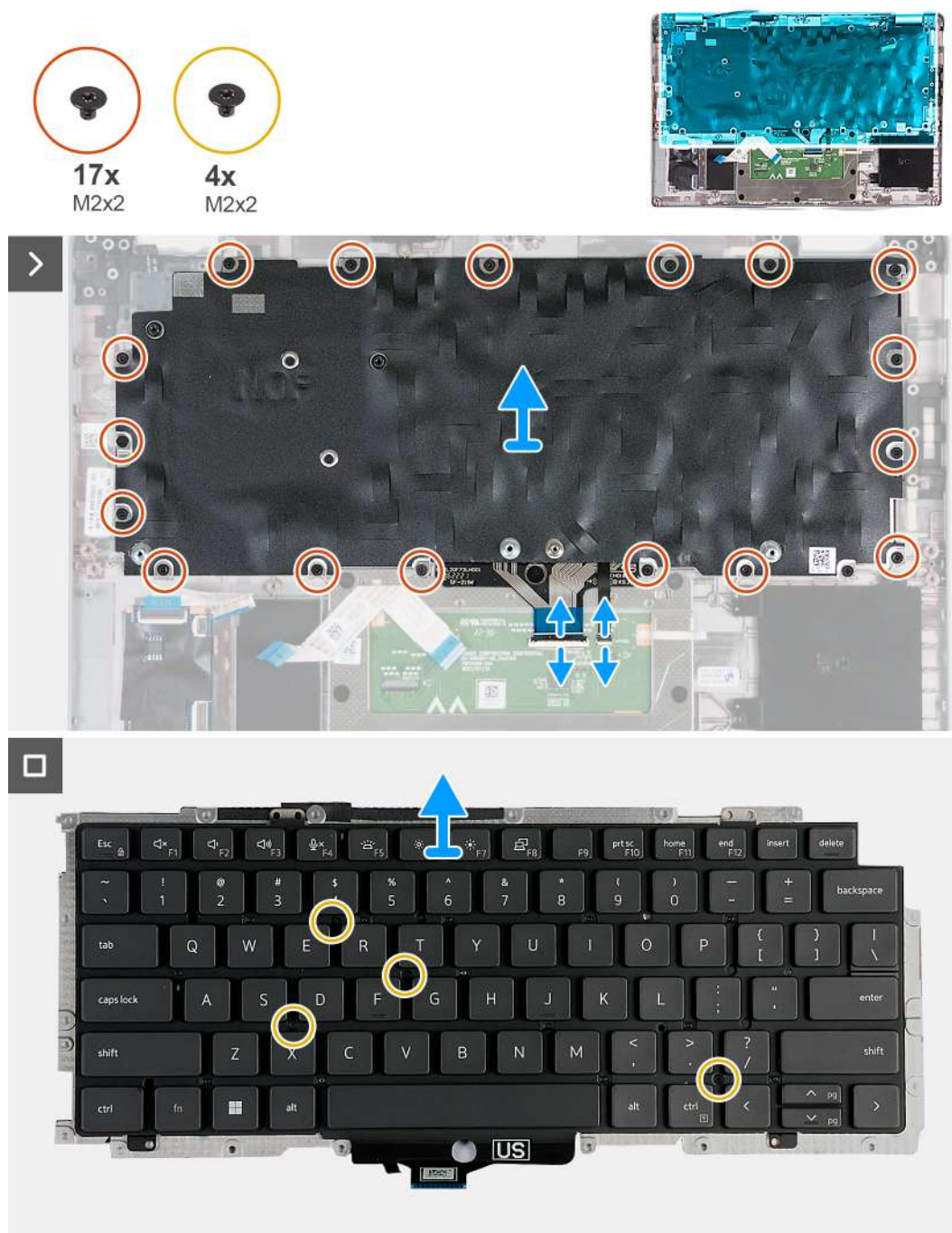
Rysunek 65. Wymontowywanie klawiatury
