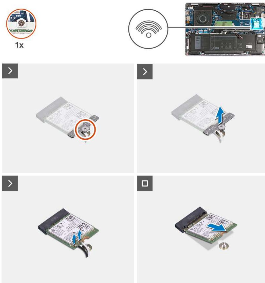
Rysunek 12. Wymontowywanie karty sieci bezprzewodowej
