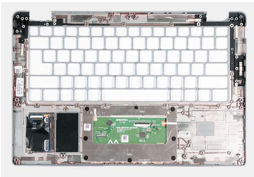
Rysunek 68. Instalowanie zestawu podpórki na nadgarstek
