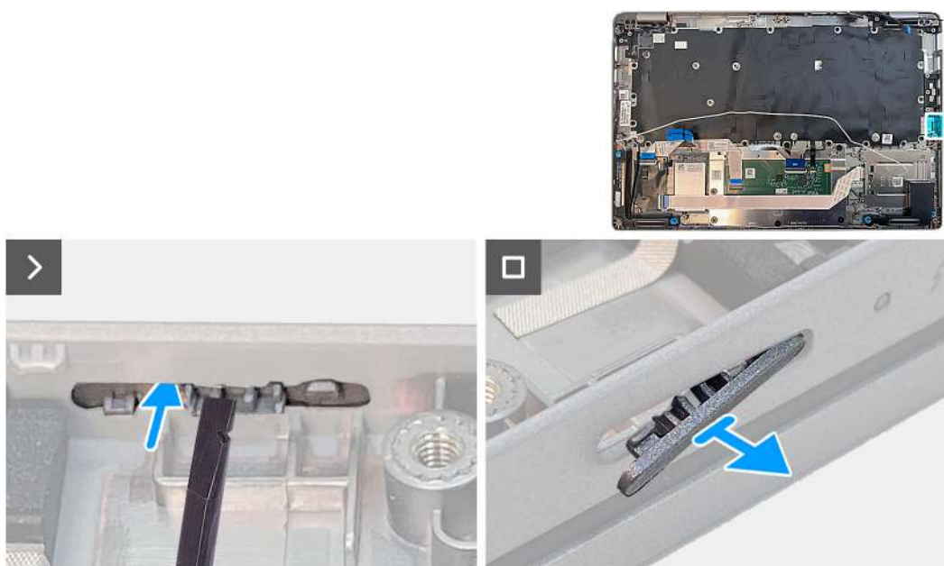
Rysunek 69. Wymontowywanie zaślepki gniazda karty SIM
