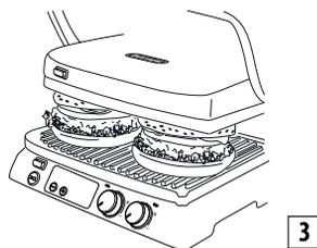
De groeven in de plaat en de opening aan de achterkant van het apparaat zorgen ervoor dat het vet uit het voedsel wordt afgevoerd en in een speciale bak wordt opgevangen.
