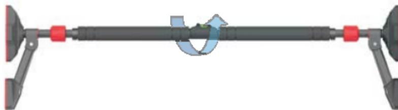
6. Wciśnij elementy mocujące do wewnętrz, aby zamocować poziomą listwę i zakończyć instalację..
