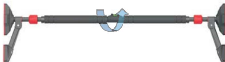
6. Drücken Sie die Befestigungselemente nach innen, um das Produkt zu fixieren und die Montage abzuschließen.
