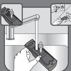
**ES** Llene el depósito de agua con el 100% de agua y repita la operación hasta que el depósito de agua se haya vaciado por completo con el fin de enjuagar el aparato.
