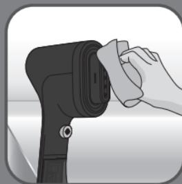
پد\* را از دستگاه جدا کنید. قسمت های پلاستیکی دستگاه را با پارچه خشک تمیز کنید. از هیچ مایع شوینده ای استفاده نکنید.
