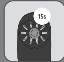
**DA** Vent mindst 15 sekunder, før du trykker på damp-knappen. Lysindikatoren slukker, når den er klar.
