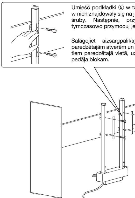
Umieśc podkladki ⑤ w taki sposób, aby otwory w nich znajdowały się na jednej linii z otworami na śruby. Następnie, przytrzymując podkladki, tymczasowo przymocuj je do modułu pedałów.
