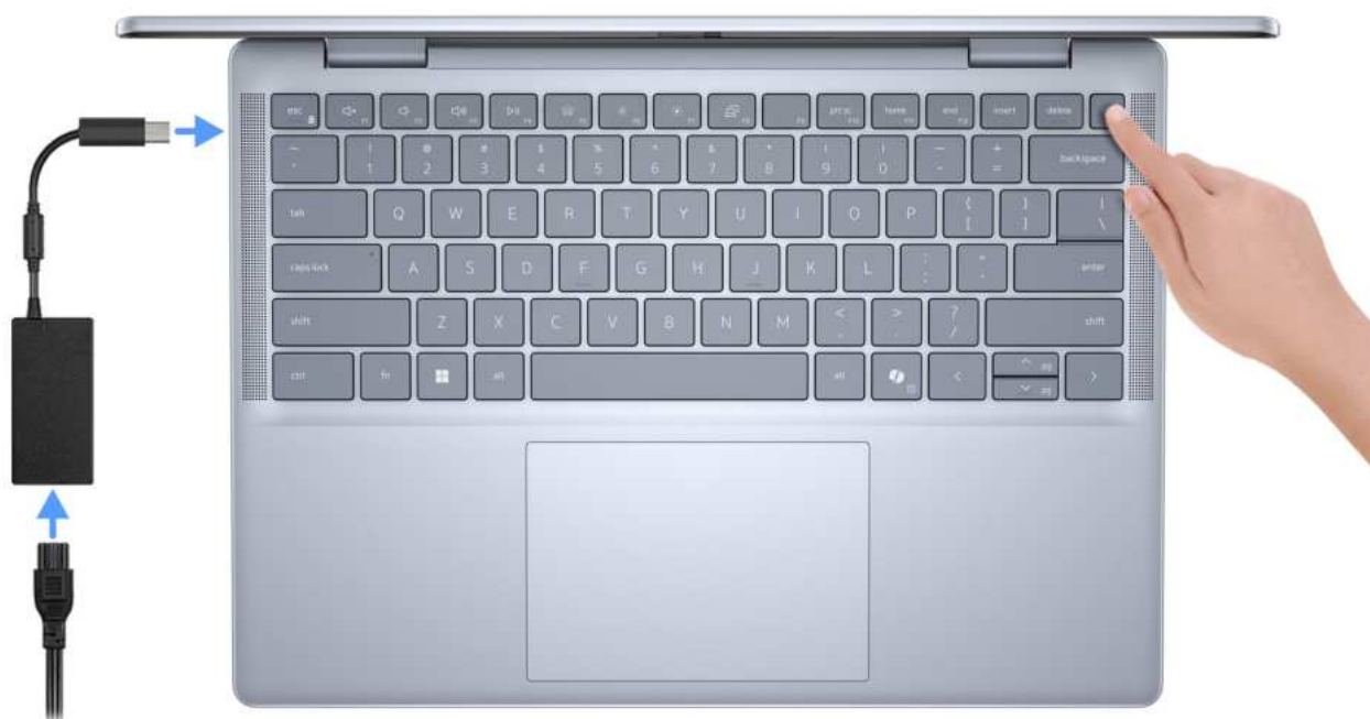
Rysunek 8. Podłącz zasilacz i naciśnij przycisk zasilania
