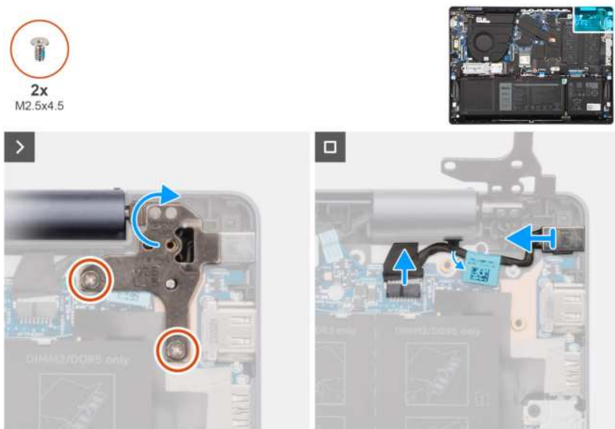
Rysunek 50. Wymontowywanie gniazda zasilacza
