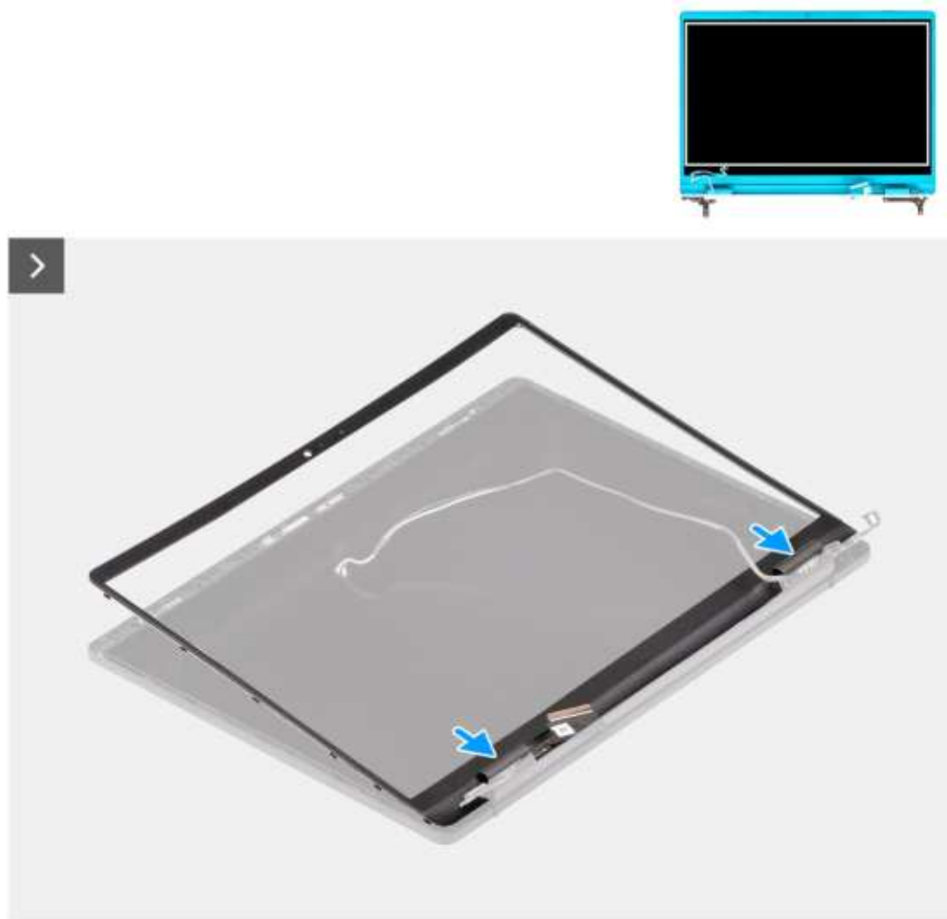
Rysunek 77. Instalowanie ramki wyświetlacza
