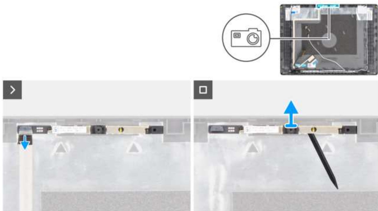
Rysunek 89. Wymontowywanie kamery
