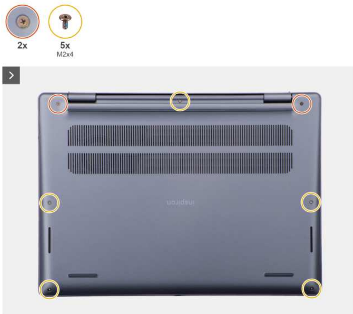
Rysunek 15. Wymontowywanie pokrywy dolnej
