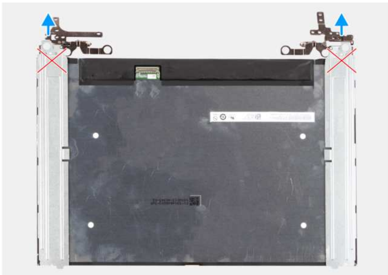
Rysunek 82. Wymontowywanie wyświetlacza
