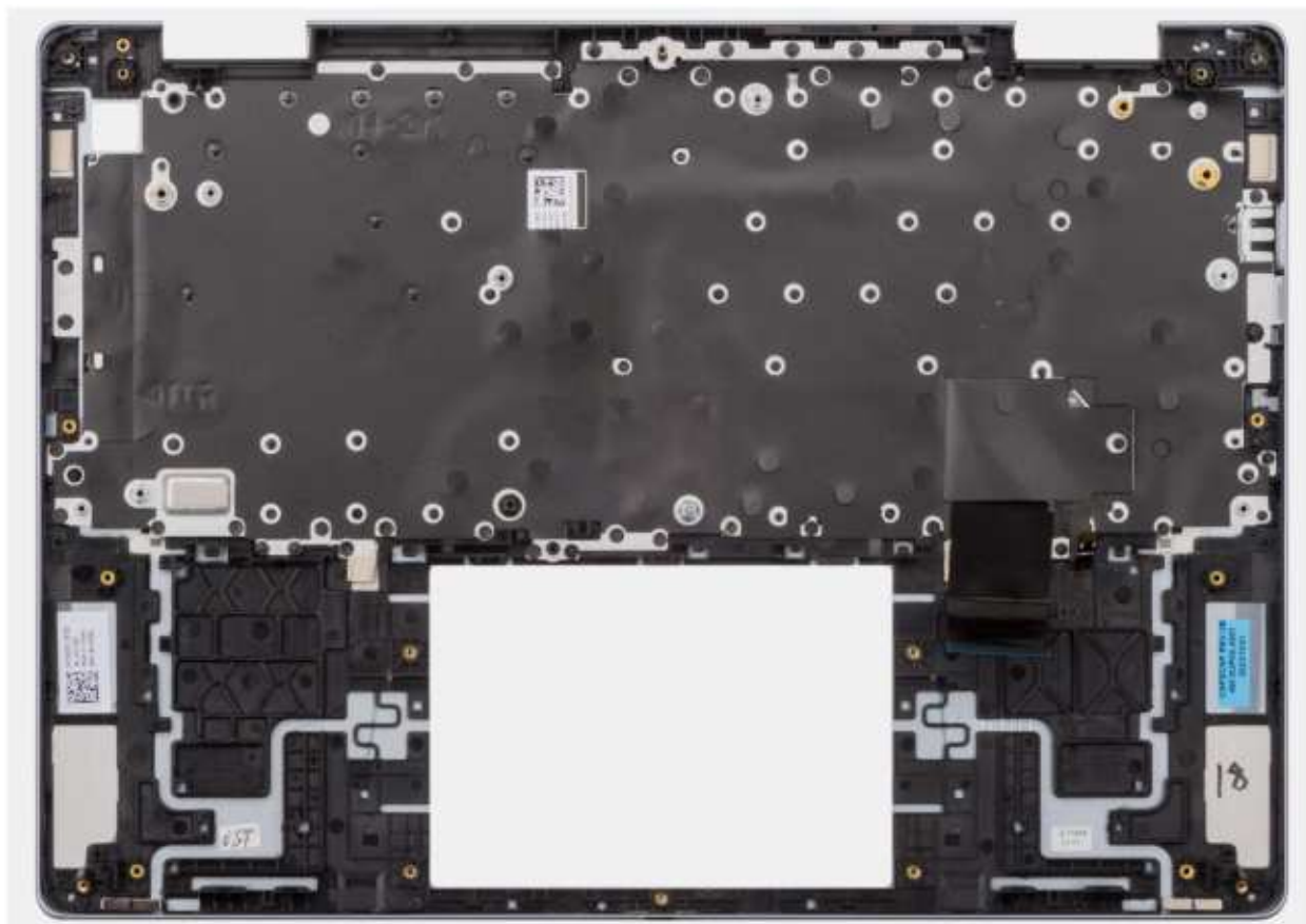
Rysunek 111. Wymontowywanie zestawu podpórki na nadgarstek i klawiatury
