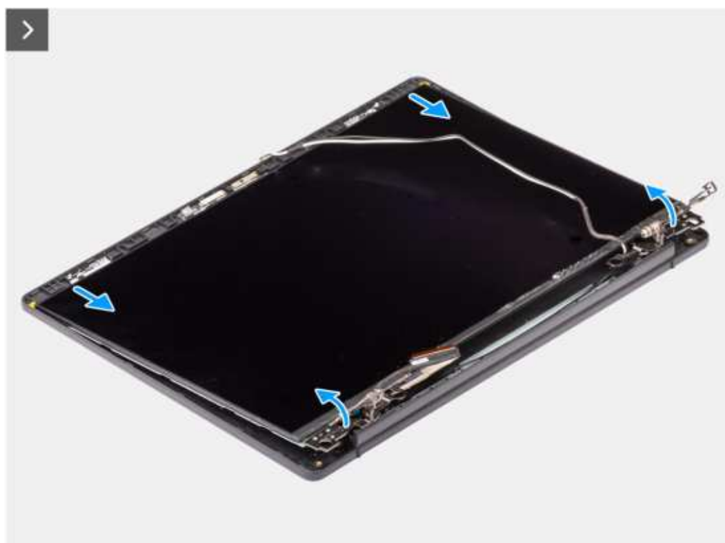
Rysunek 80. Wymontowywanie wyświetlacza
