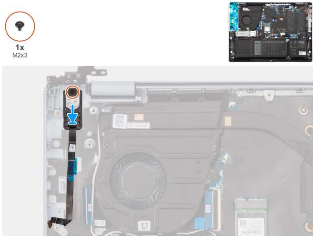
Rysunek 59. Instalowanie przycisku zasilania z czytnikiem linii papilarnych
