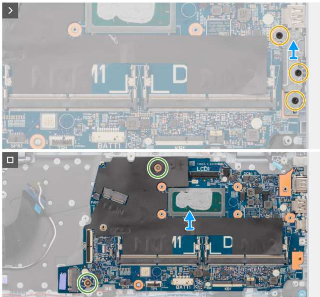
Rysunek 96. Wymontowywanie płyty głównej
