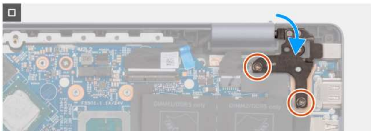
Rysunek 110. Wkręcanie śrub zawiasów
