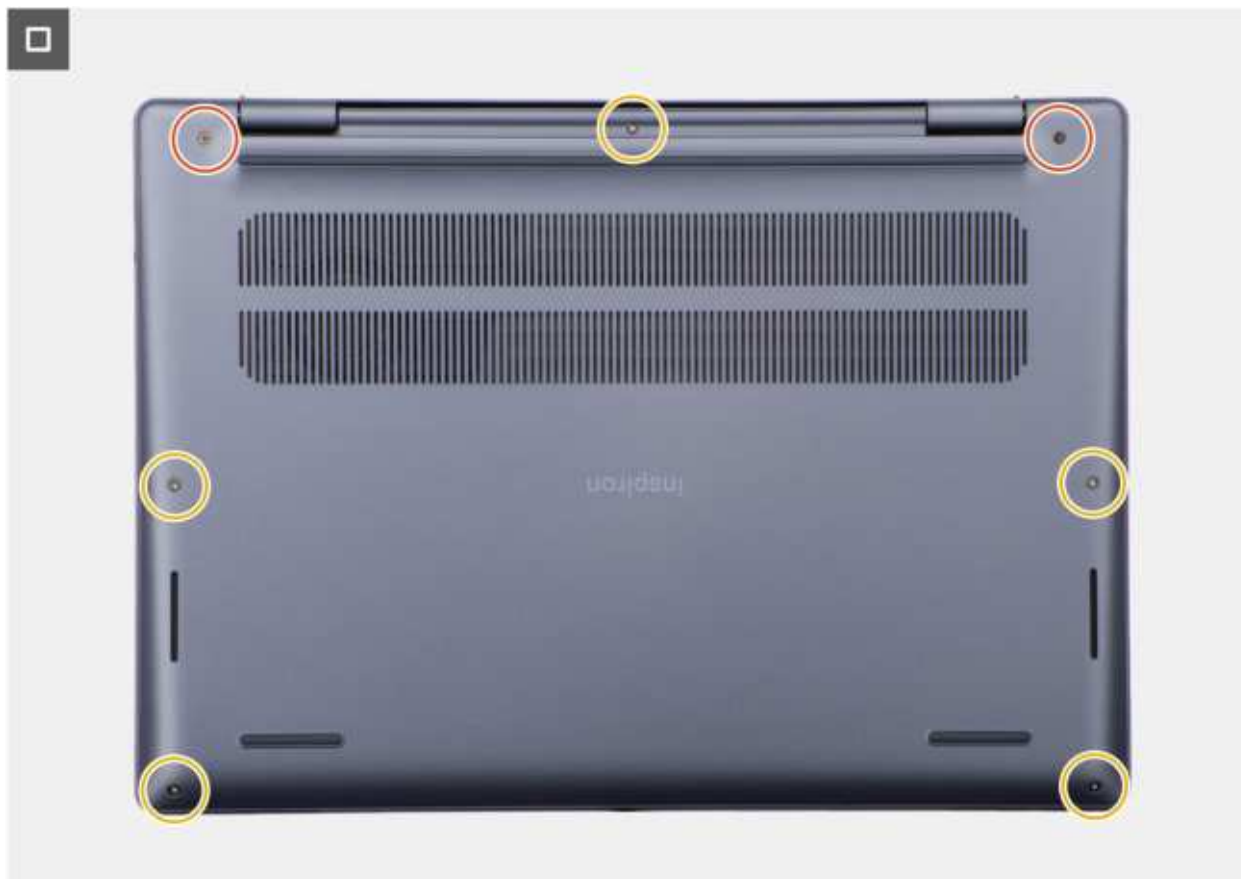
Rysunek 19. Instalowanie pokrywy dolnej
