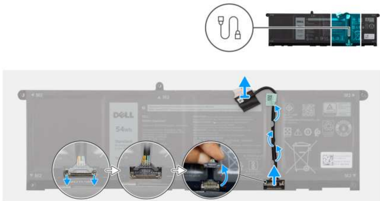
Rysunek 42. Odłączanie kabla baterii
