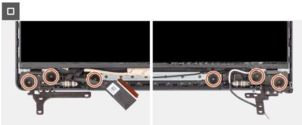
Rysunek 86. Instalowanie wyświetlacza
