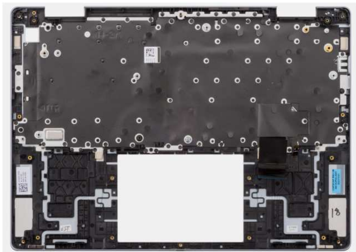
Rysunek 113. Wymontowywanie zestawu podpórki na nadgarstek i klawiatury
