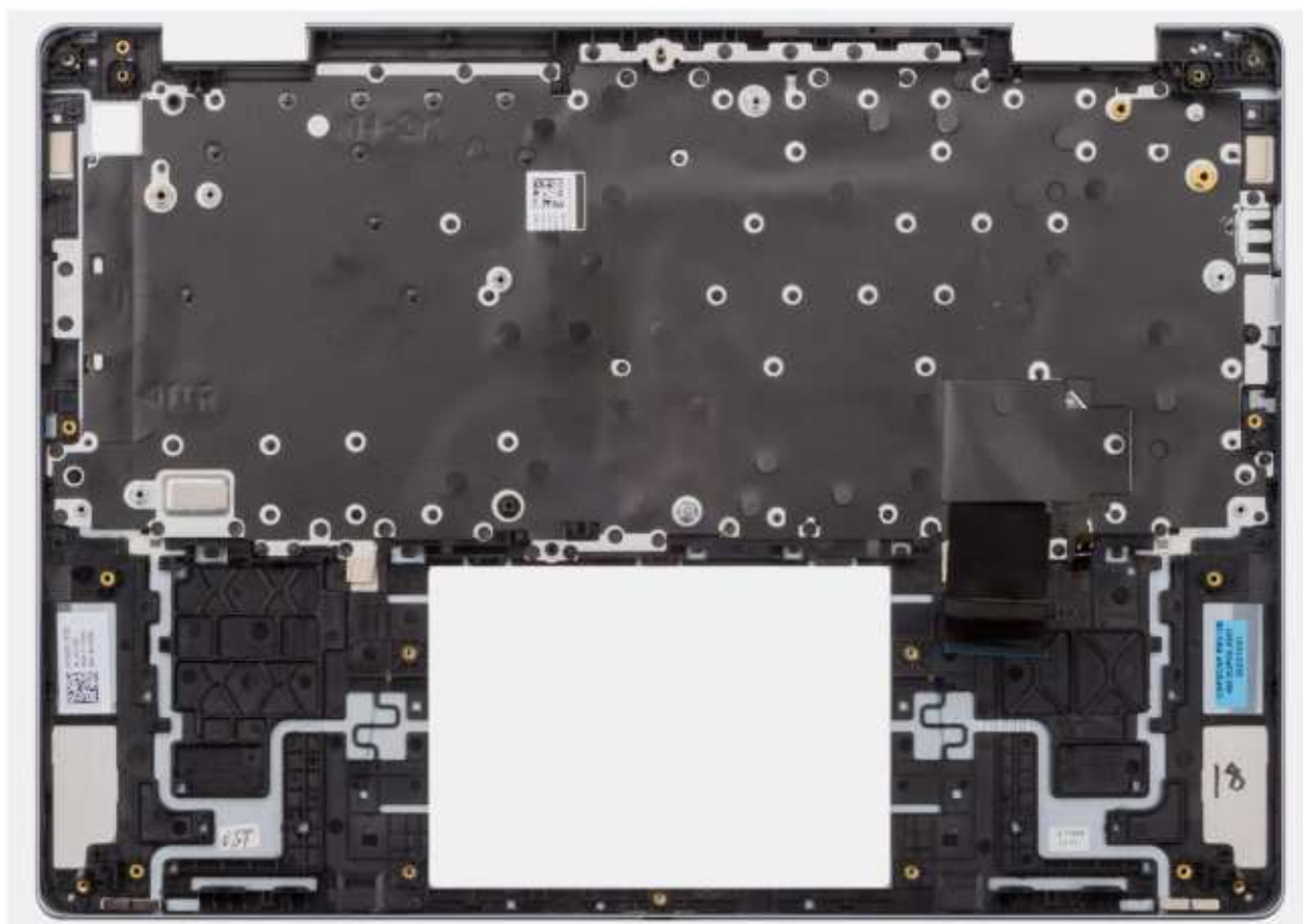
Rysunek 112. Instalowanie zestawu podpórki na nadgarstek i klawiatury
