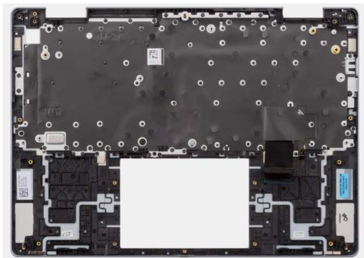
Rysunek 114. Instalowanie zestawu podpórki na nadgarstek i klawiatury
