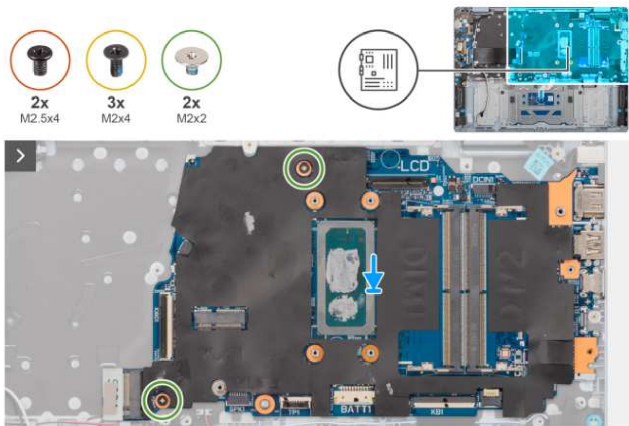
Rysunek 98. Instalowanie płyty głównej
