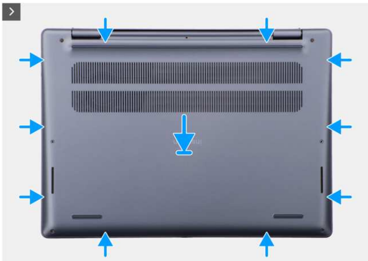
Rysunek 18. Instalowanie pokrywy dolnej
