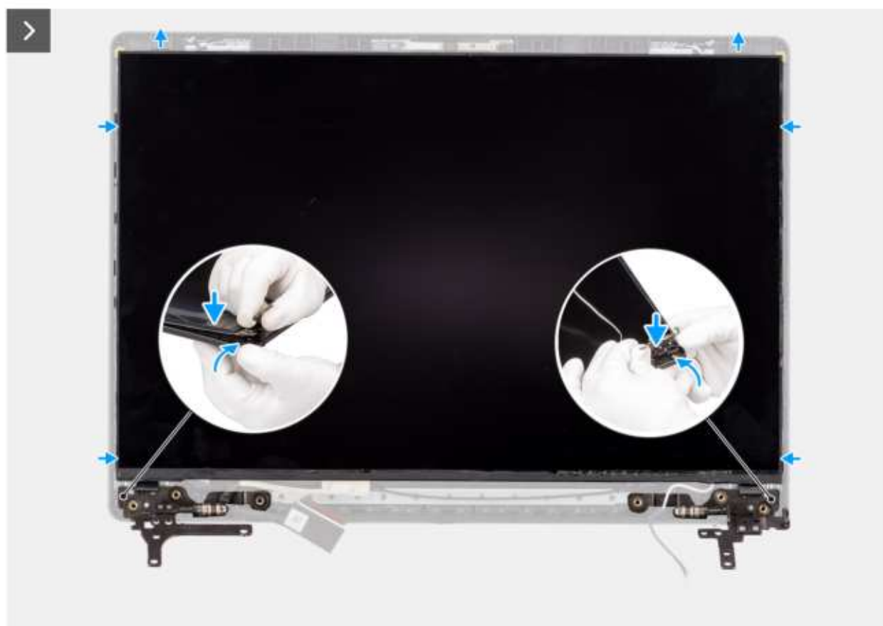
Rysunek 85. Instalowanie wyświetlacza
