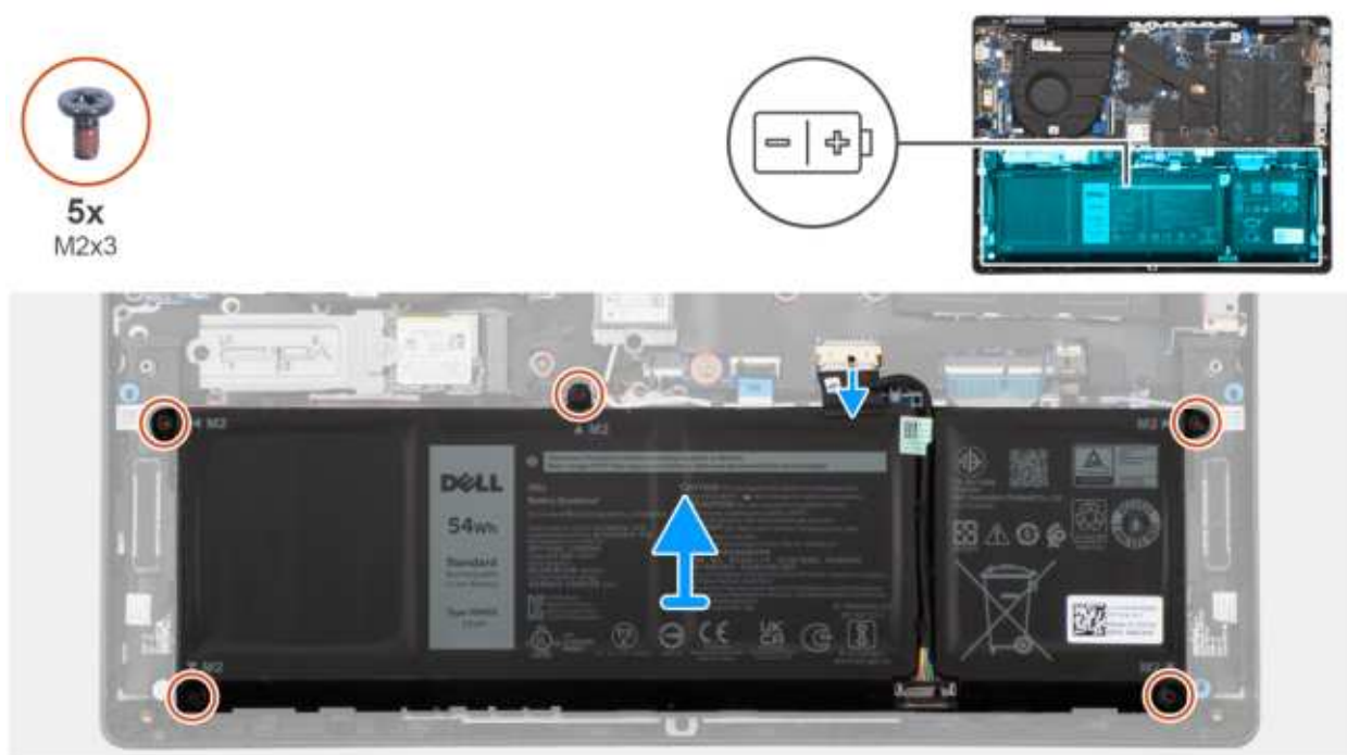
Rysunek 40. Wymontowywanie baterii
