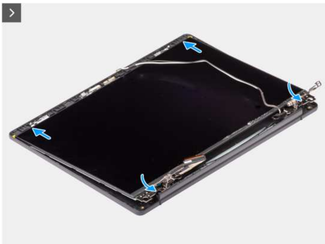
Rysunek 84. Wkręcanie śrub
