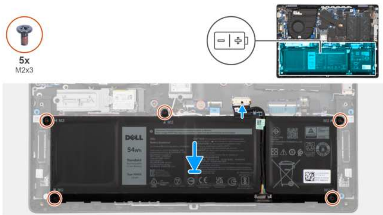
Rysunek 41. Instalowanie baterii
