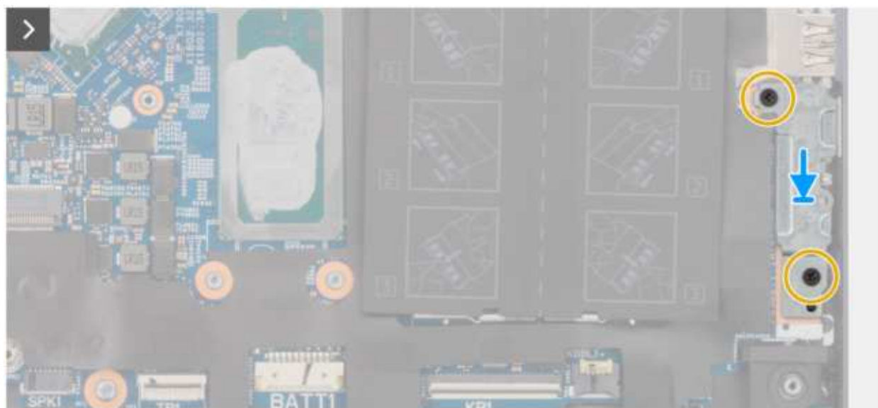
Rysunek 108. Instalowanie klamry portu USB Type-C
