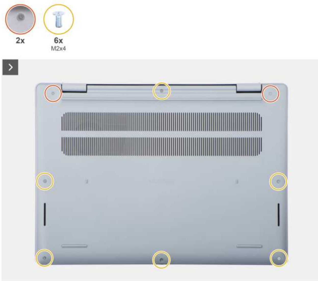
Rysunek 11. Wymontowywanie pokrywy dolnej
