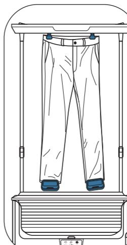
K zavěšení kalhot do zařízení Care For You použijte vestavěné straighteners (žehlicí svorky). Chcete-li napařovat, umístěte na konec každé nohavice malé straighteners (žehlicí svorky).
