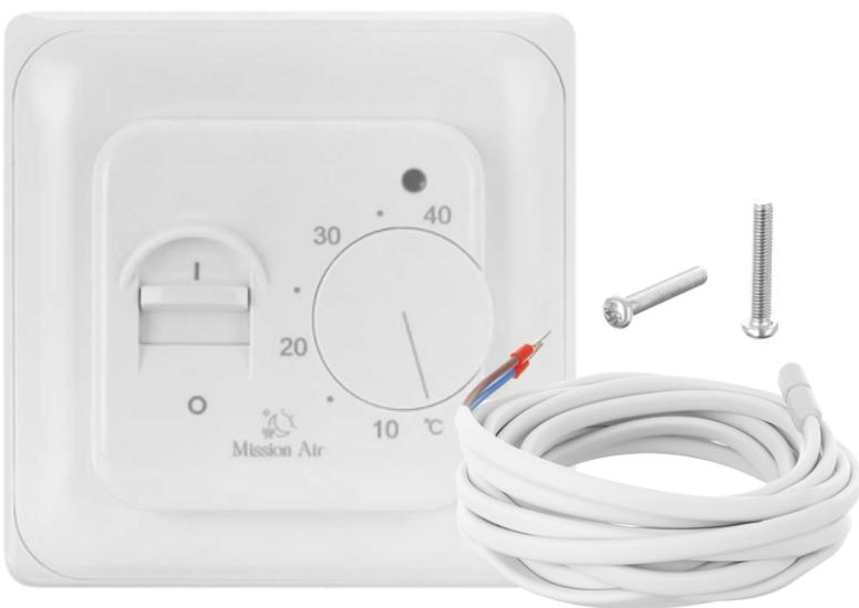
Der manuelle Mission Air® Aries Raumthermostat ist für die Steuerung von elektrischen Fußbodenheizungen konzipiert. Der Regler wird in einer 60-mm-Standard-Elektrodose montiert und funktioniert auf der Grundlage der Messwerte eines verdrahteten Bodentemperatursensors. Die LED zeigt den Betrieb des Systems an und ermöglicht eine Temperaturregelung von 5-40 °C.
