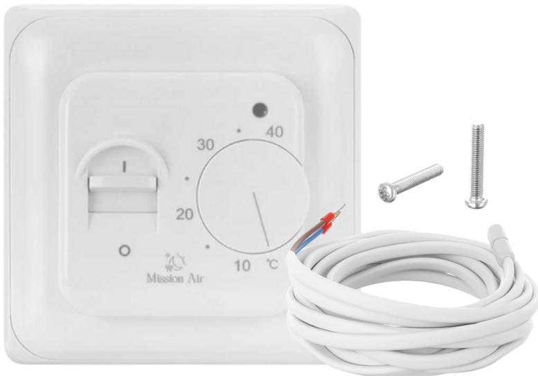
Ручний кімнатний термостат Mission Air® Aries призначений для керування системами електричної теплої підлоги. Контролер встановлюється в стандартну 60-міліметрову електричну коробку і працює на основі показань дротового датчика температури підлоги. Світлодіод відображає роботу системи, можливе регулювання температури в діапазоні 5-40°C.
