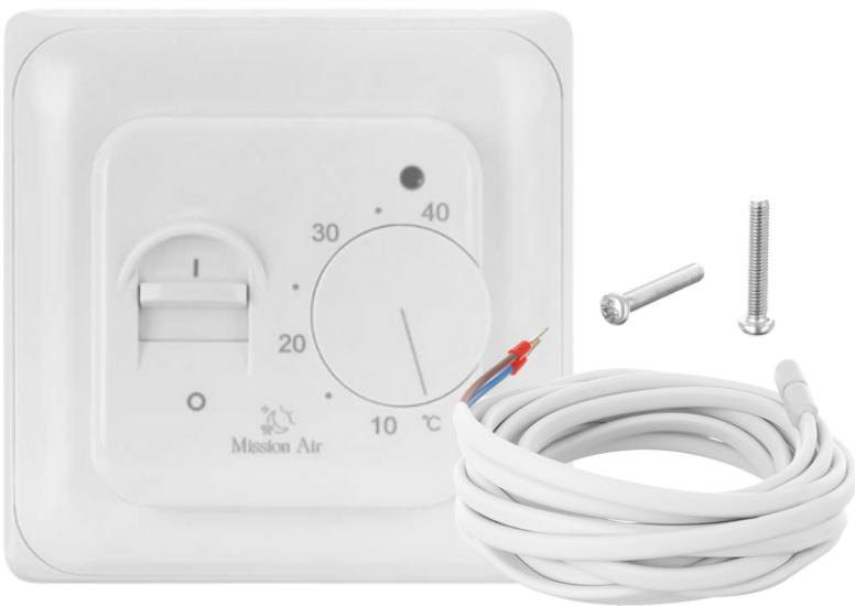
Manualny termostat pokojowy Mission Air® Aries przeznaczony jest do sterowania systemami elektrycznego ogrzewania podłogowego. Regulator montowany w standardowej puszce elektrycznej 60mm, pracuje w oparciu o odczyty przewodowego czujnika temperatury podłogi. Dioda LED sygnalizuje pracę systemu, możliwa regulacja temperatury w zakresie 5-40°C.
