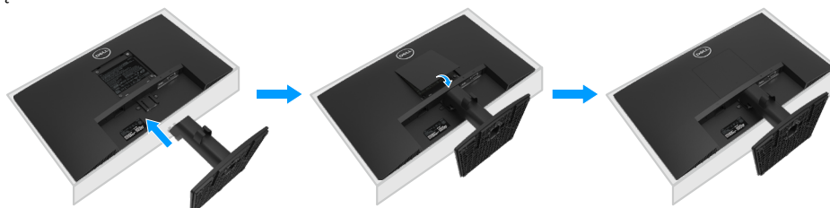
Rysunek 13. Zakładanie podstawy
