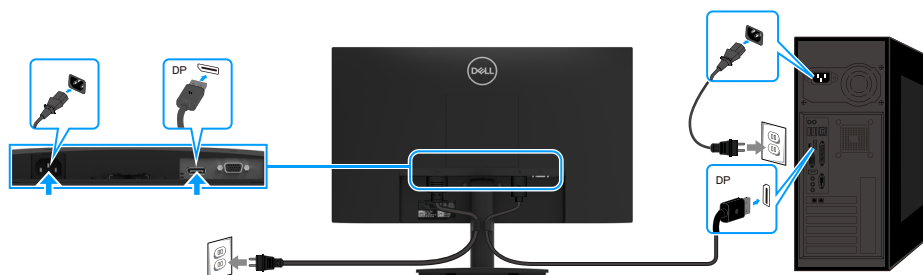
Rysunek 15. Podłączanie kabla DP
