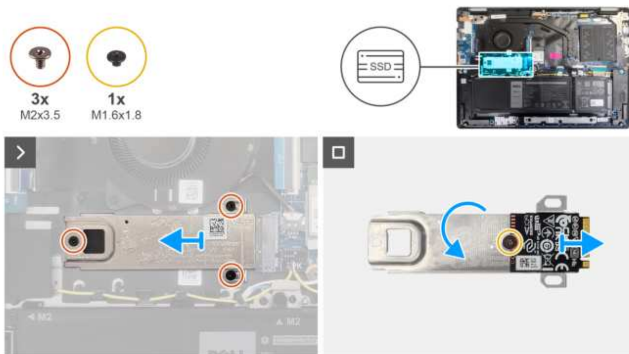
Rysunek 20. Wymontowywanie dysku SSD
