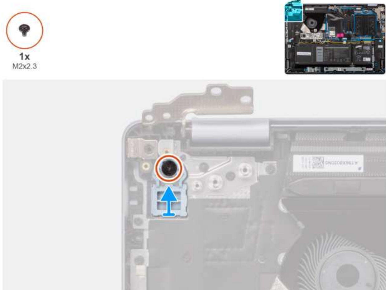
Rysunek 42. Wymontowywanie przycisku zasilania
