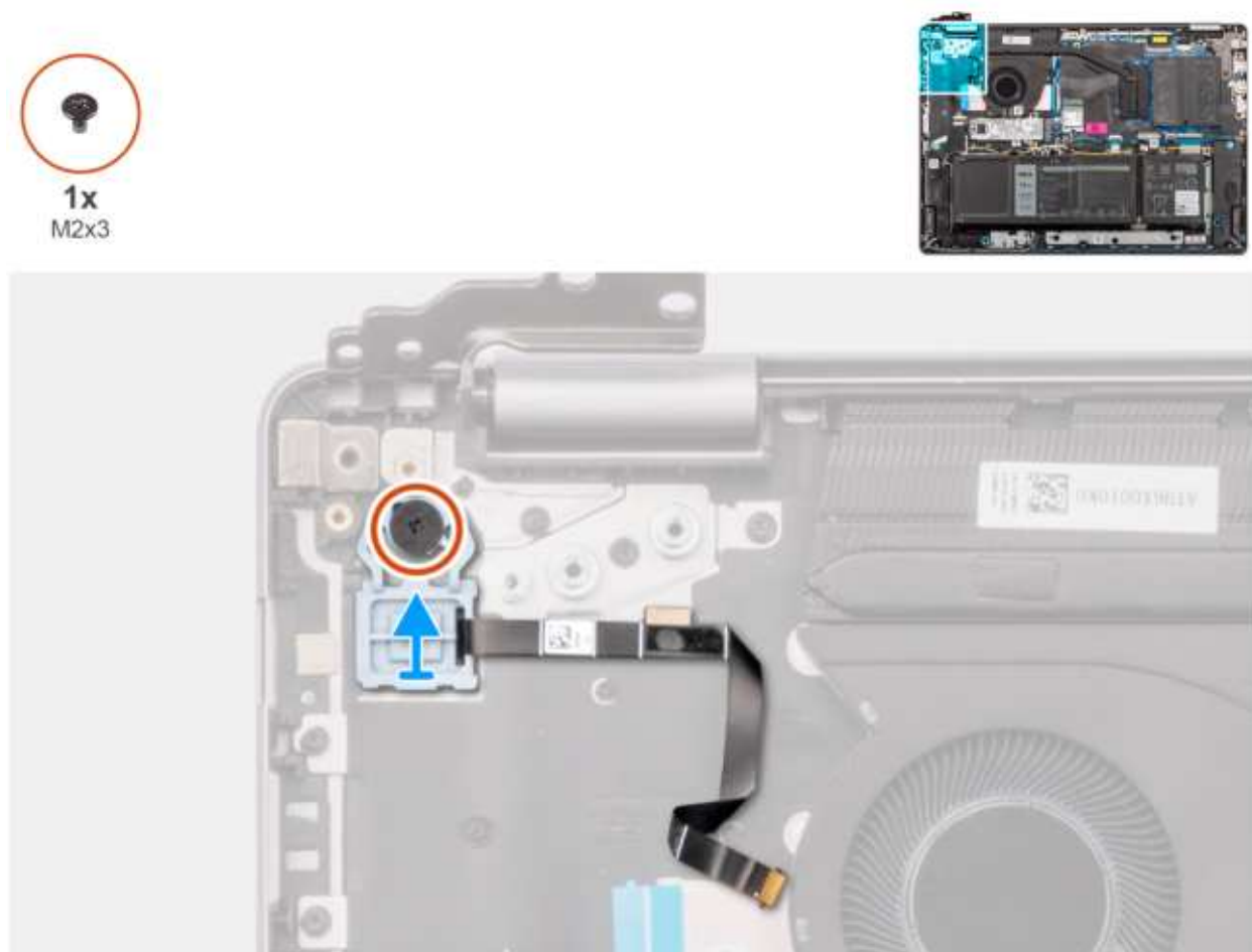
Rysunek 44. Wymontowywanie przycisku zasilania z opcjonalnym czytnikiem linii papilarnych
