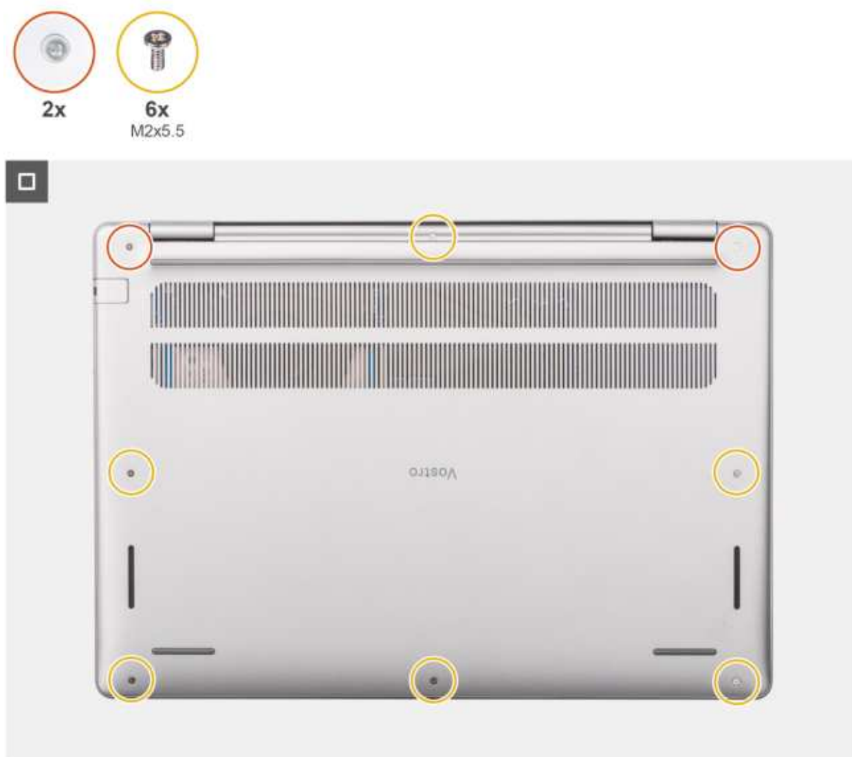
Rysunek 17. Instalowanie pokrywy dolnej
