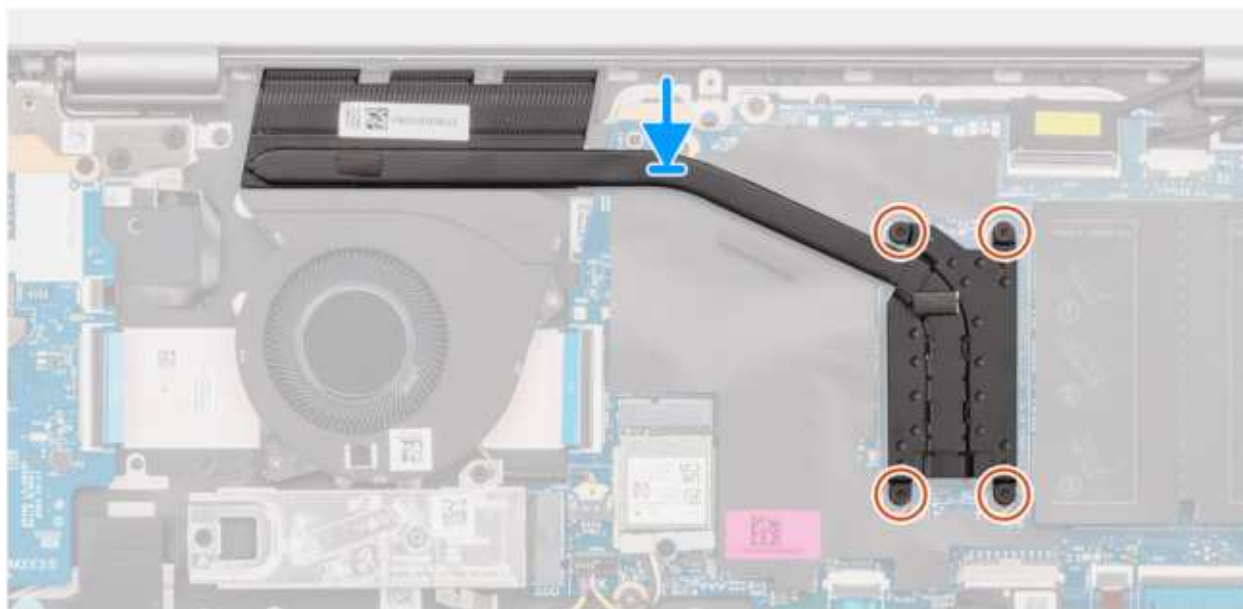
Rysunek 33. Instalowanie radiatora
