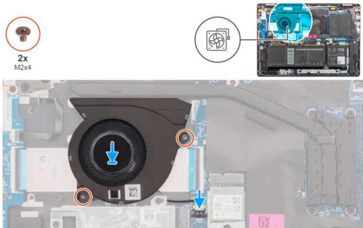
Rysunek 27. Instalowanie wentylatora
