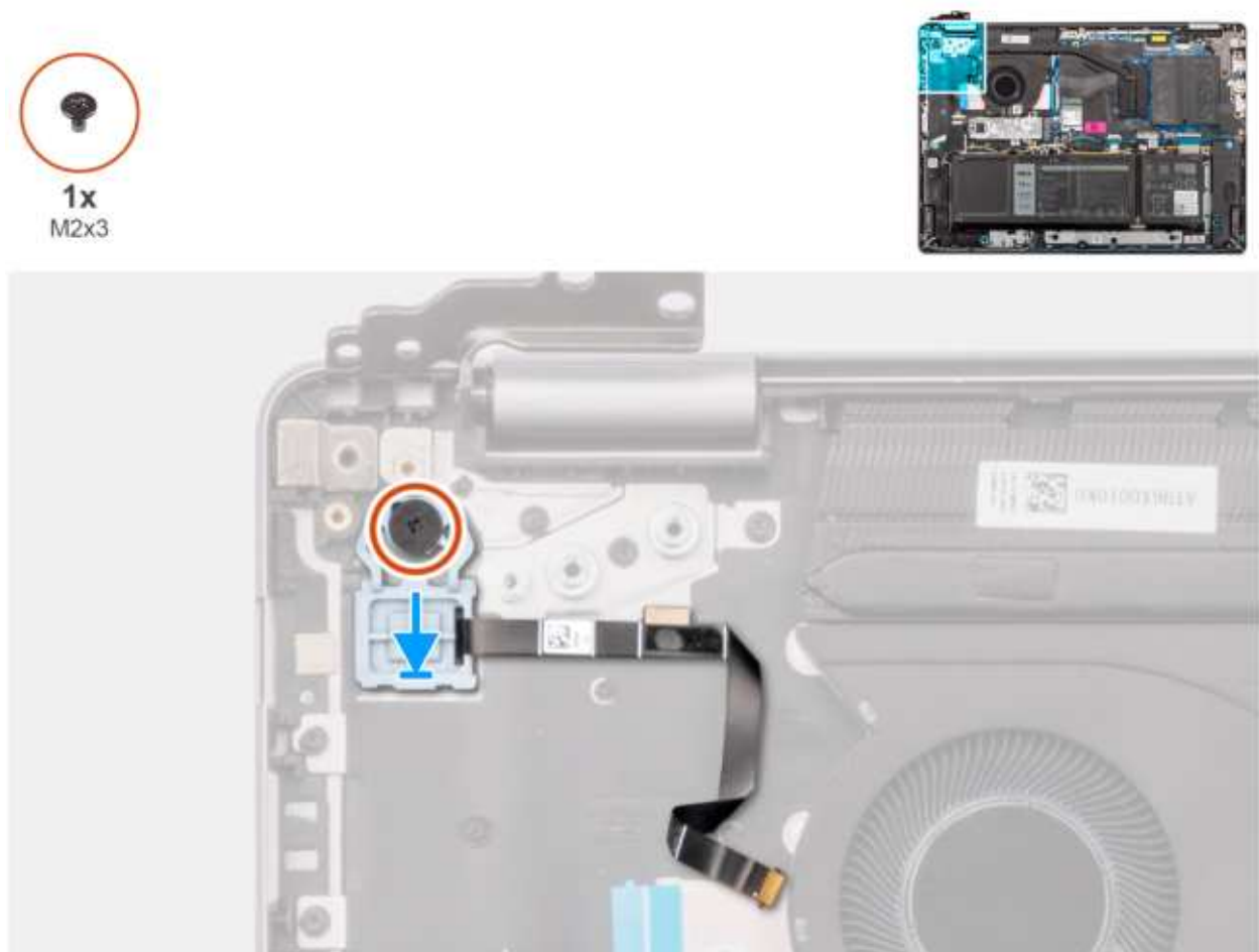
Rysunek 45. Instalowanie przycisku zasilania z opcjonalnym czytnikiem linii papilarnych
