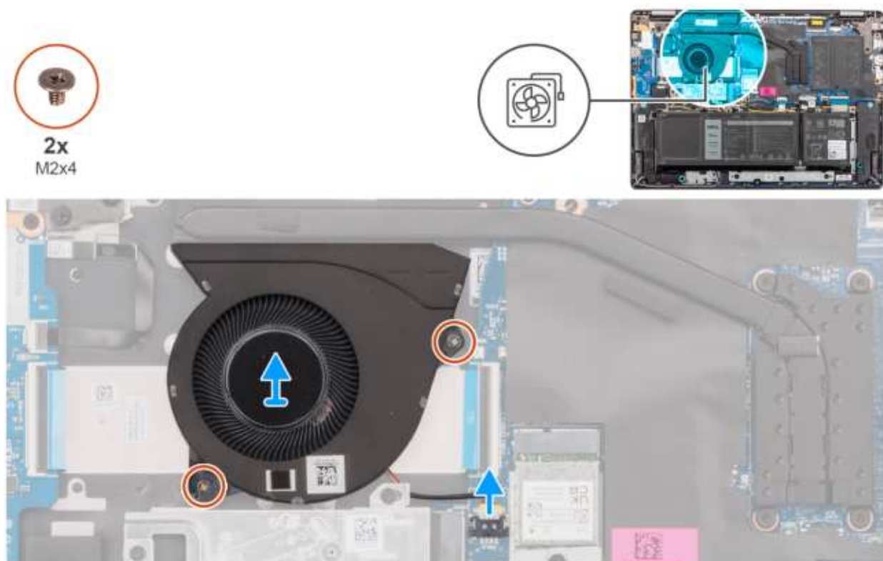
Rysunek 26. Wymontowywanie wentylatora
