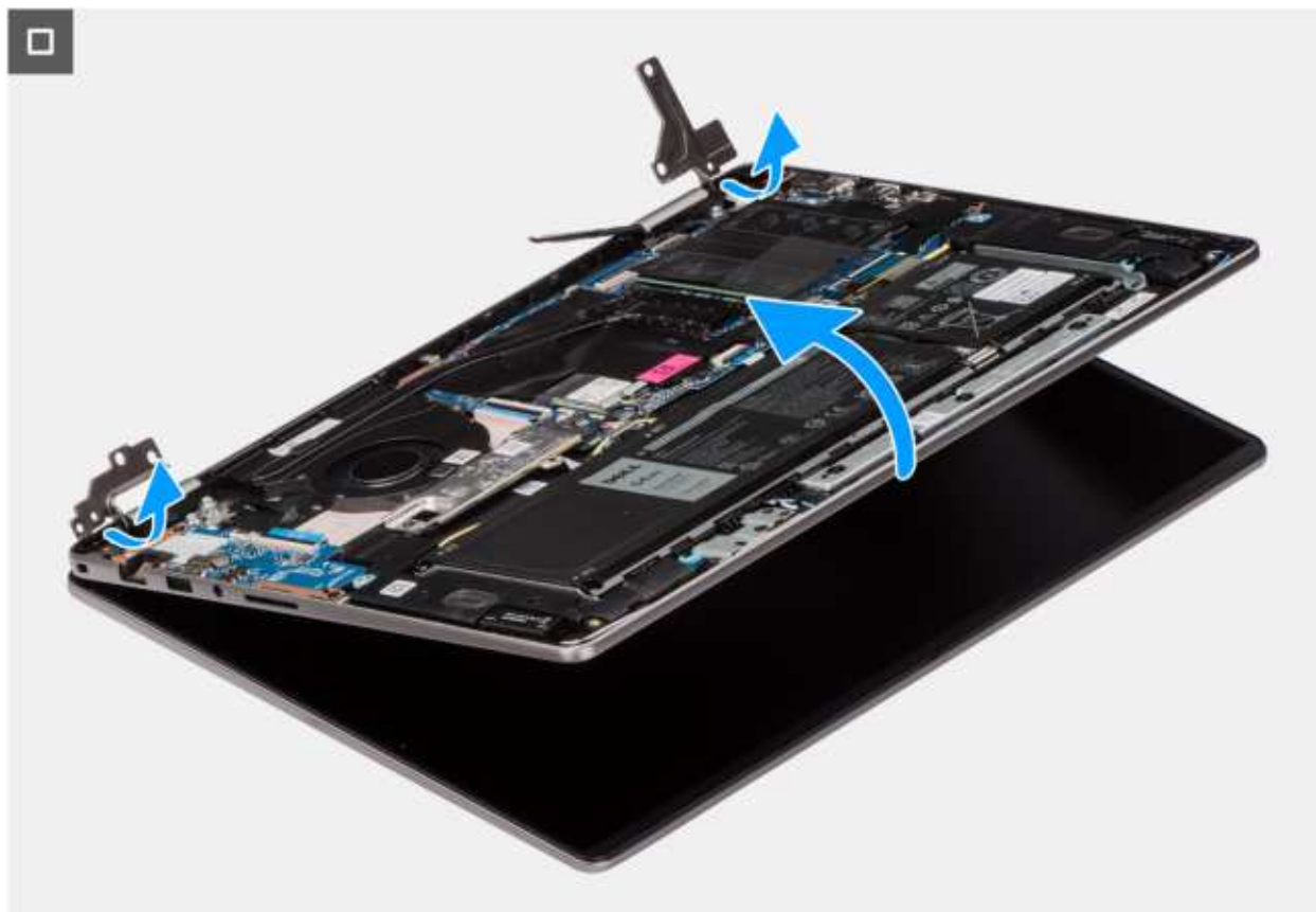
Rysunek 36. Wymontowywanie zestawu wyświetlacza
