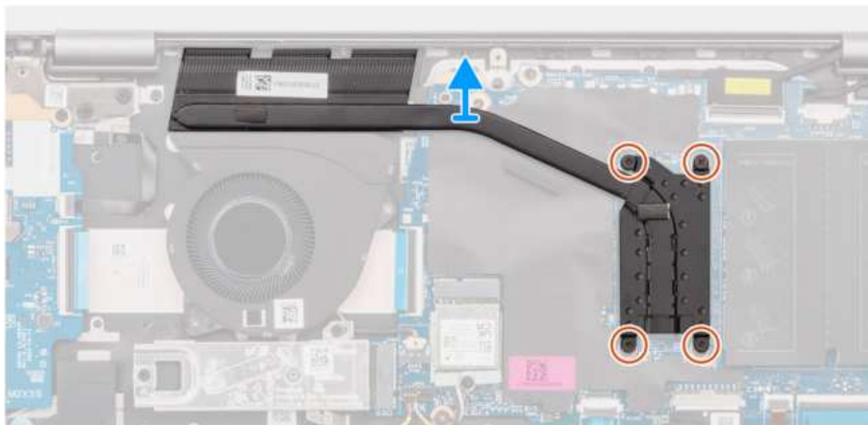
Rysunek 32. Wymontowywanie radiatora
