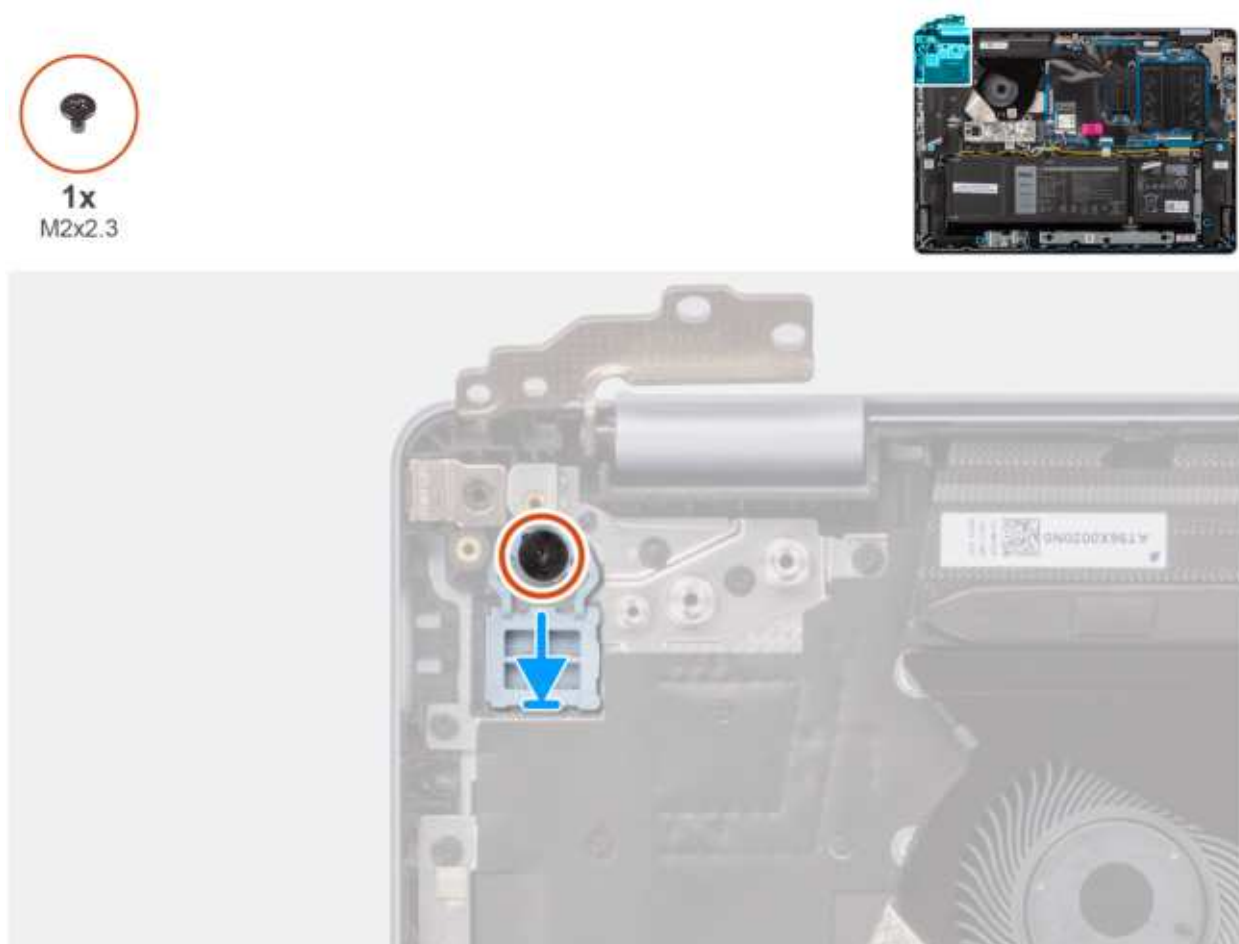
Rysunek 43. Instalowanie przycisku zasilania
