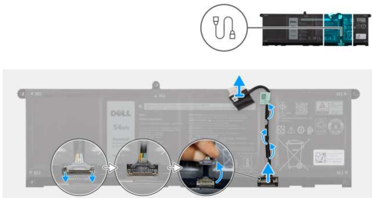
Rysunek 29. Odlaczanie kabla baterii
