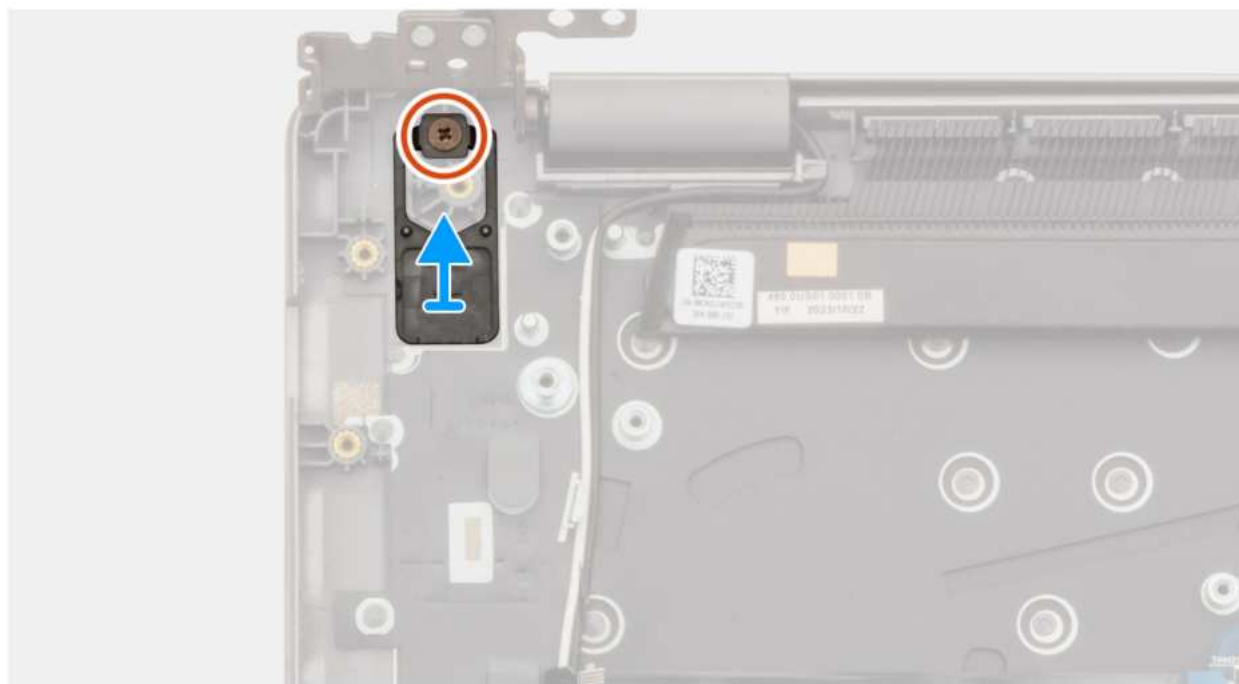
Rysunek 38. Wymontowywanie przycisku zasilania
