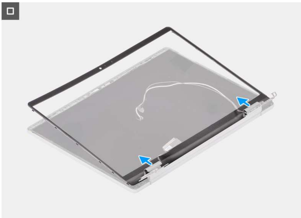
Rysunek 49. Wymontowywanie ramki wyświetlacza
