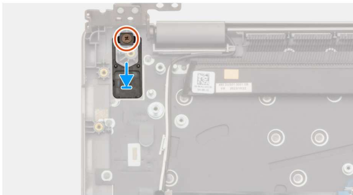
Rysunek 39. Instalowanie przycisku zasilania
