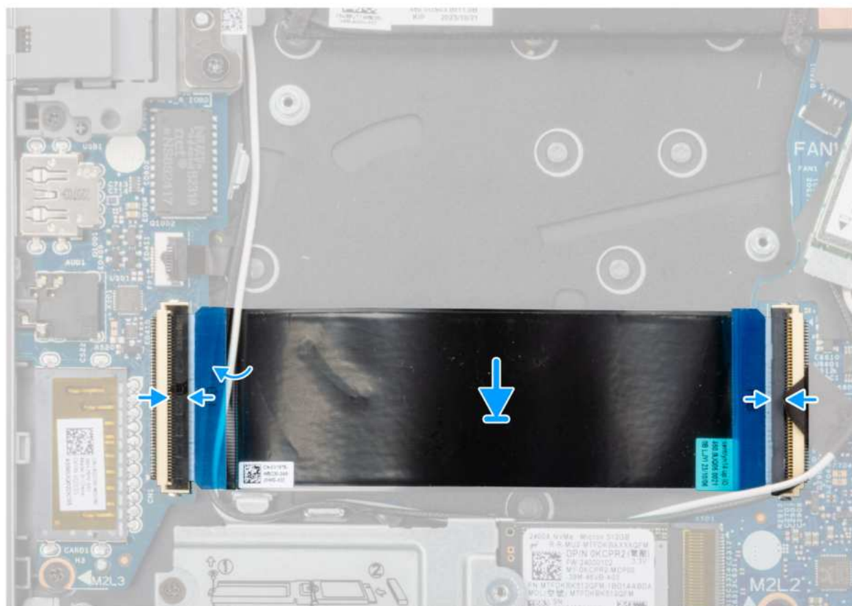
Rysunek 35. Instalowanie kabla płyty we/wy
