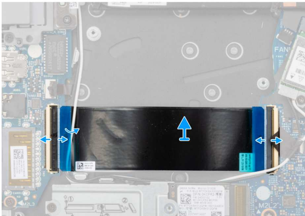
Rysunek 34. Wymontowywanie kabla płyty we/wy
