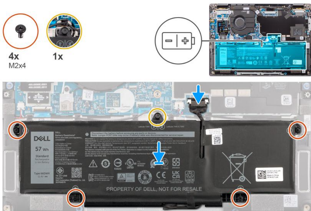
Rysunek 32. Instalowanie baterii 3-ogniowej
