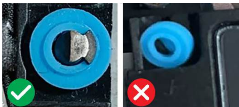
Rysunek 40. Położenie osadzenia gumowych pierścieni
