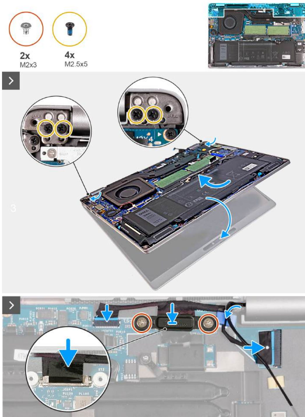
Rysunek 52. Instalowanie zestawu wyświetlacza — dotyczy komputerów z autonomiczną kartą graficzną
