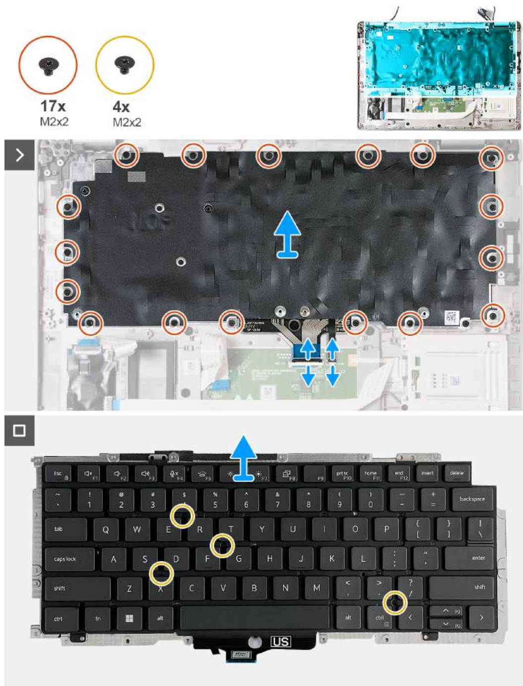
Rysunek 79. Wymontowywanie klawiatury
