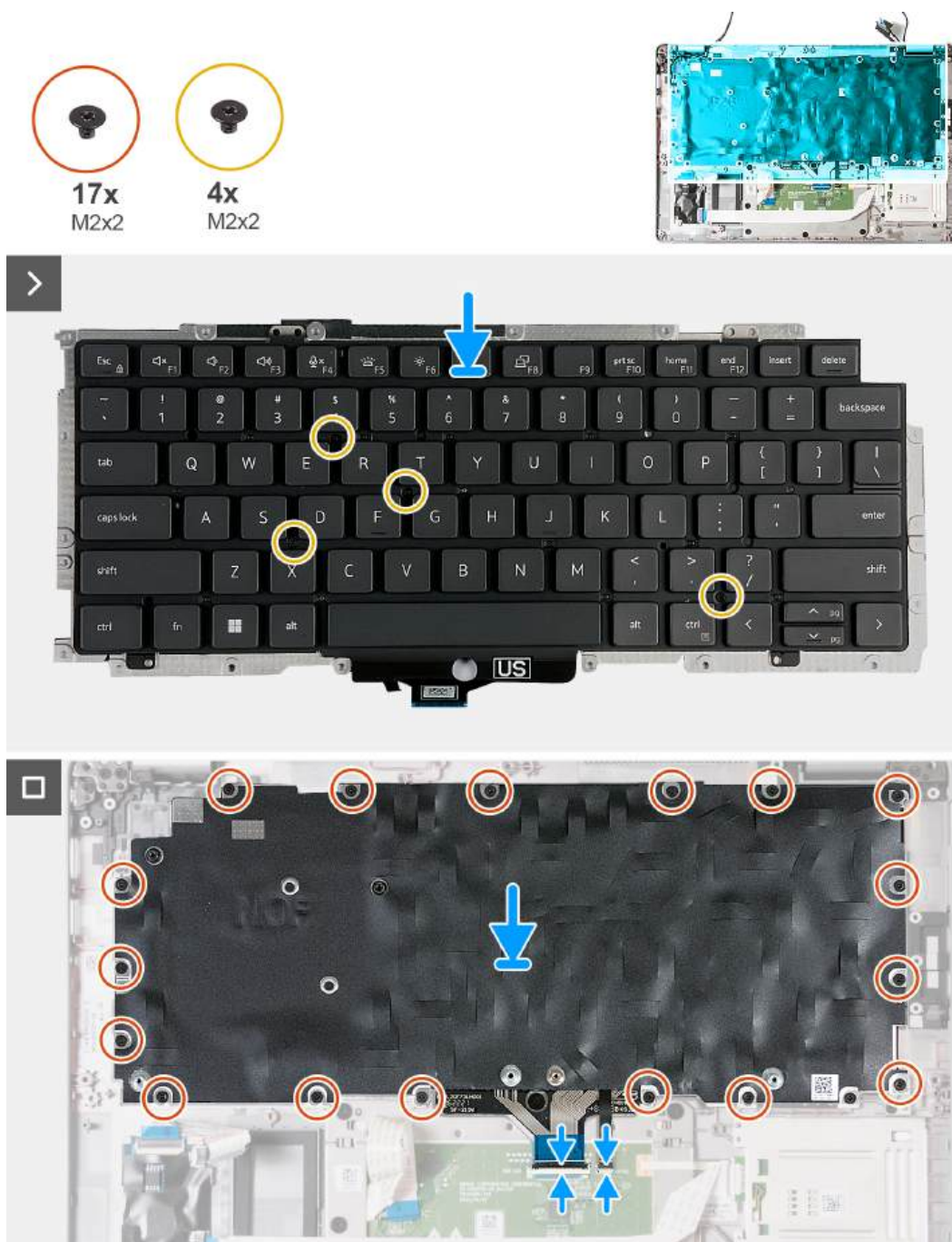
Rysunek 81. Instalowanie klawiatury
