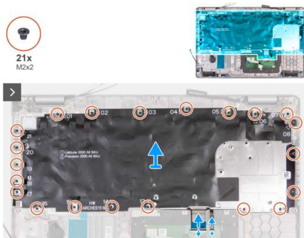
Rysunek 65. Wymontowywanie klawiatury
