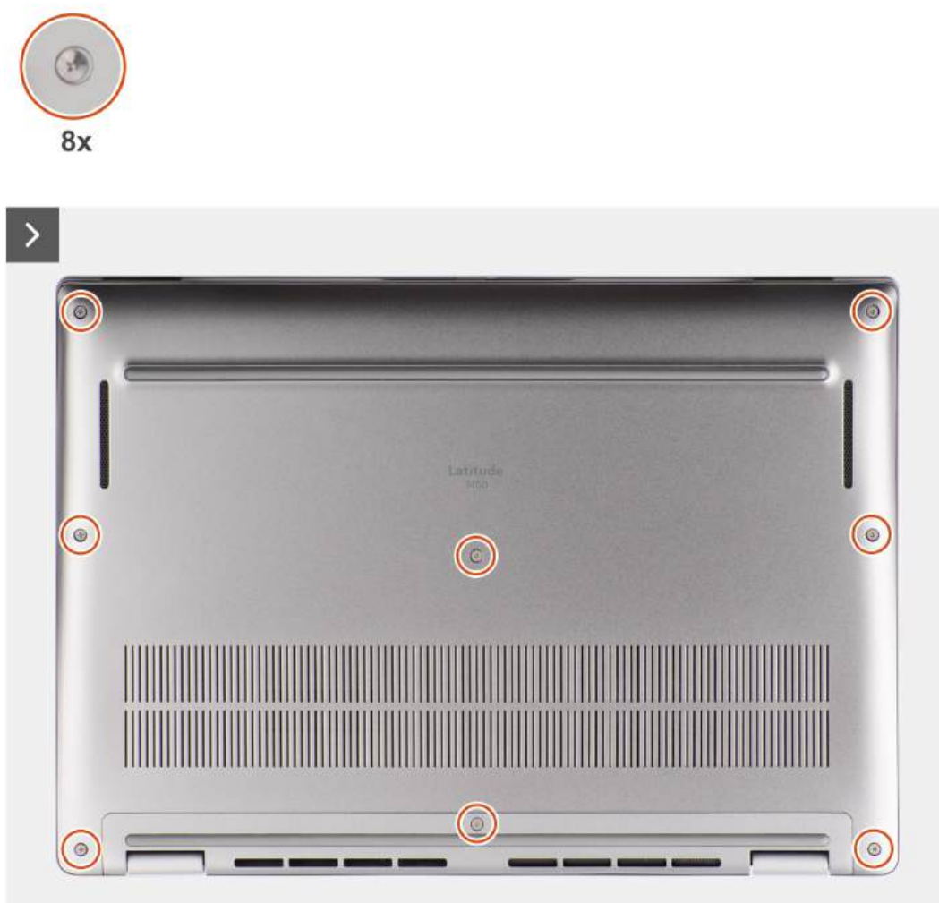
Rysunek 15. Wymontowywanie pokrywy dolnej
