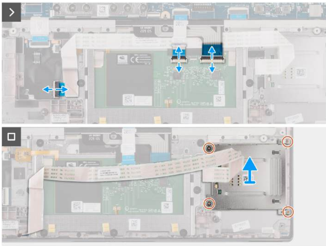
Rysunek 53. Wymontowywanie czytnika kart smart
