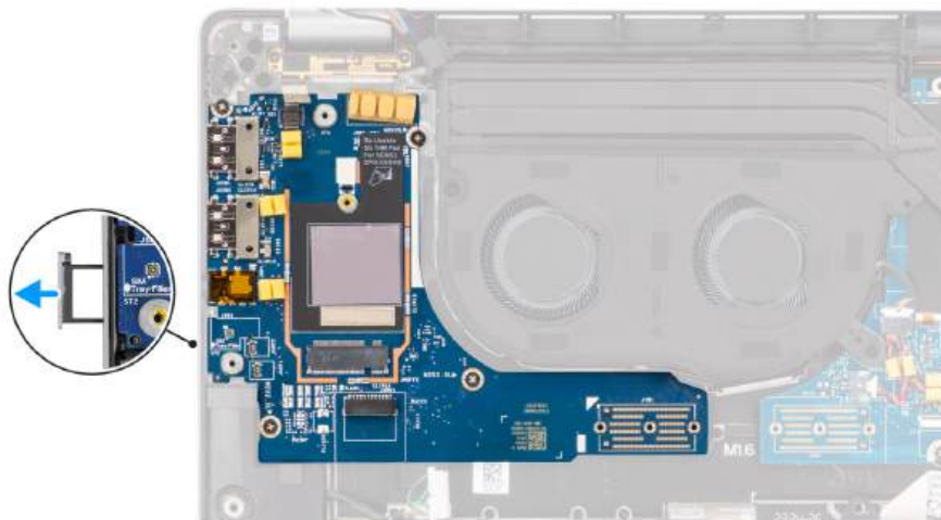
Rysunek 67. Wymontowywanie karty towarzyszącej we/wy
