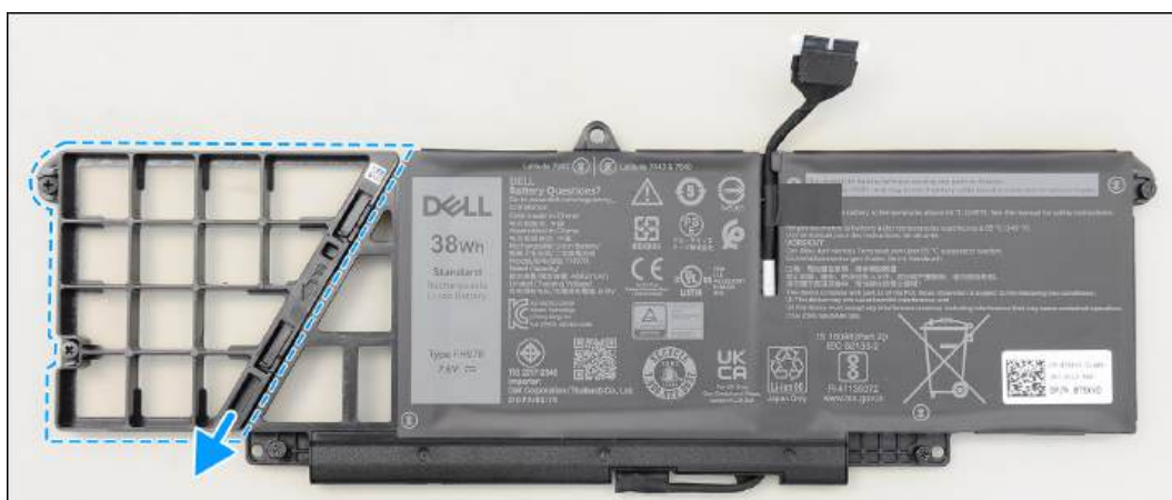
Rysunek 35. Wymontowywanie baterii 2-ogniowej
