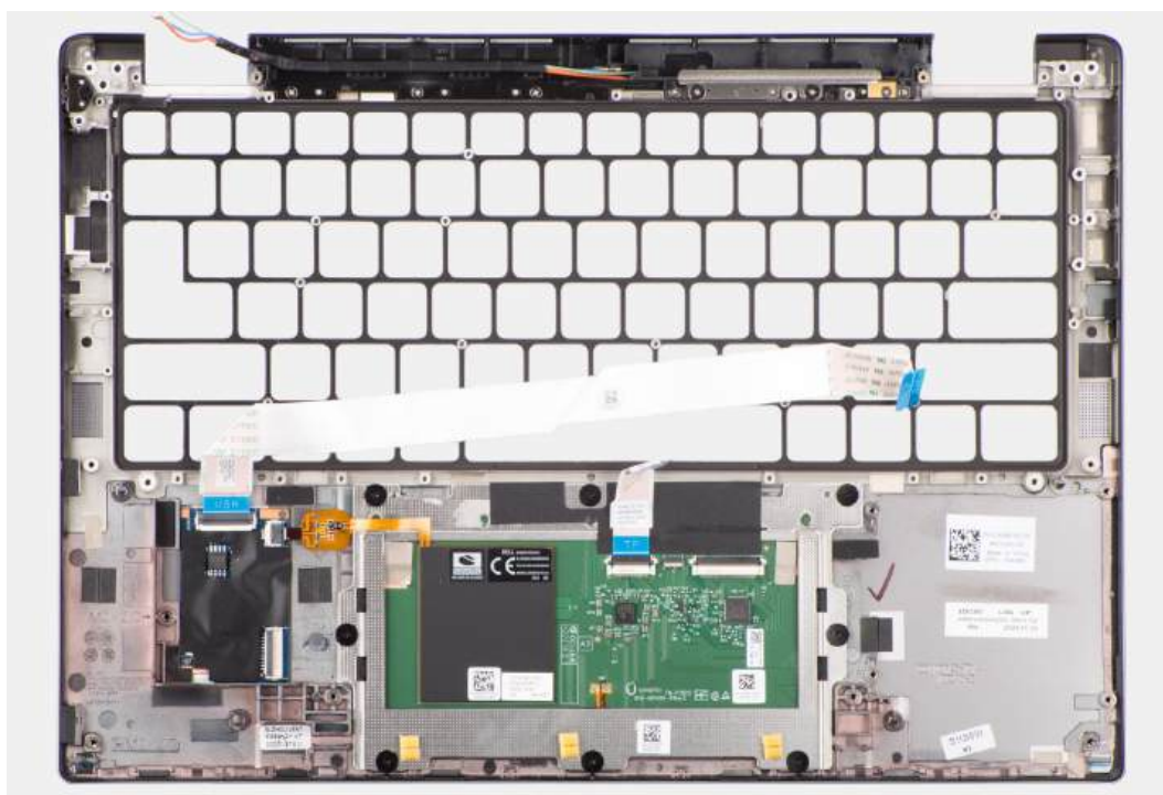
Rysunek 81. Wymontowywanie zestawu podpórki na nadgarstek
