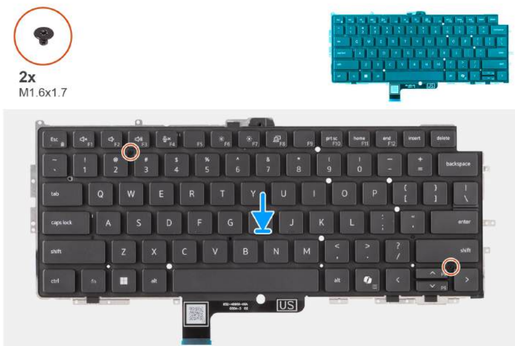
Rysunek 79. Instalowanie klawiatury
