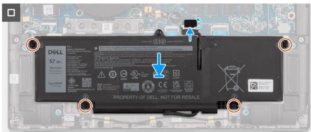
Rysunek 40. Instalowanie baterii 3-ogniowej
