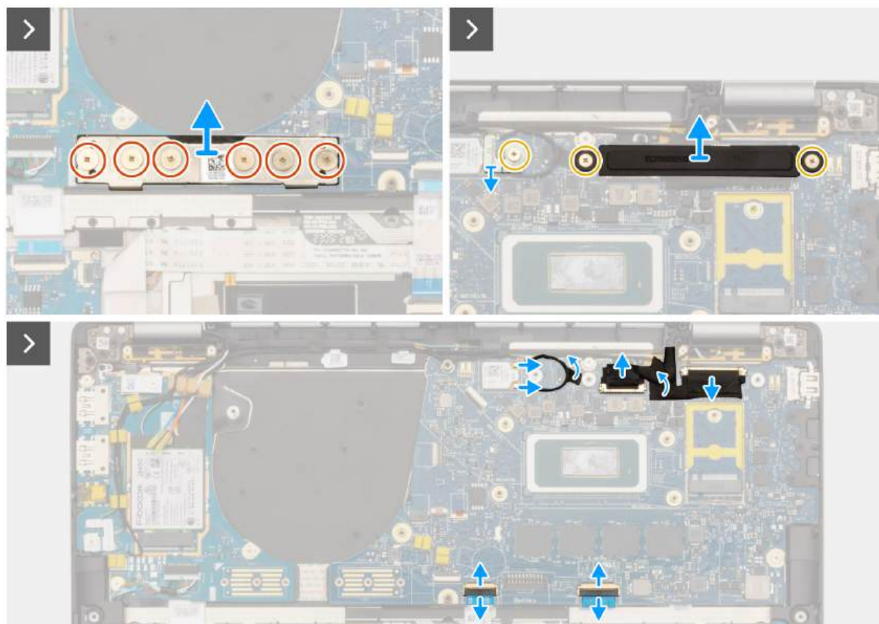
Rysunek 56. Wymontowywanie płyty głównej
