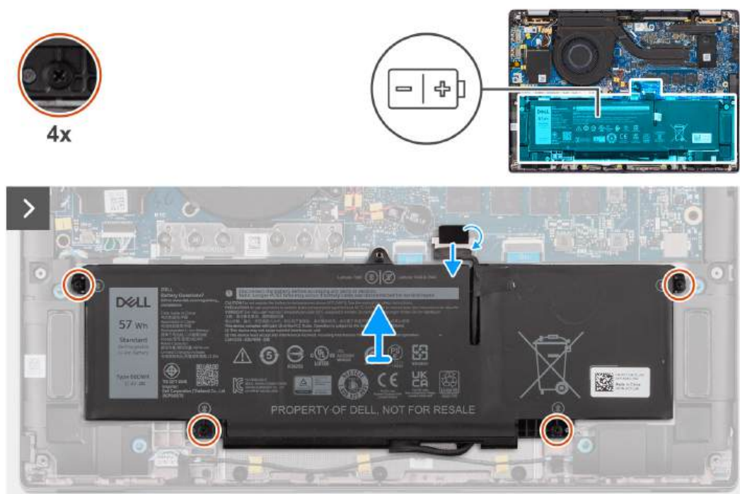
Rysunek 37. Wymontowywanie baterii 3-ogniowej
