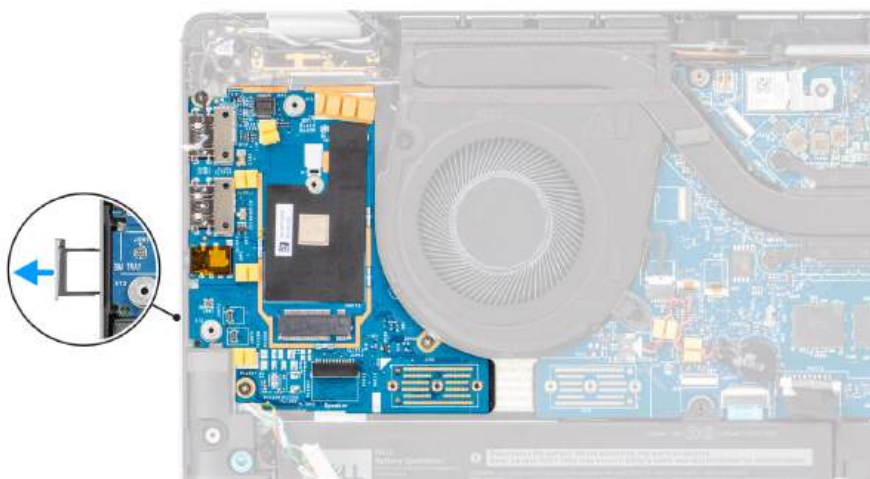
Rysunek 13. Wymontowywanie karty towarzyszącej we/wy
