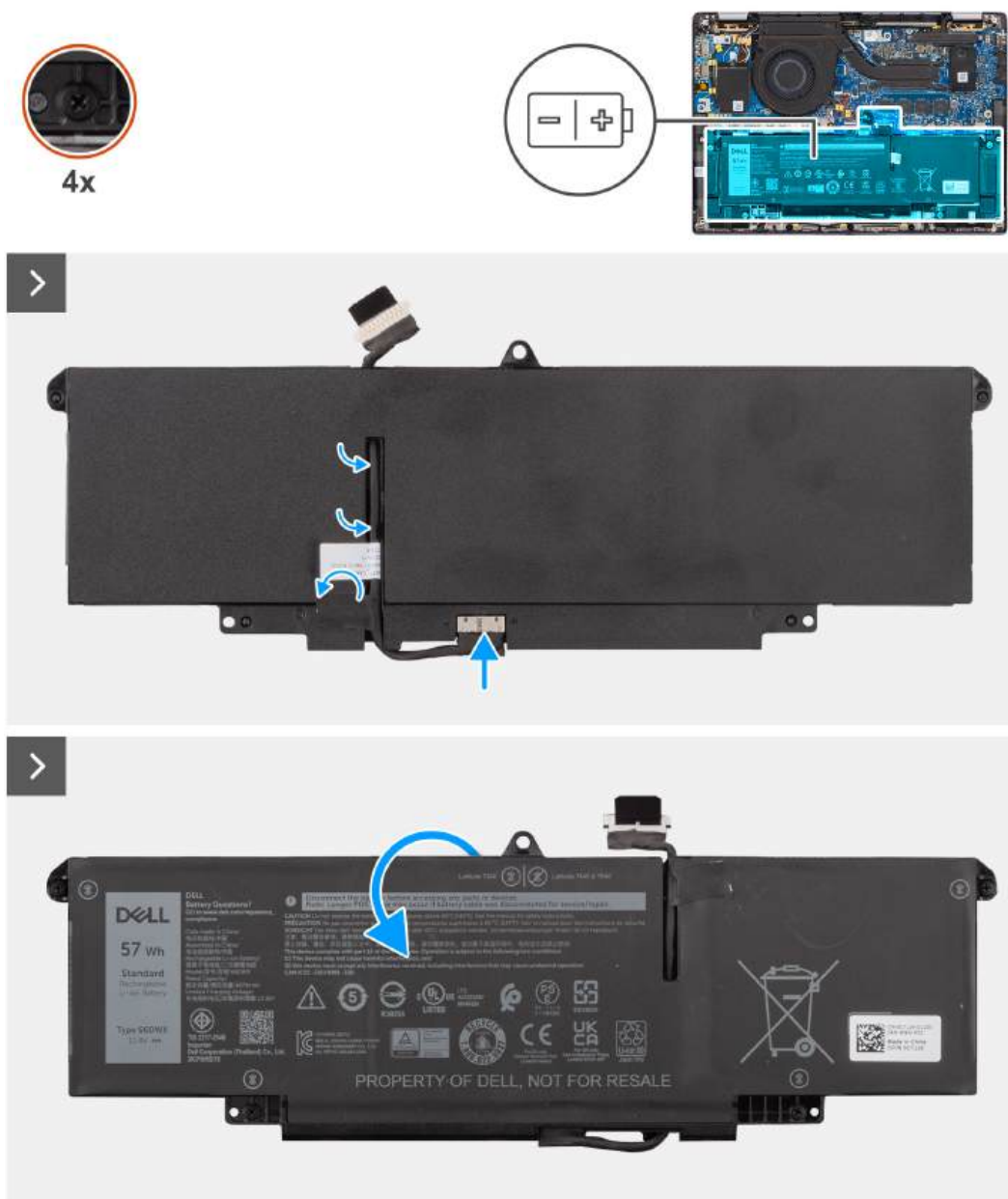
Rysunek 39. Instalowanie baterii 3-ogniowej
