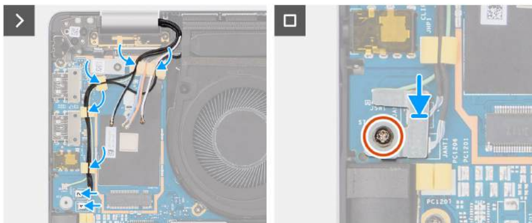
Rysunek 52. Instalowanie zestawu wyświetlacza
