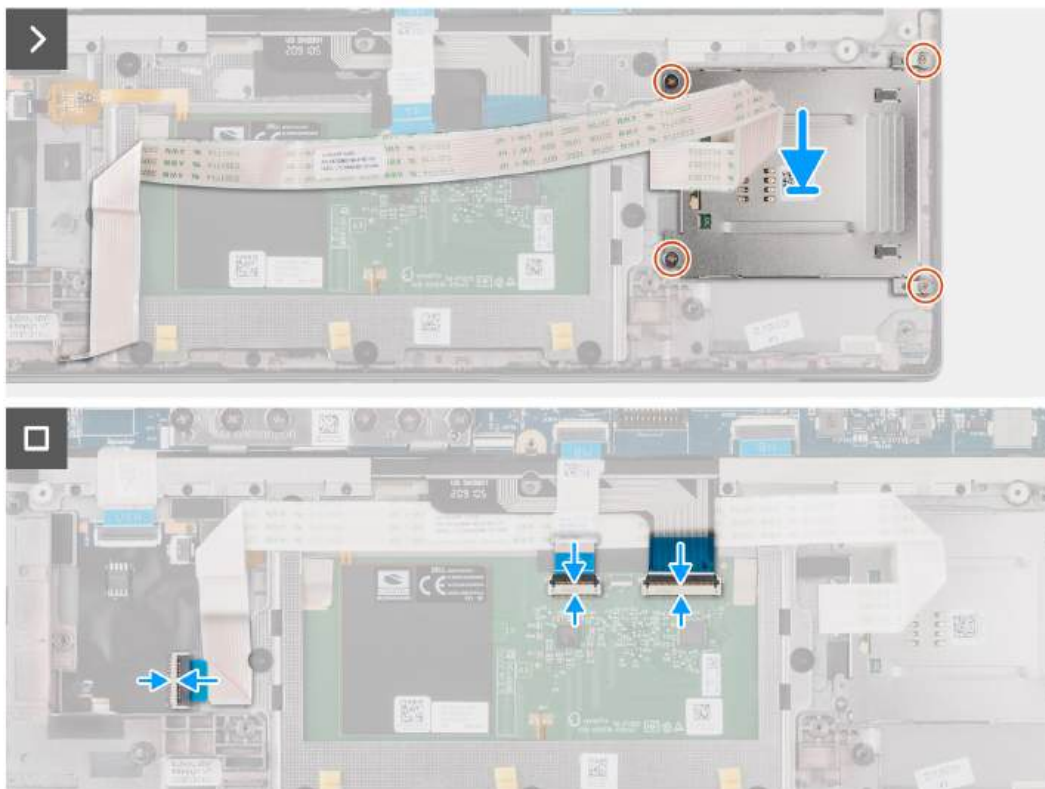
Rysunek 54. Instalowanie czytnika kart smart
