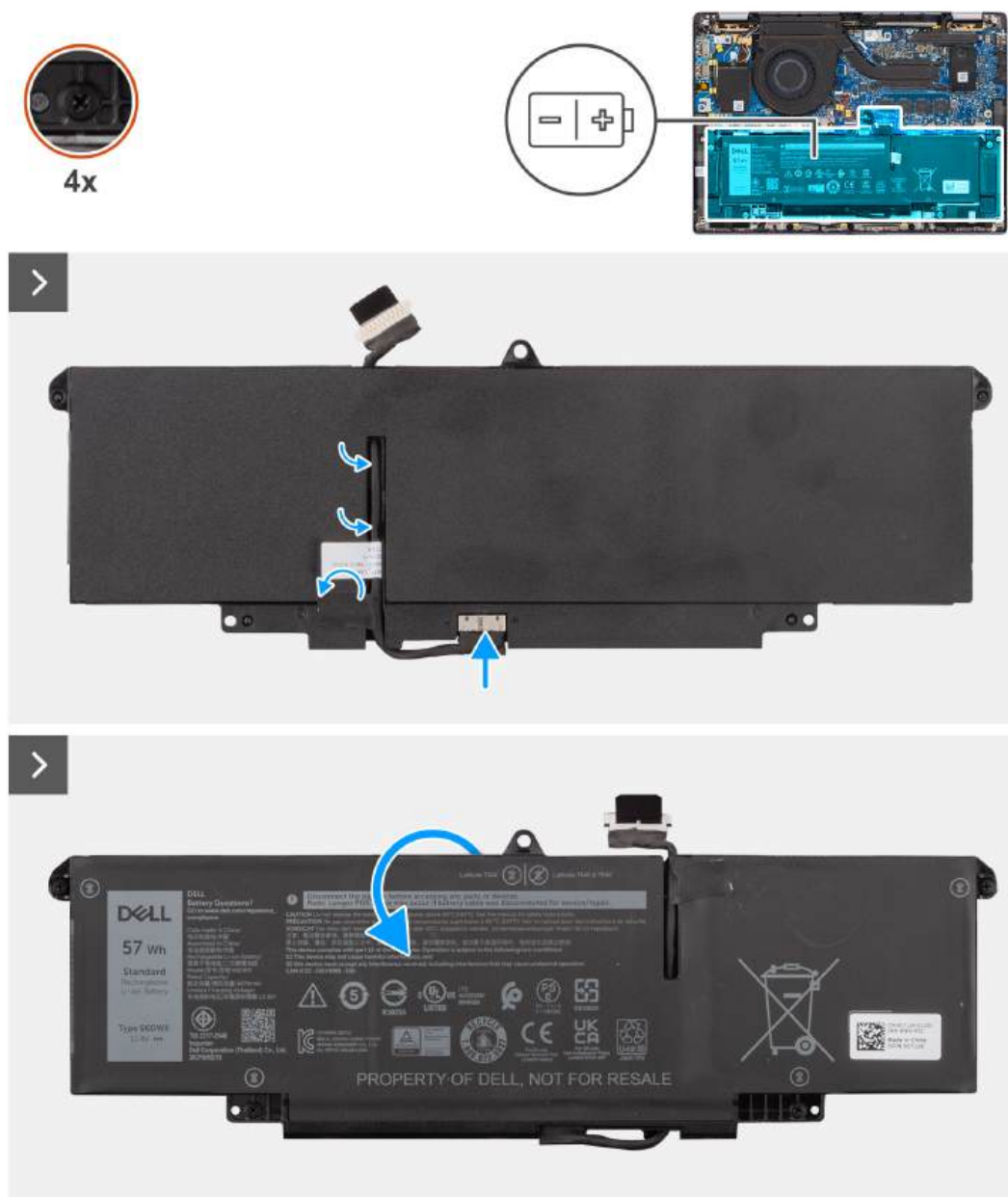
Rysunek 42. Instalowanie kabla baterii
