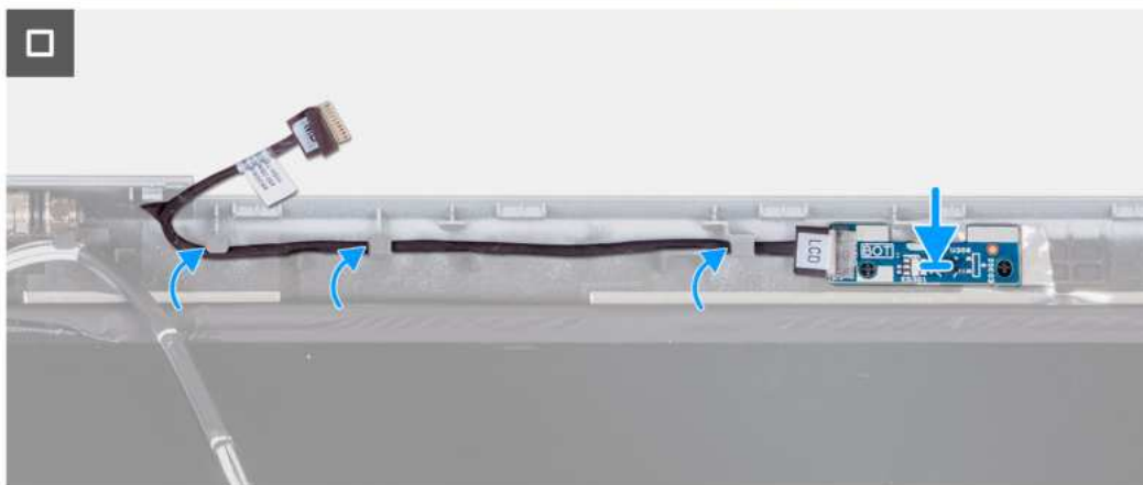
Rysunek 93. Instalowanie płyty czujników
