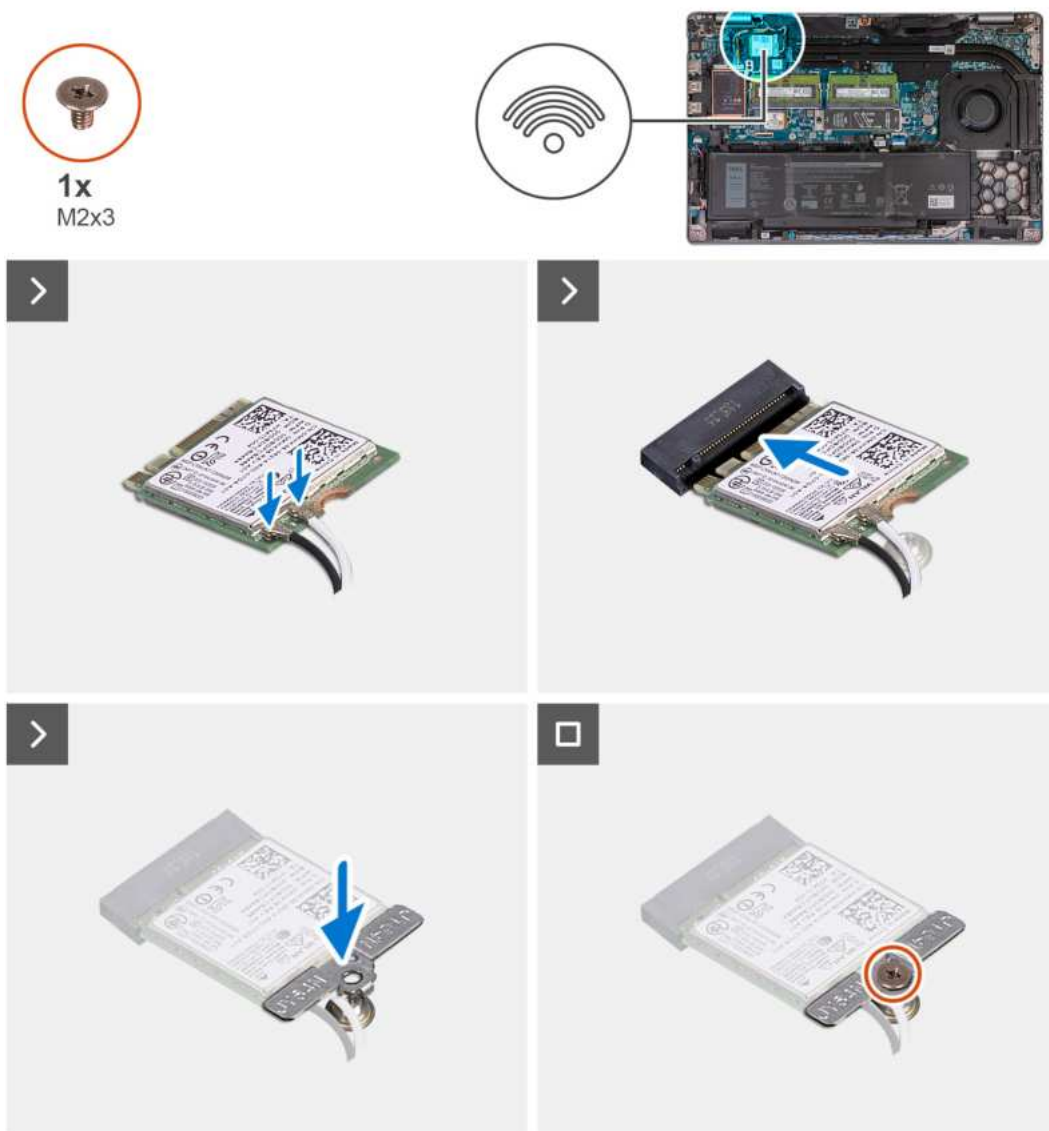
Rysunek 20. Instalowanie karty sieci bezprzewodowej
