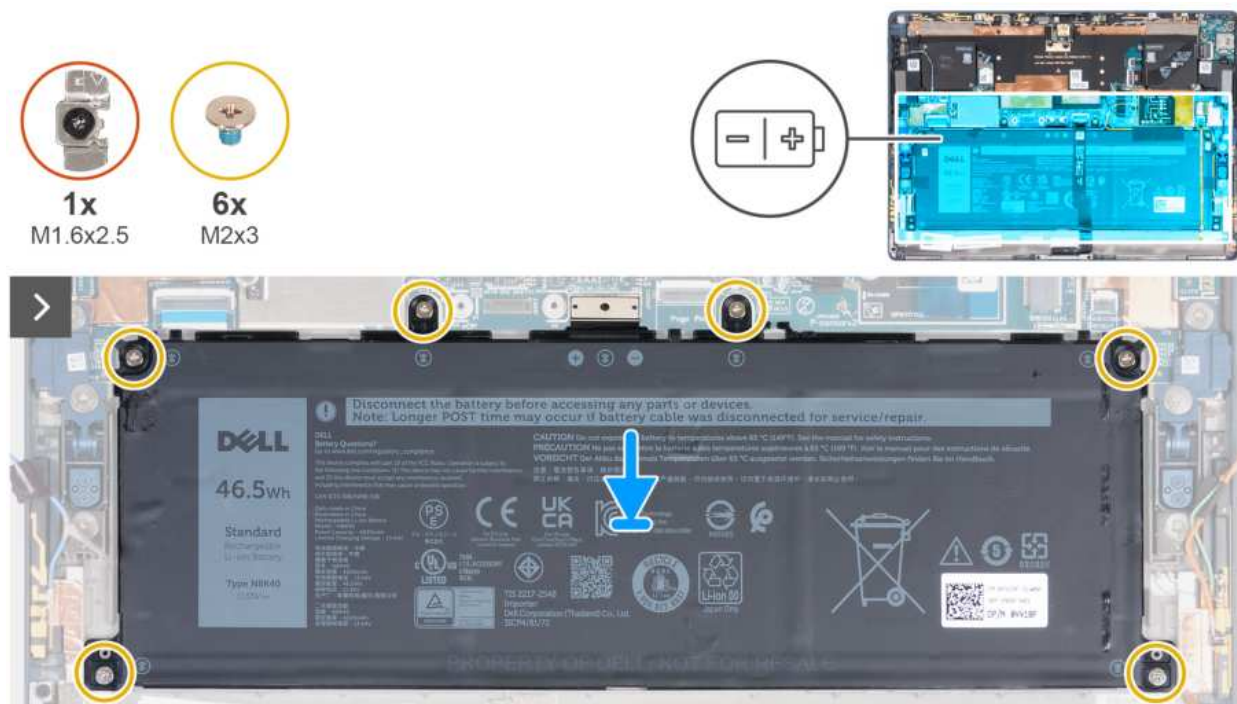
Rysunek 41. Instalowanie baterii
