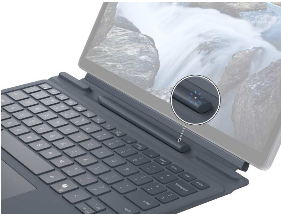
Rysunek 12. Ładowanie aktywnego pióra do komputera Latitude 7350 z odłączaną klawiaturą
