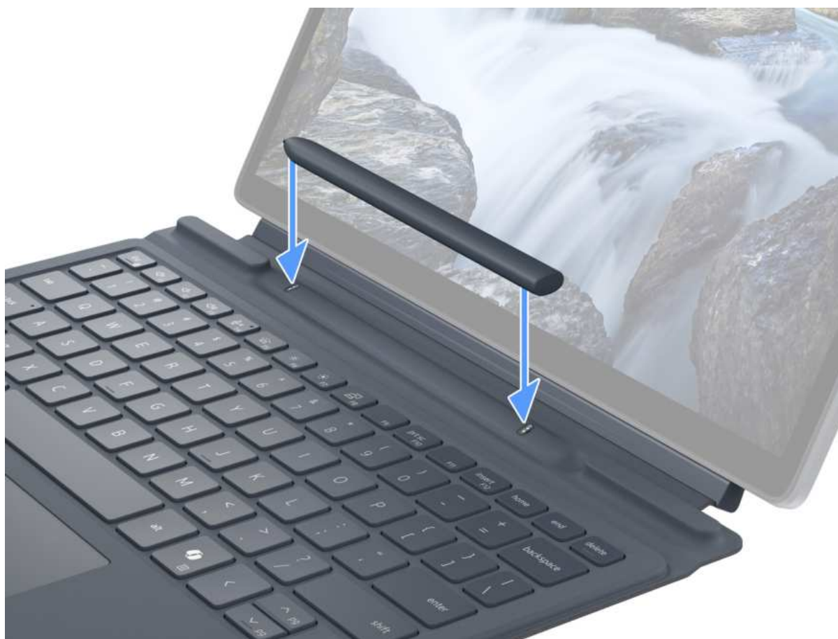
Rysunek 11. Dokowanie aktywnego pióra do komputera Latitude 7350 z odłączaną klawiaturą
