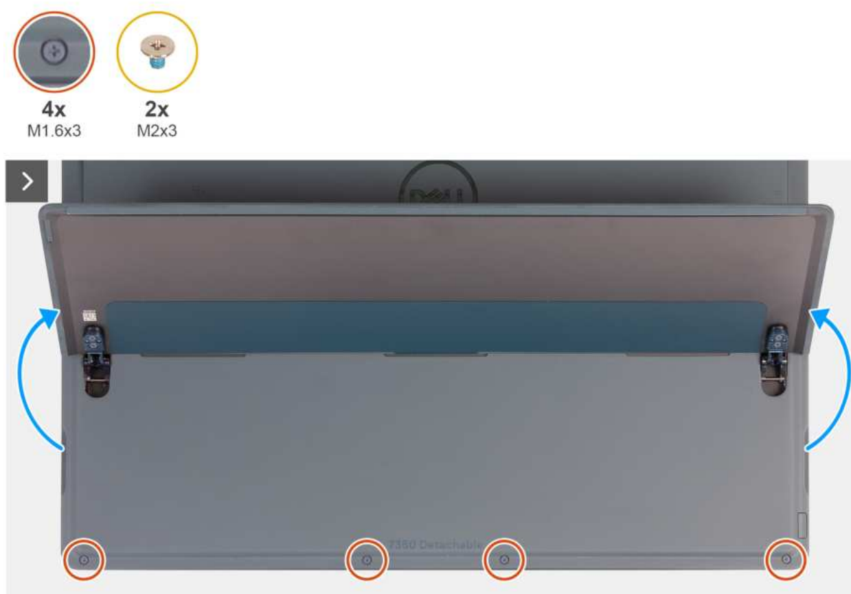
Rysunek 17. Wymontowywanie zestawu wyświetlacza
