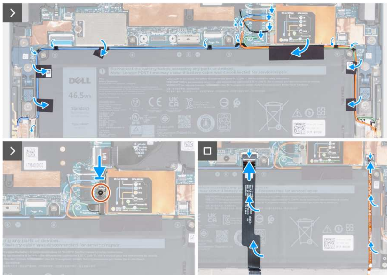
Rysunek 42. Instalowanie baterii
