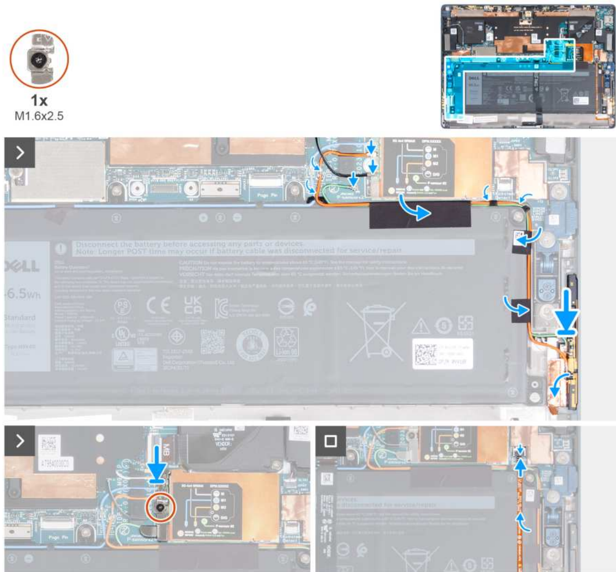
Rysunek 55. Instalowanie anteny MIMO3 sieci WWAN
