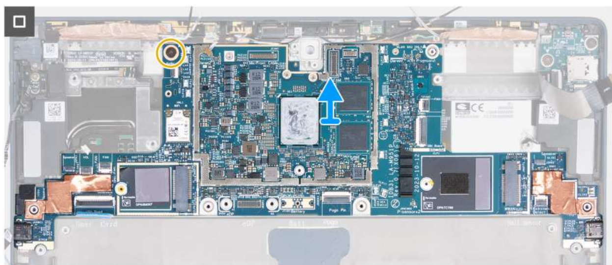
Rysunek 68. Wymontowywanie płyty głównej
