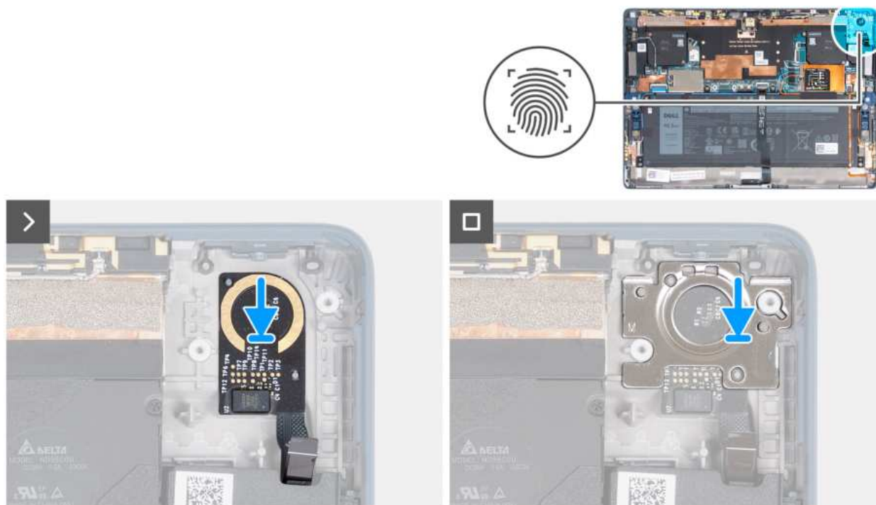
Rysunek 65. Instalowanie czytnika linii papilarnych
