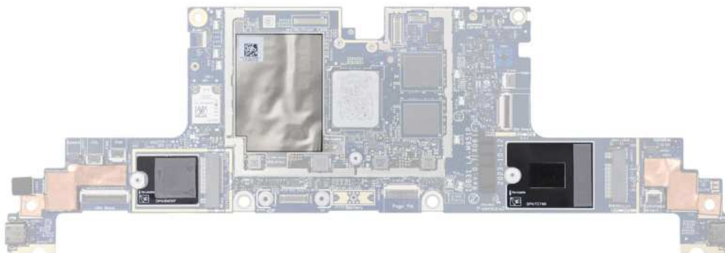
Rysunek 70. Od lewej do prawej: podkładka termoprzewodząca dysku SSD M.2, element pochłaniający karty sieci WWAN, podkładka termoprzewodząca karty sieci WWAN
