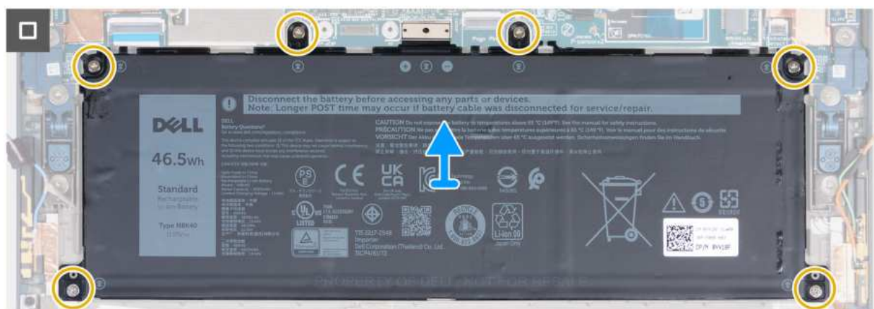
Rysunek 40. Wymontowywanie baterii
