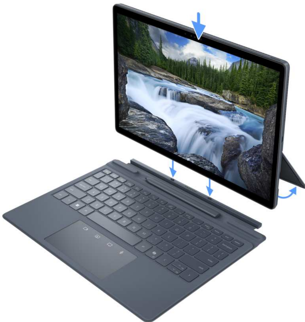
Rysunek 9. Podłączanie odłączanej klawiatury współpracy do komputera Latitude 7350
