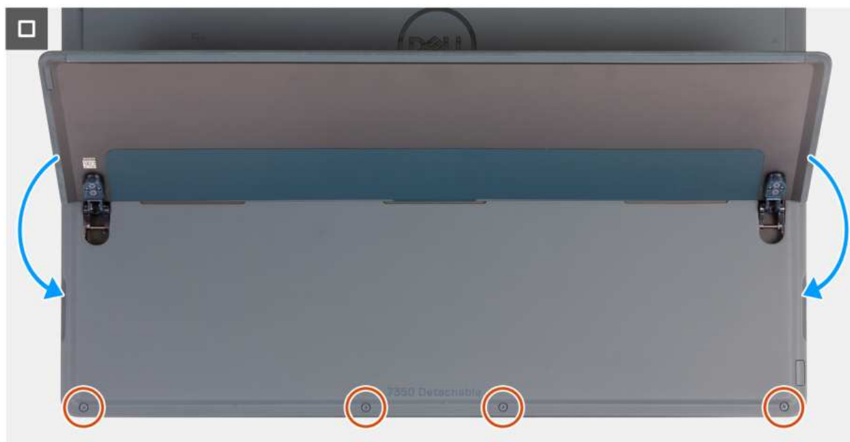
Rysunek 24. Instalowanie zestawu wyświetlacza
