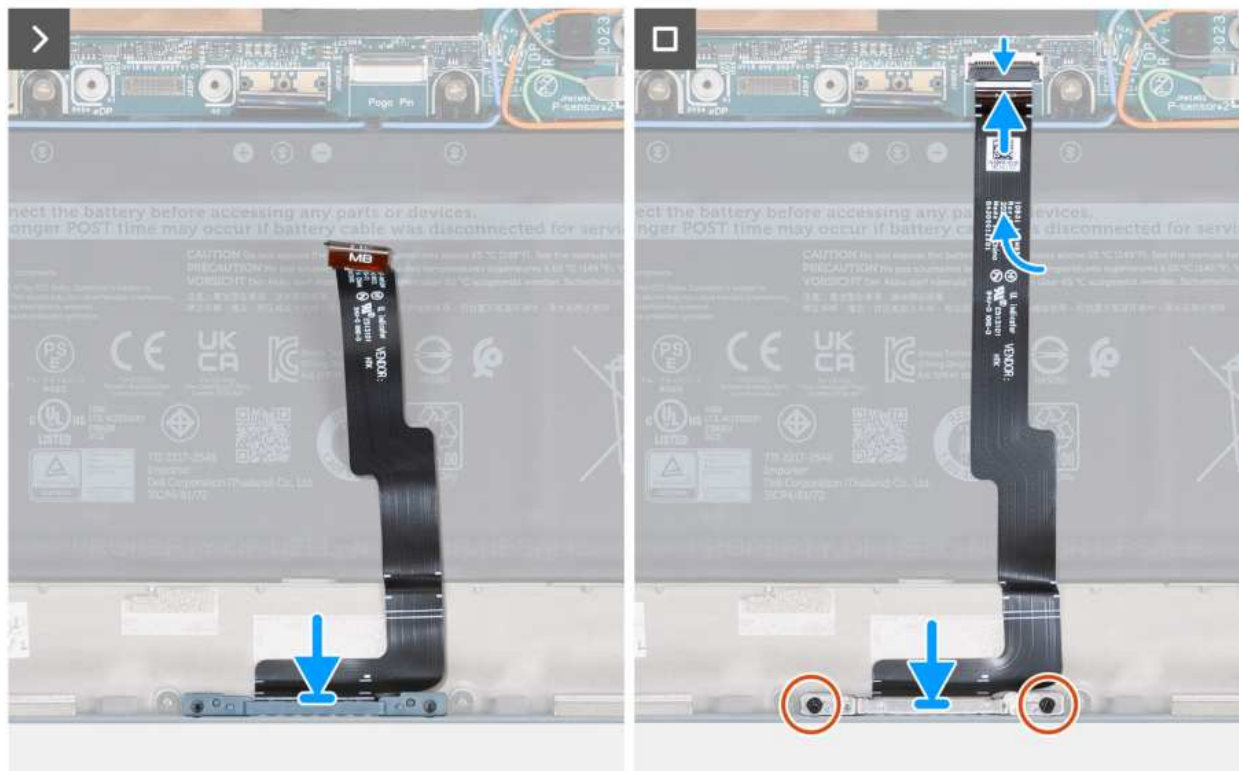
Rysunek 28. Instalowanie złącza stacji dokującej
