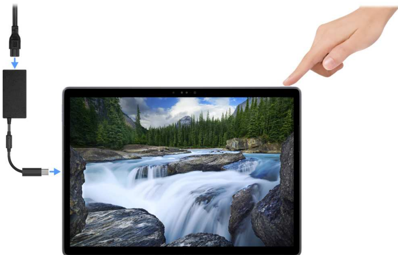
Rysunek 8. Podłącz zasilacz i naciśnij przycisk zasilania
