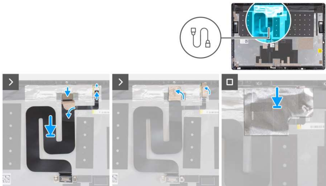
Rysunek 26. Instalowanie kabla wyświetlacza
