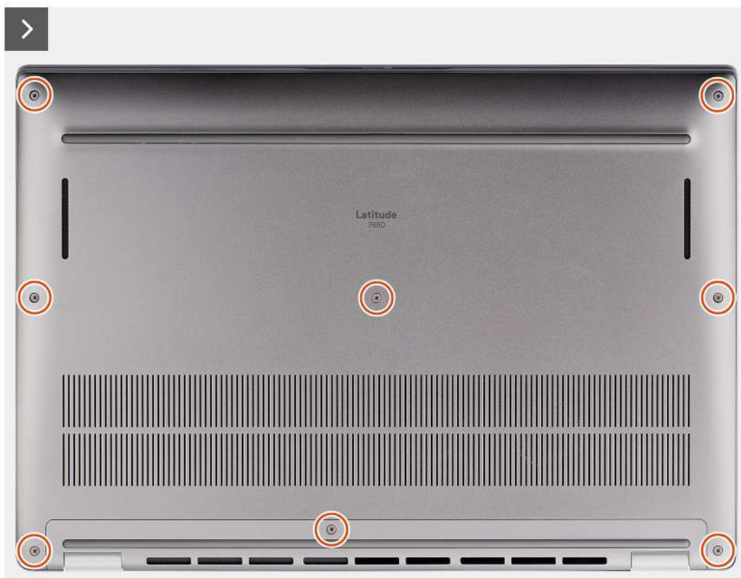
Rysunek 11. Wymontowywanie pokrywy dolnej
