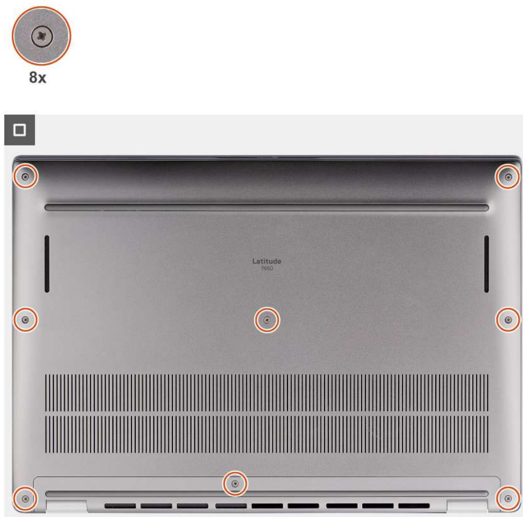
Rysunek 14. Instalowanie pokrywy dolnej
