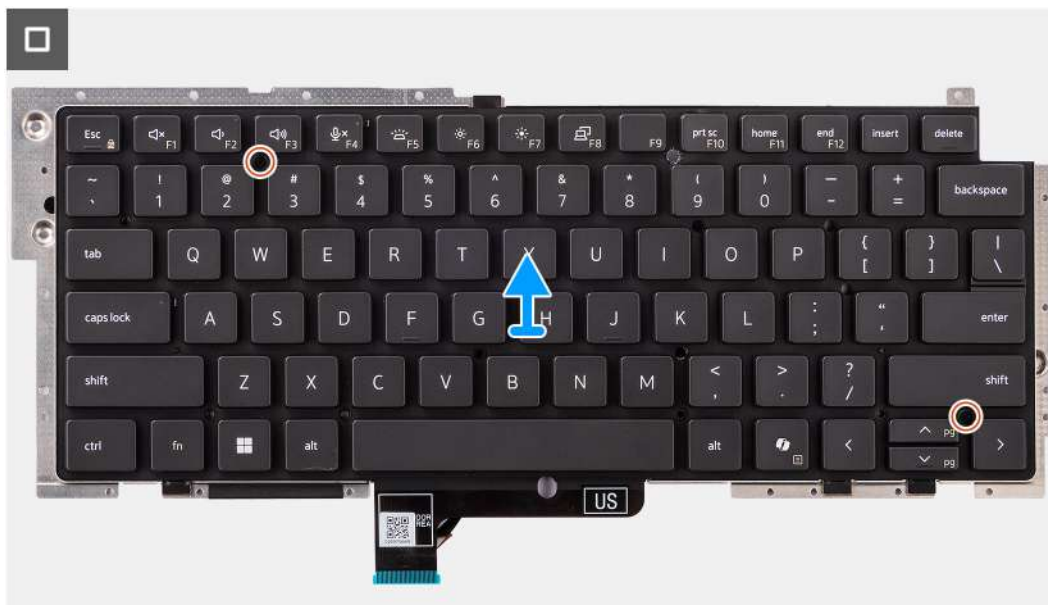
Rysunek 65. Wymontowywanie klawiatury
