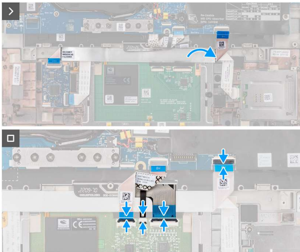
Rysunek 45. Instalowanie czytnika kart smart
