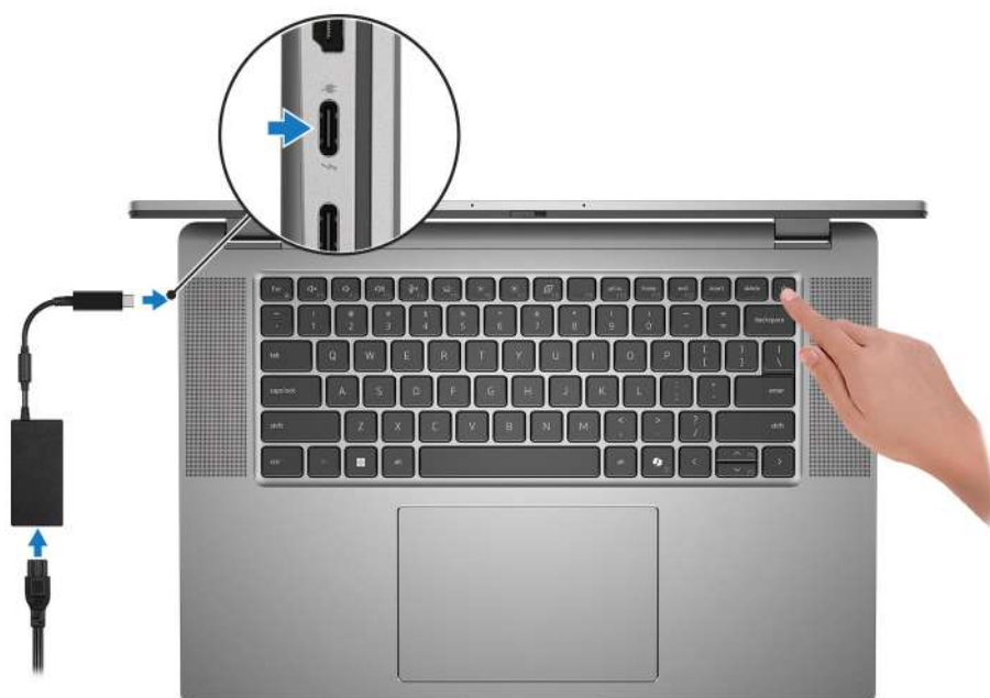
Rysunek 7. Podłącz zasilacz i naciśnij przycisk zasilania
