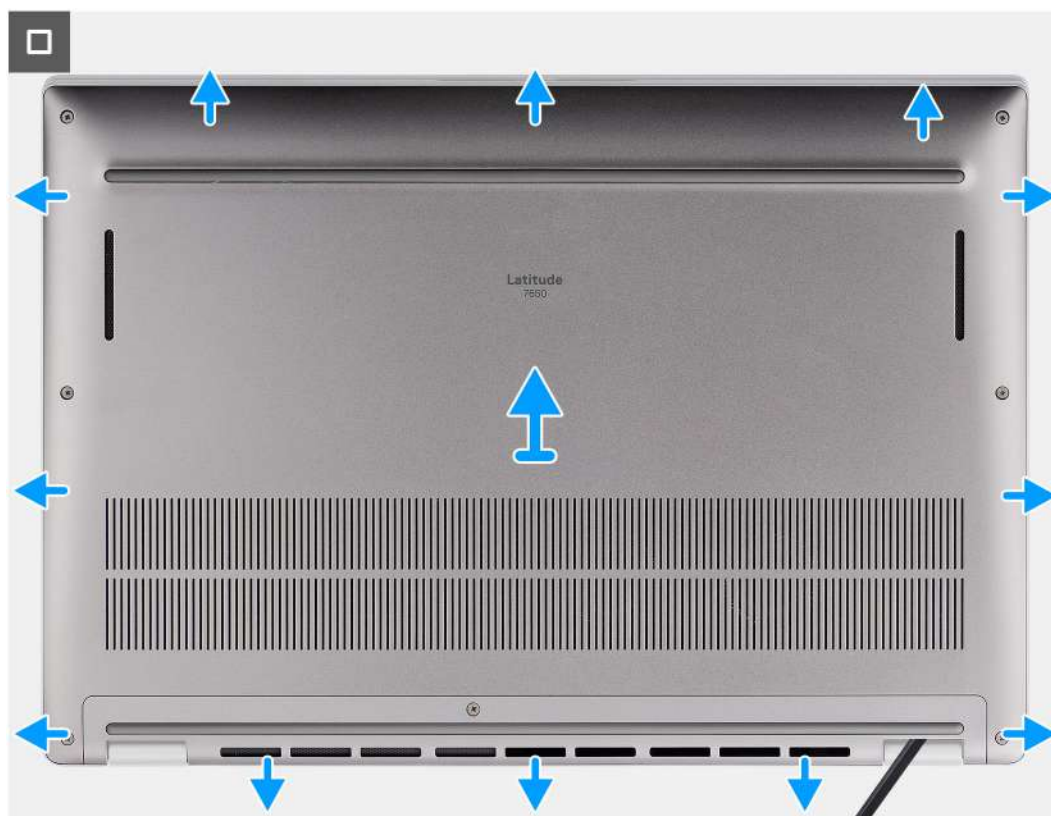
Rysunek 12. Wymontowywanie pokrywy dolnej
