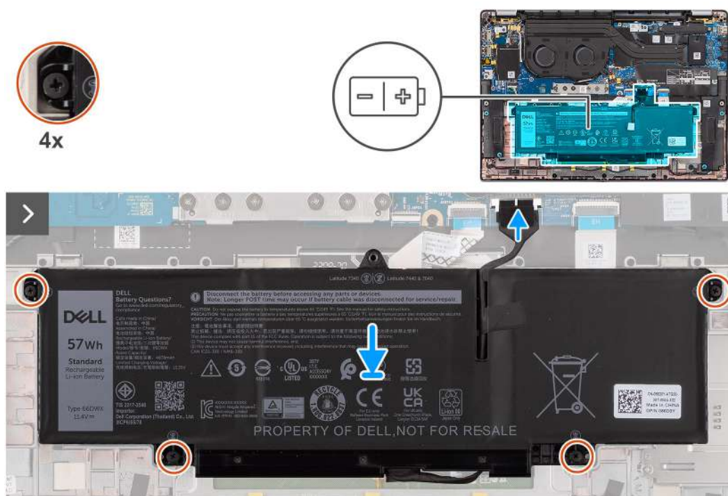
Rysunek 30. Instalowanie baterii 3-ogniowej
