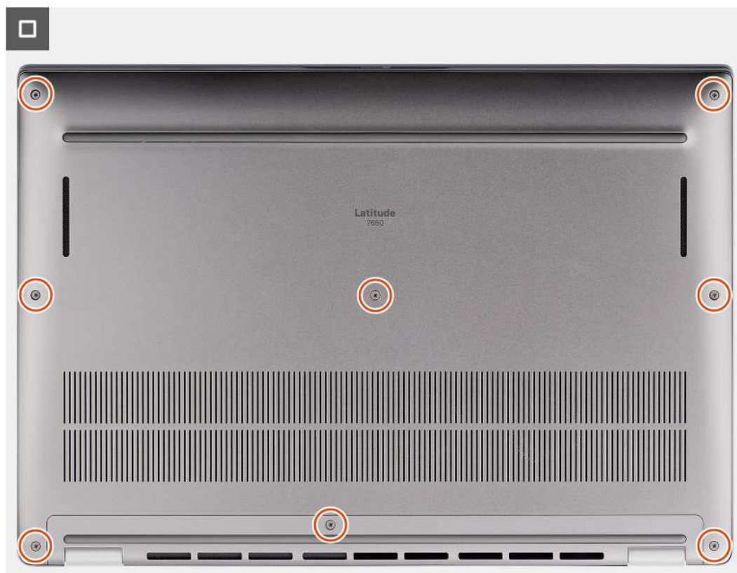
Rysunek 13. Instalowanie pokrywy dolnej
