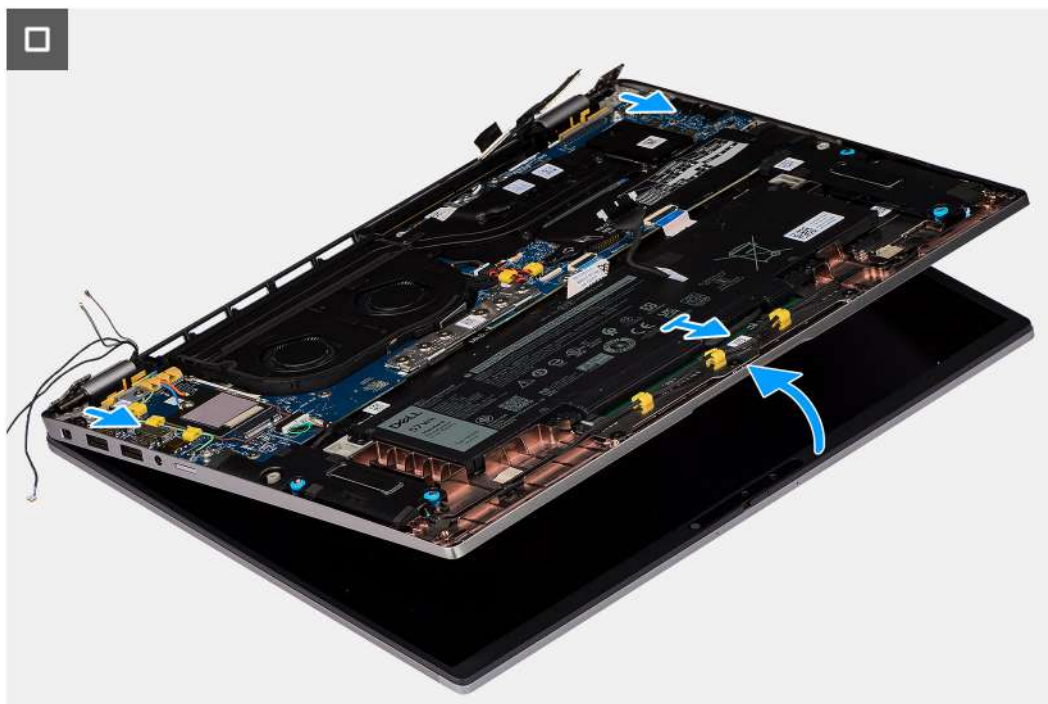
Rysunek 37. Wymontowywanie zestawu wyświetlacza
