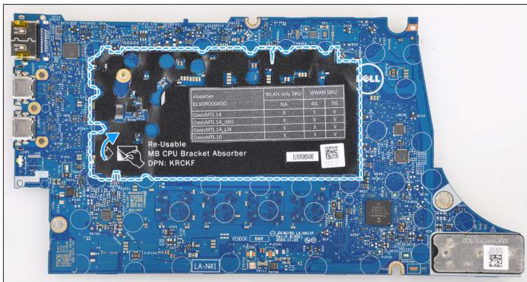
Rysunek 51. Element pochłaniający klamry procesora
