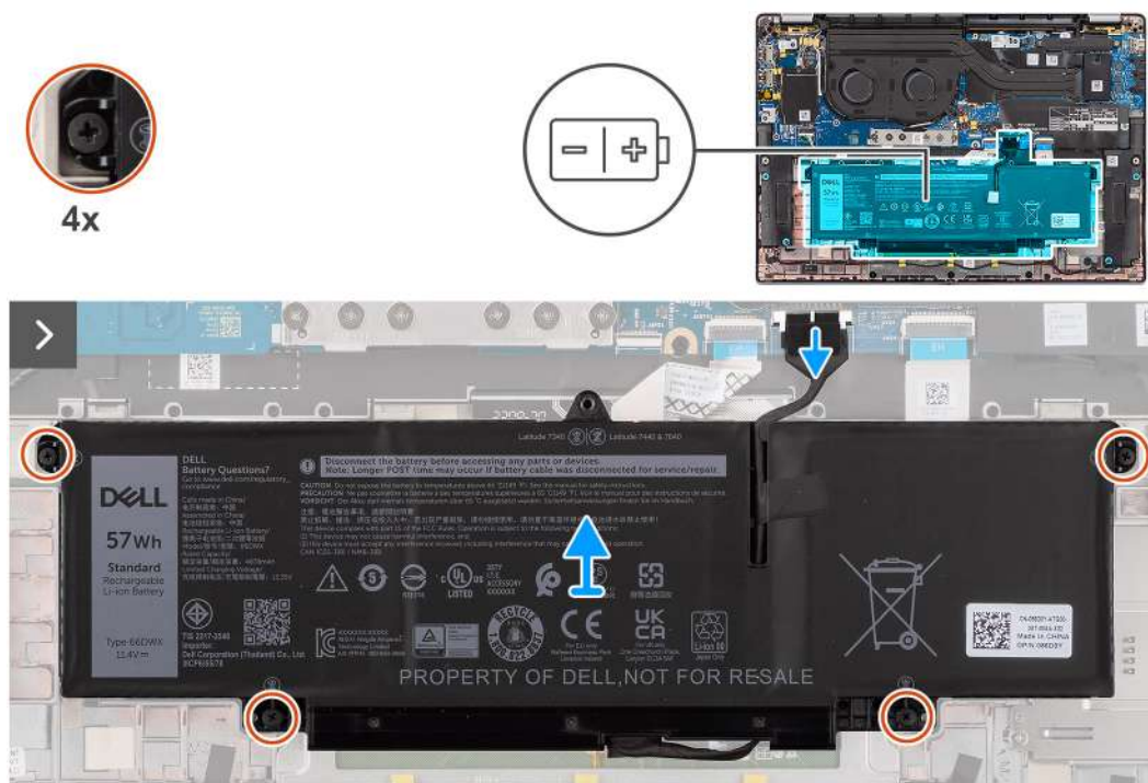
Rysunek 29. Wymontowywanie baterii 3-ogniowej
