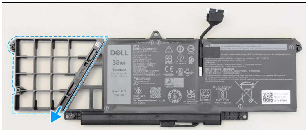
Rysunek 27. Wymontowywanie baterii 2-ogniowej
