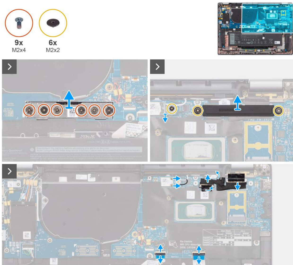
Rysunek 47. Wymontowywanie płyty głównej w konfiguracji z kartą sieci WWAN
