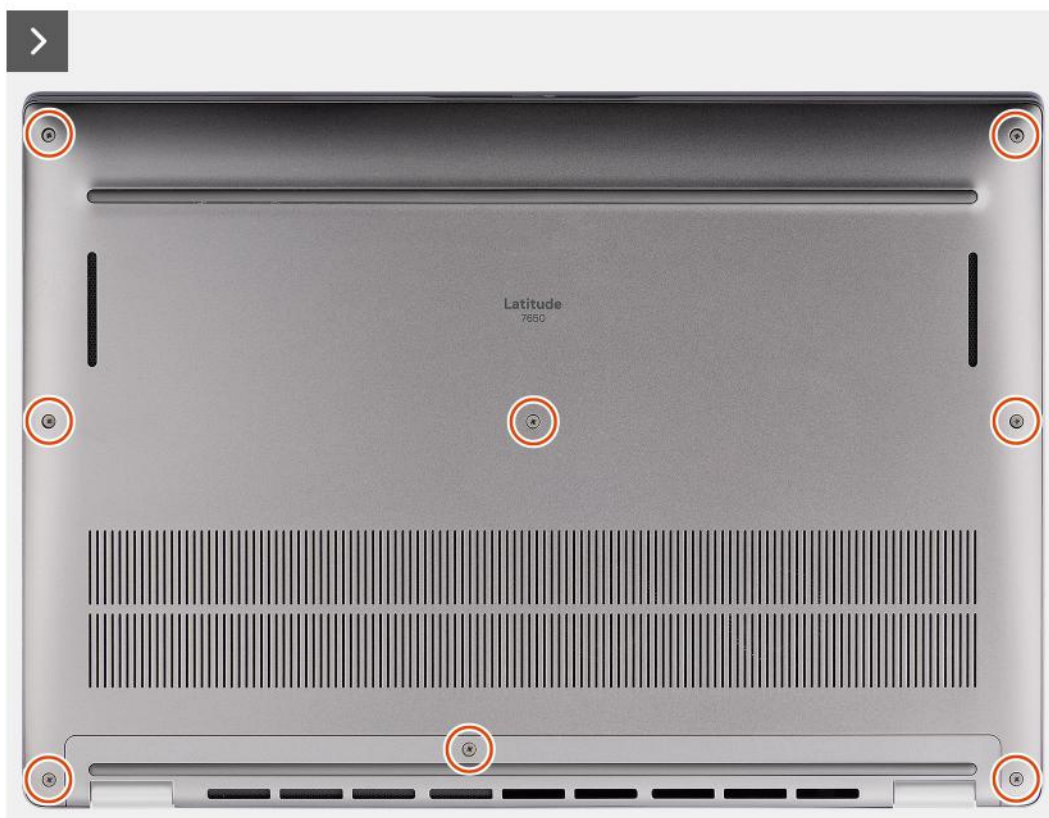
Rysunek 11. Wymontowywanie pokrywy dolnej
