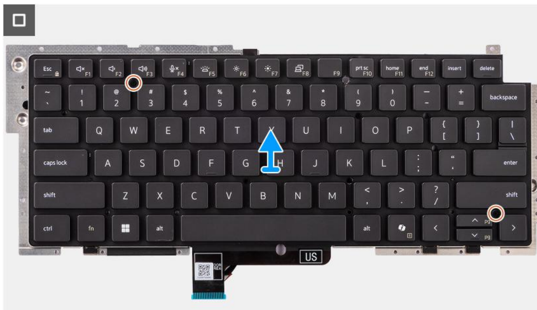
Rysunek 65. Wymontowywanie klawiatury
