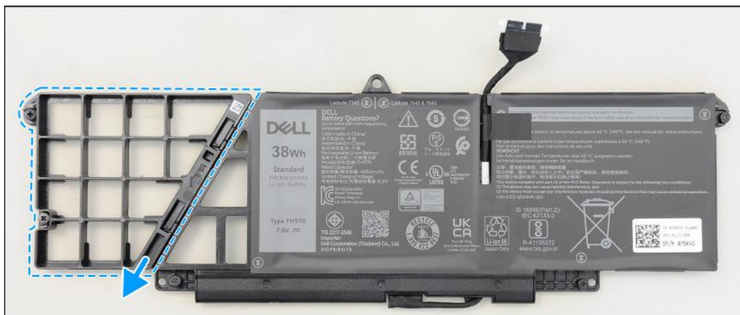
Rysunek 27. Wymontowywanie baterii 2-ogniowej
