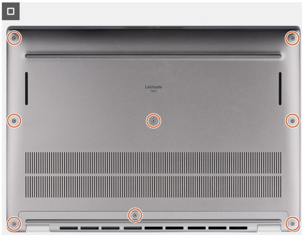
Rysunek 13. Instalowanie pokrywy dolnej
