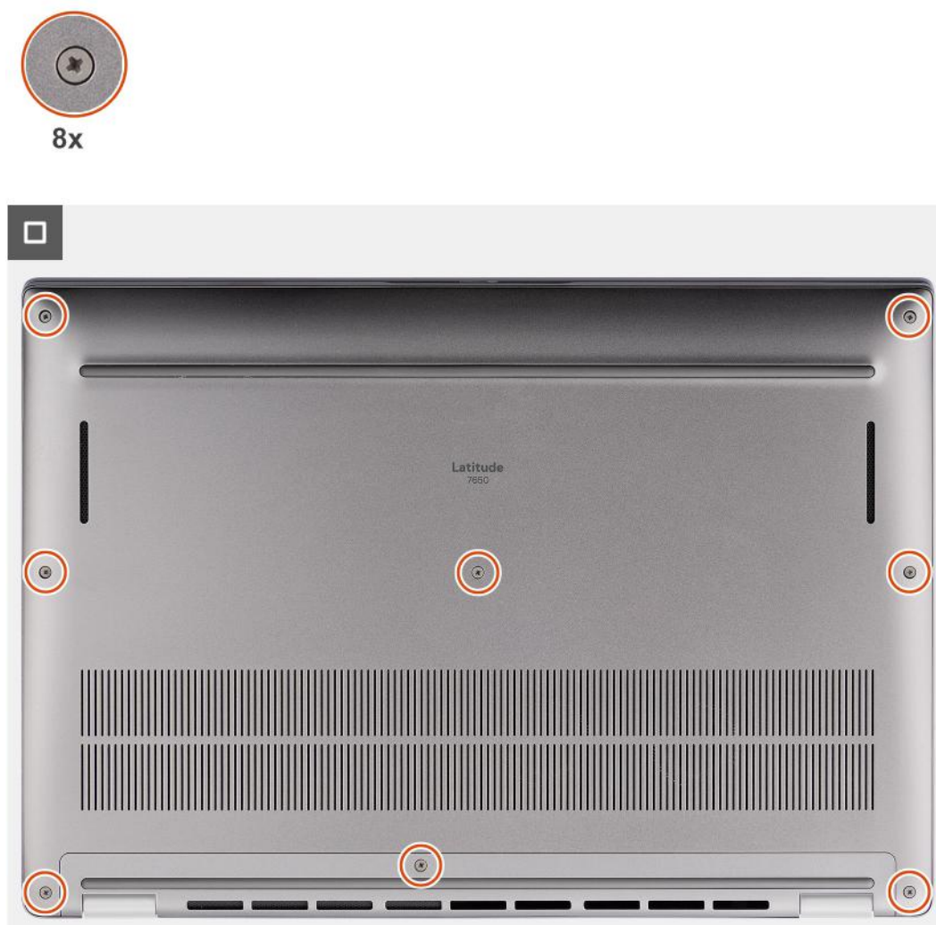
Rysunek 14. Instalowanie pokrywy dolnej
