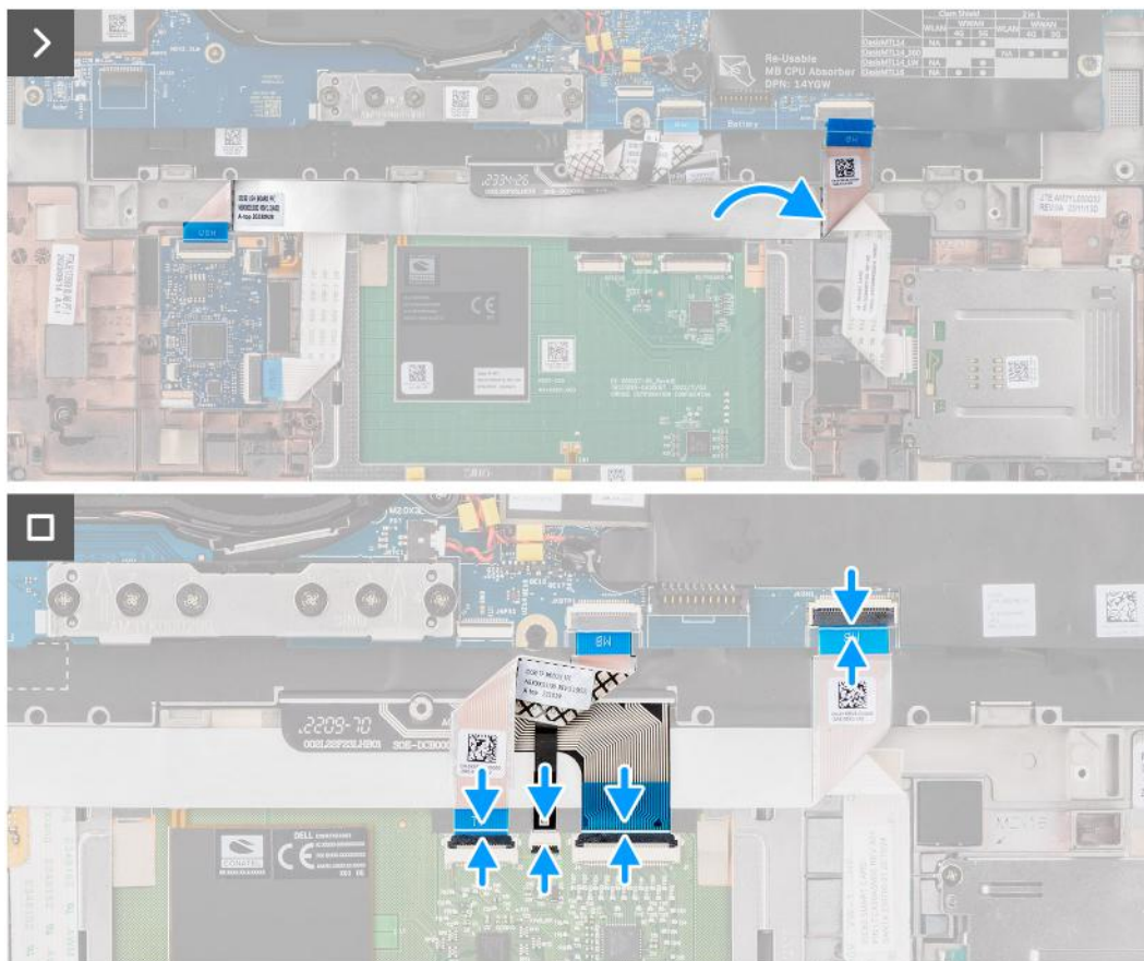
Rysunek 45. Instalowanie czytnika kart smart
