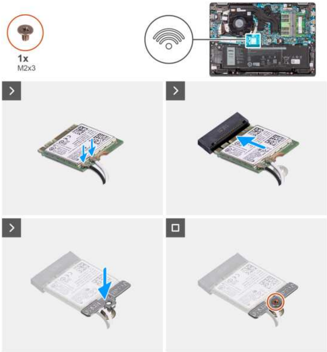
Rysunek 16. Instalowanie karty sieci bezprzewodowej
