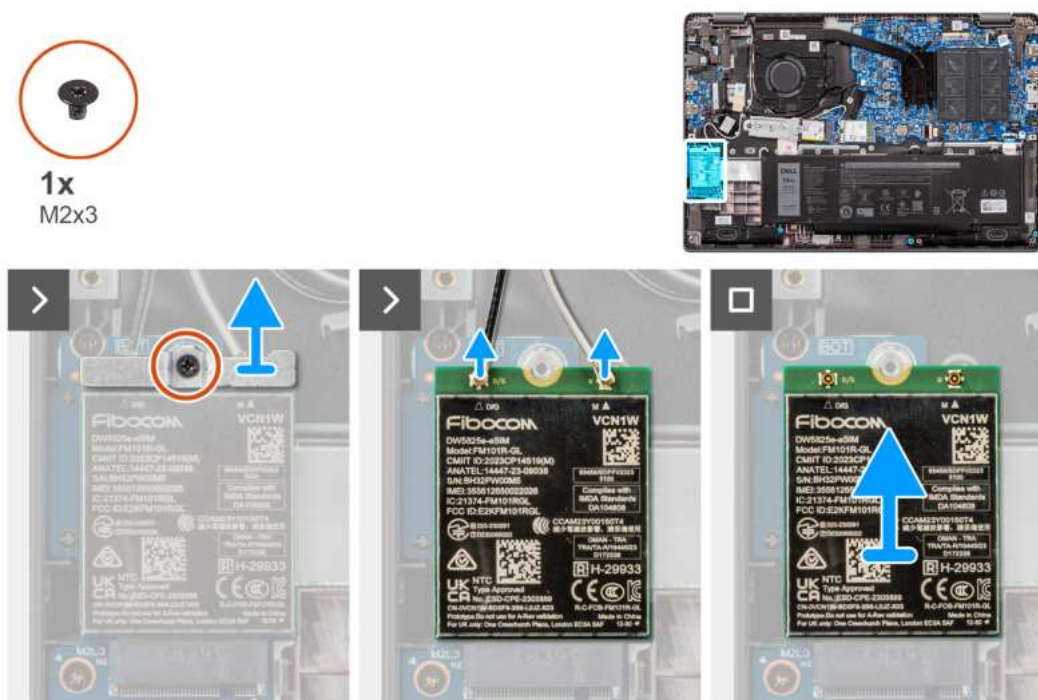
Rysunek 16. Wymontowywanie karty sieci WWAN
