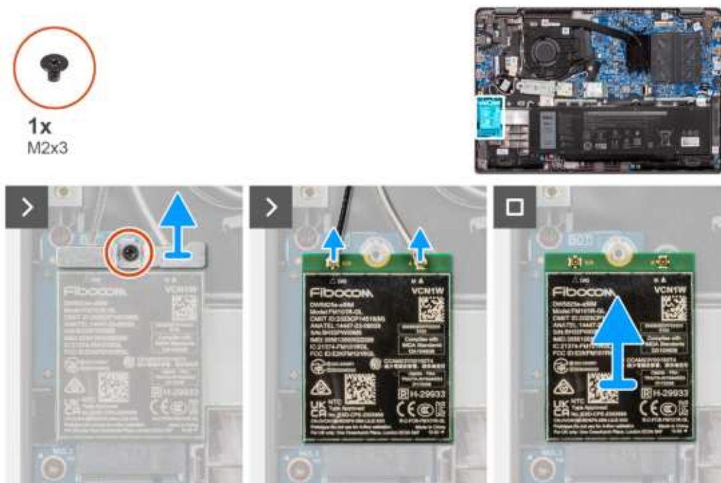
Rysunek 16. Wymontowywanie karty sieci WWAN
