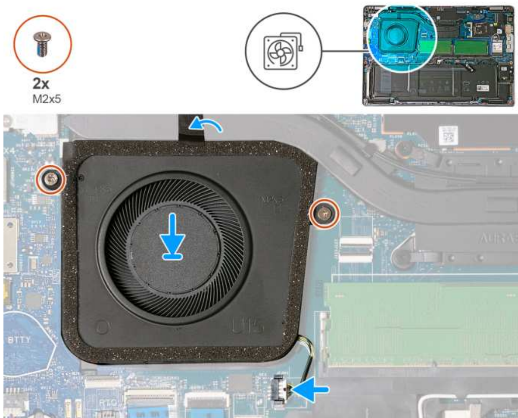
Rysunek 25. Instalowanie wentylatora
