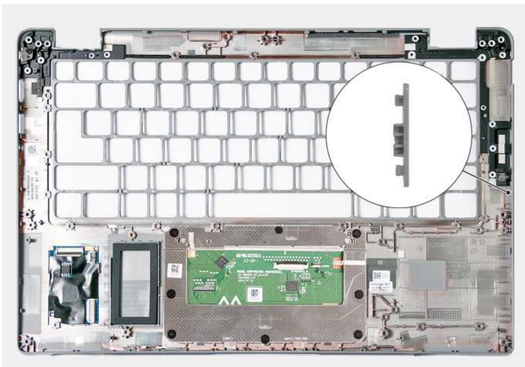
Rysunek 84. Instalowanie zestawu podpórki na nadgarstek
