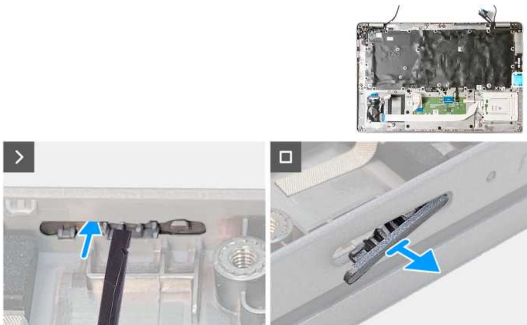
Rysunek 85. Wymontowywanie zaślepki gniazda karty SIM
