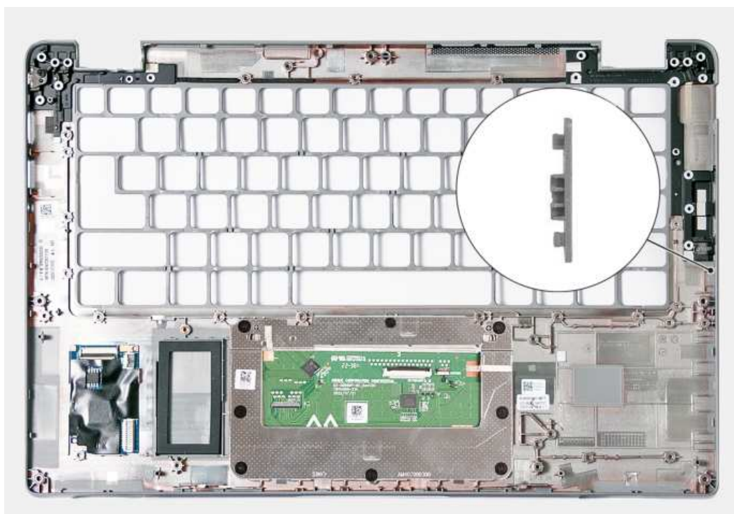
Rysunek 83. Wymontowywanie zestawu podpórki na nadgarstek
