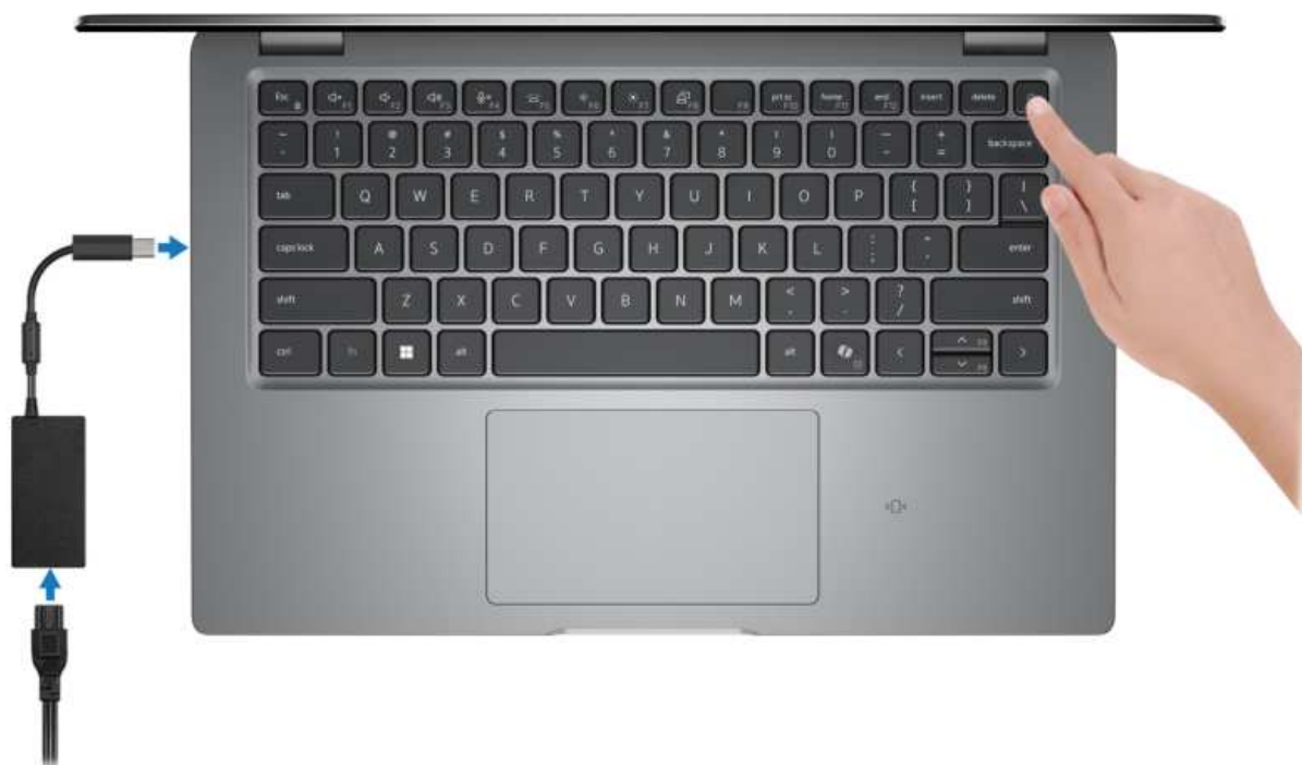
Rysunek 1. Podłącz zasilacz i naciśnij przycisk zasilania.
