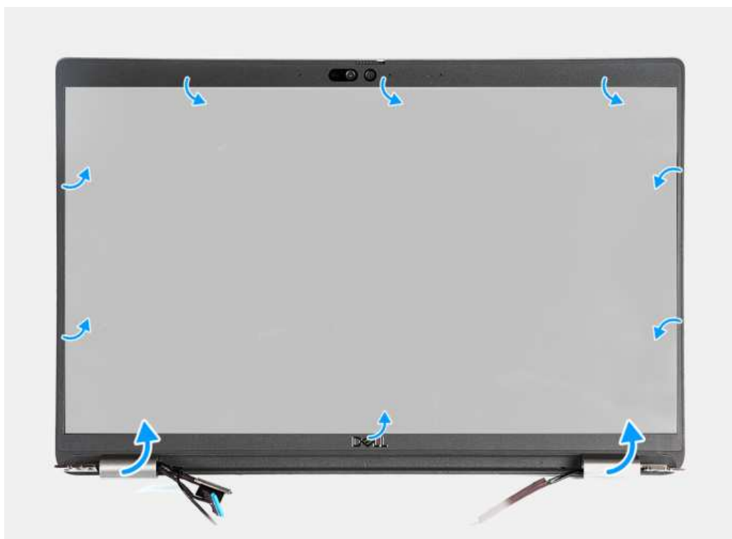
Rysunek 53. Wymontowywanie ramki wyświetlacza
