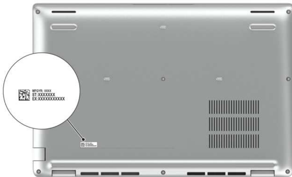
Rysunek 7. Umieszczenie kodu Service Tag
